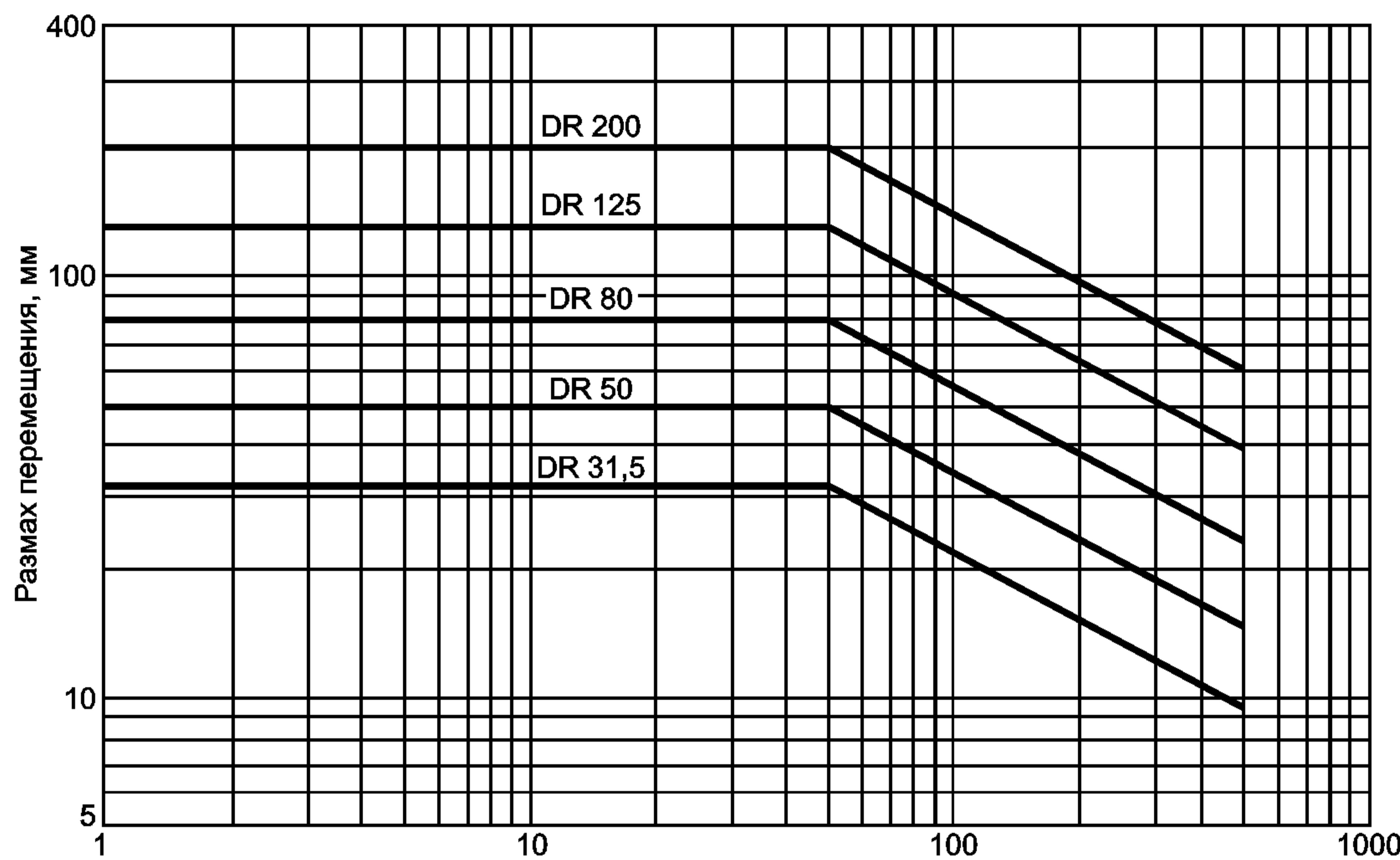
Рисунок 1 — Кривые классов вибрации для вибрации вала
