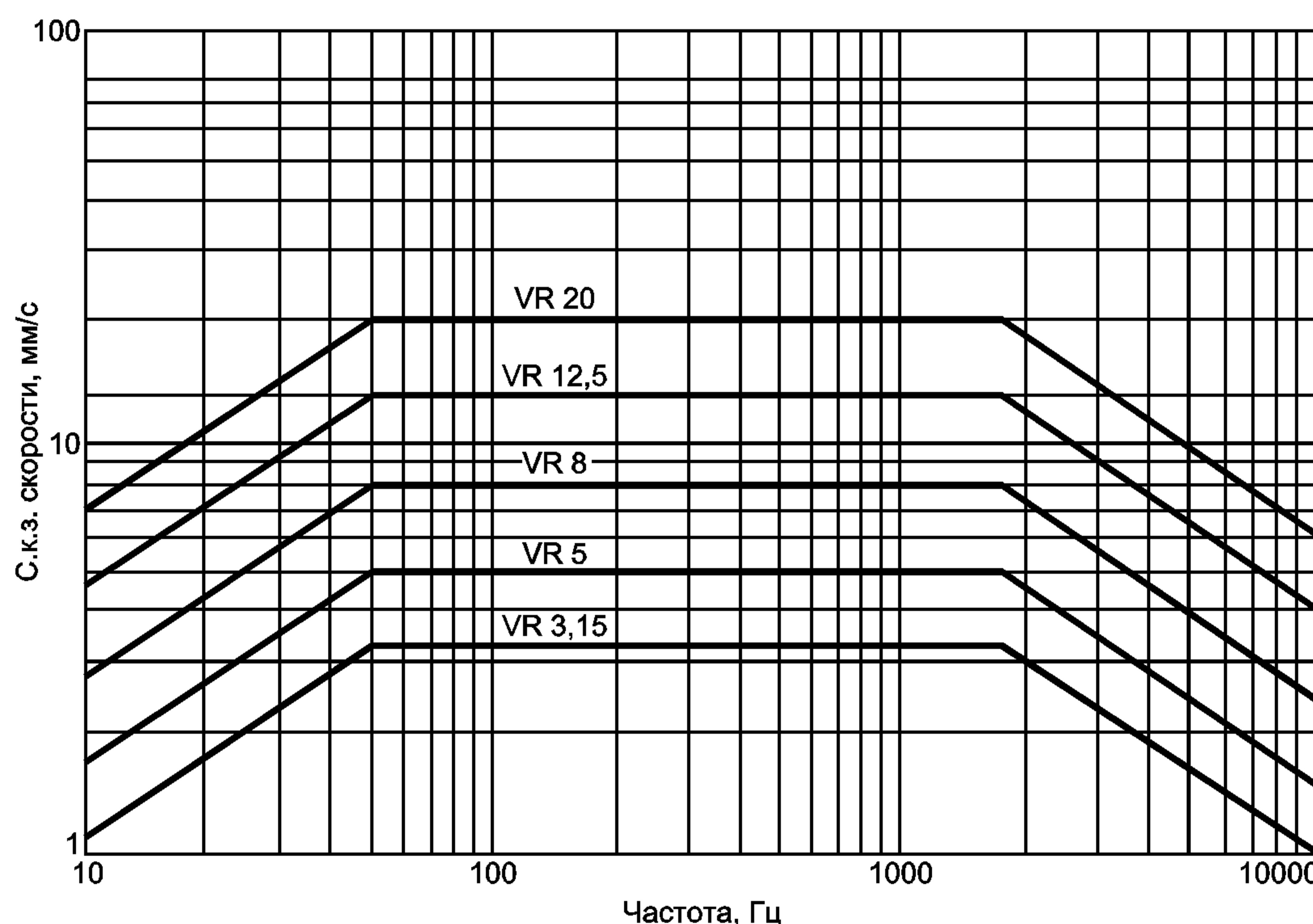
Рисунок 2 — Кривые классов вибрации для вибрации корпуса
