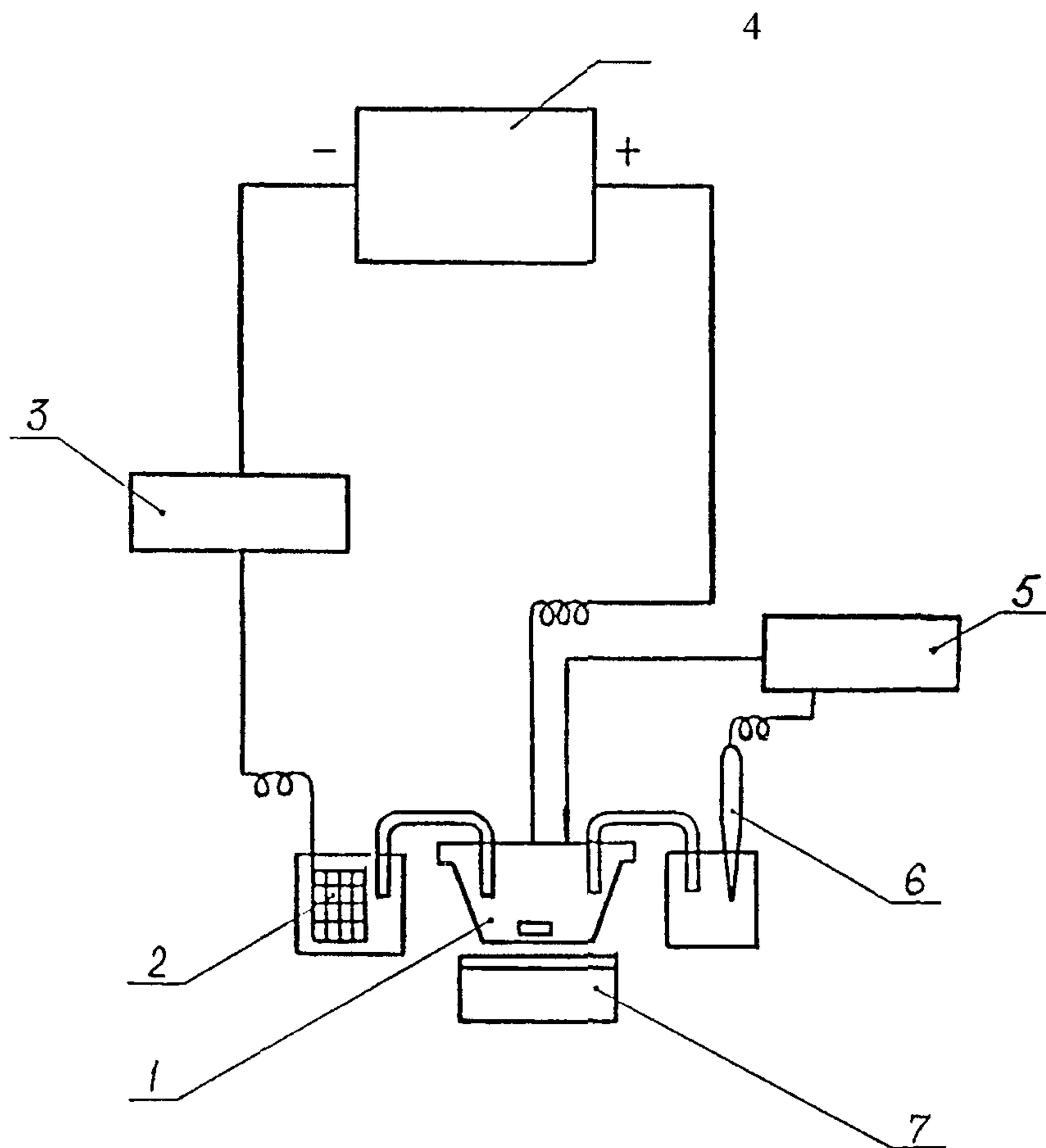
1 - рабочий электрод (тигель из стеклоуглерода); 2 – вспомогательный электрод (платиновая сетка); 3 - миллиамперметр; 4 -источник постоянного тока; 5 - вольтметр; 6 - электрод сравнения; 7 – магнитная мешалка.
