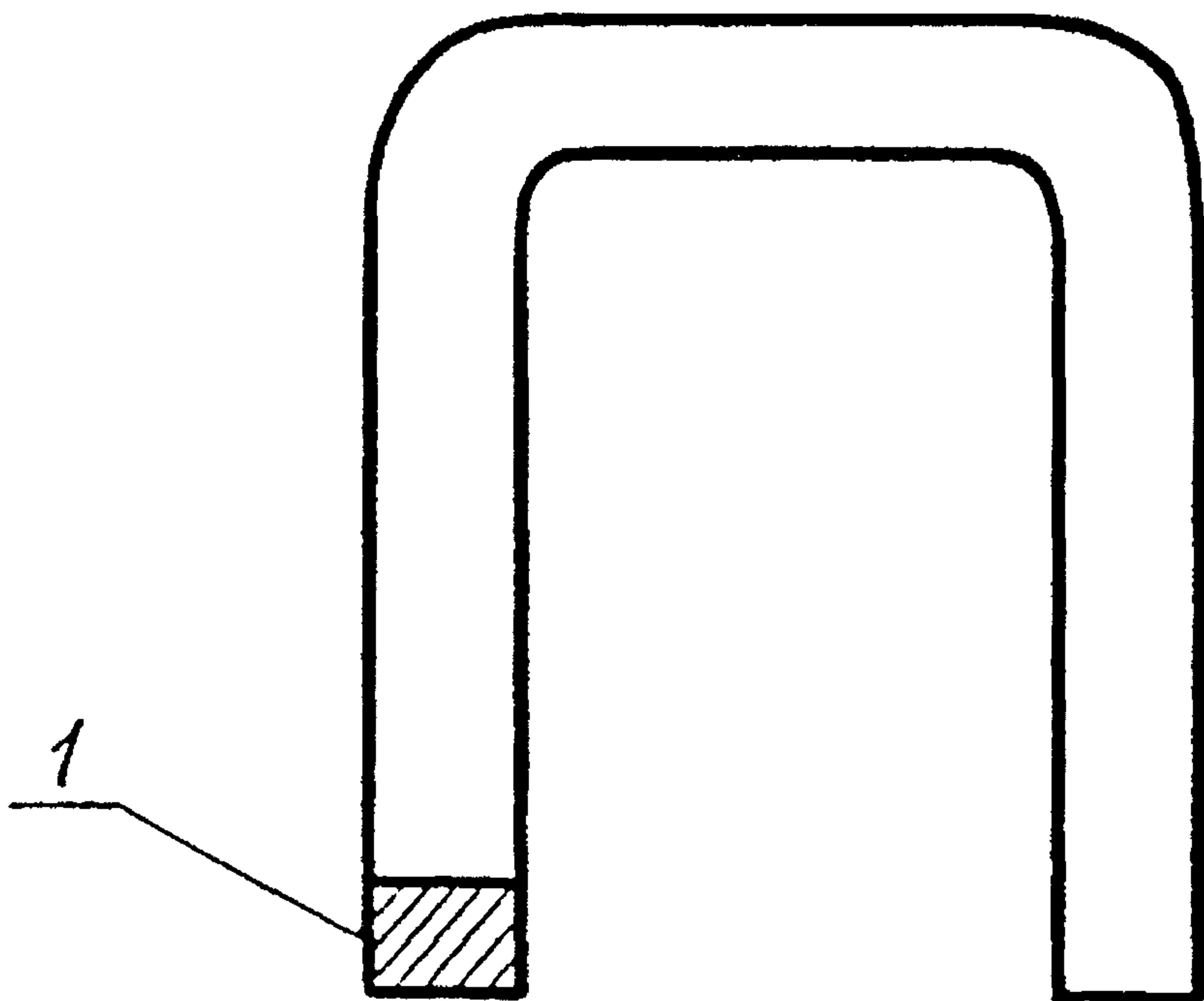
1 - пористый фильтр (высота 5-6 мм, диаметр - 10 мм)
