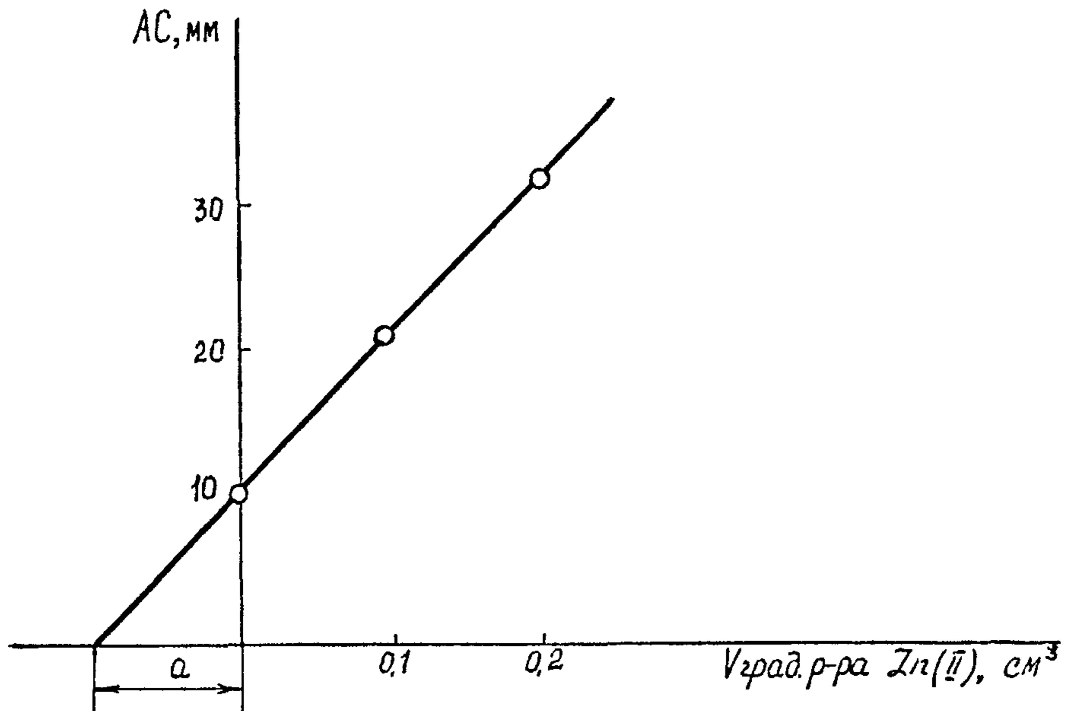
Рисунок 4 - Зависимость аналитического сигнала от объема введенного в электролизер градуировочного раствора Zn (II)
