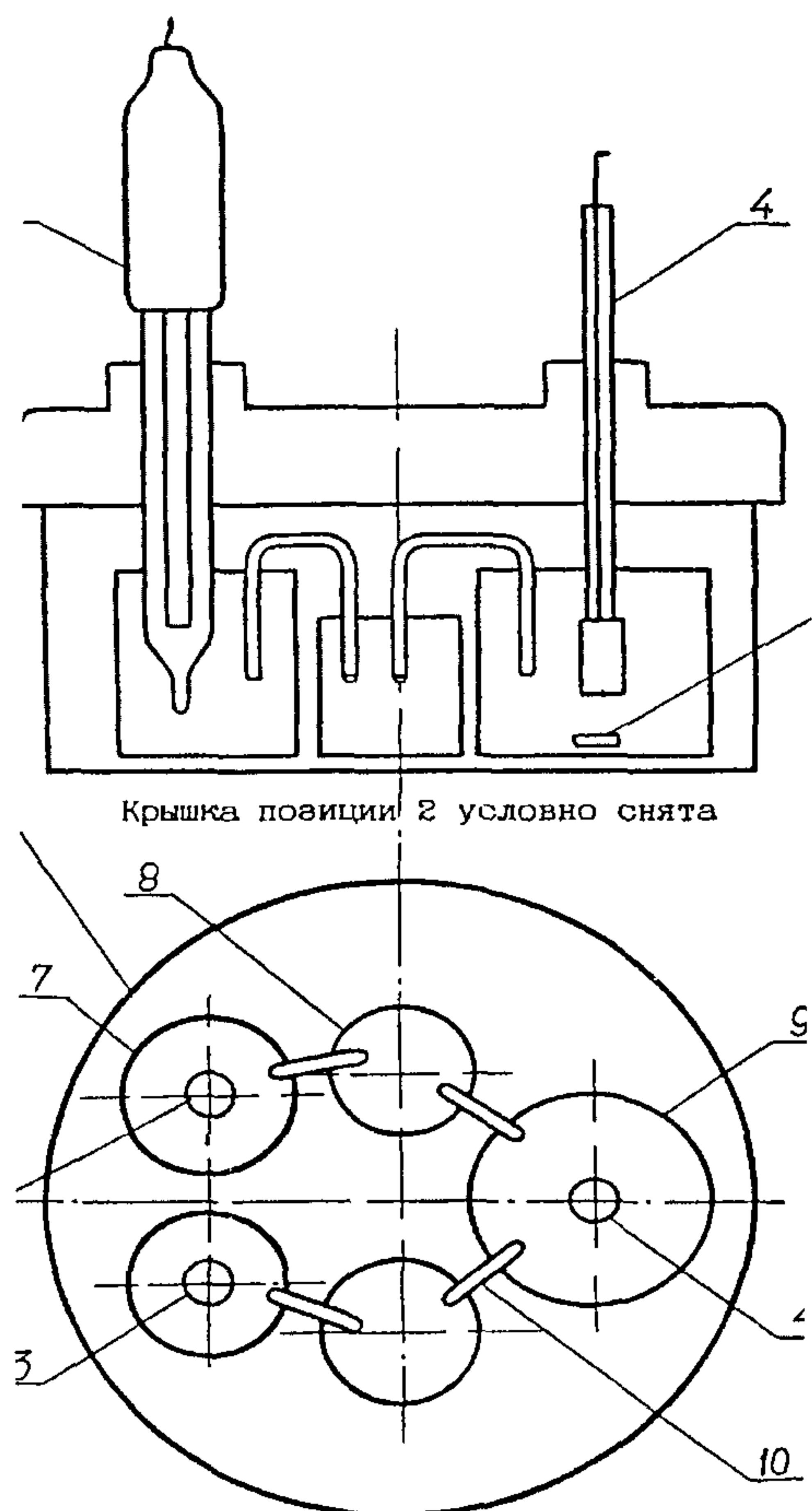
1 - стакан  $\varnothing 85$ ; 2 - крышка; 3 - электрод сравнения ЭВЛ-1М3;
