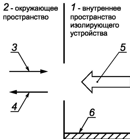
3 — вход; 4 — выход; 5 — направление воздушного потока; 6 — рабочая поверхность контролируемой рабочей зоны
