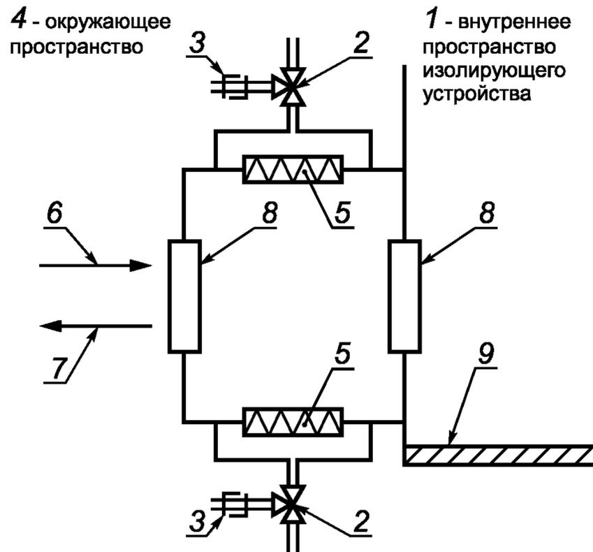
2 — трехходовой вентиль; 3 — быстродействующая соединительная муфта; 5 — HEPA фильтр; 6 — вход; 7 — выход; 8 — герметичная дверь; 9 — рабочая поверхность контролируемой рабочей зоны
