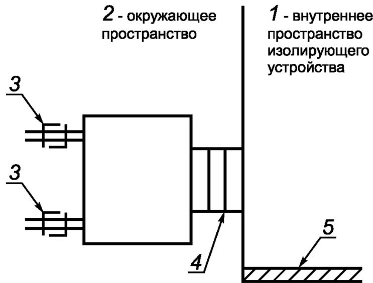
3 — быстродействующая соединительная муфта; 4 — двойные заблокированные двери или клапаны; 5 — рабочая поверхность контролируемой рабочей зоны
