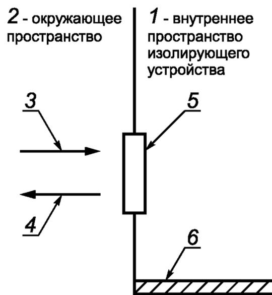
3 — вход; 4 — выход; 5 — герметичная дверь; 6 — рабочая поверхность контролируемой рабочей зоны
