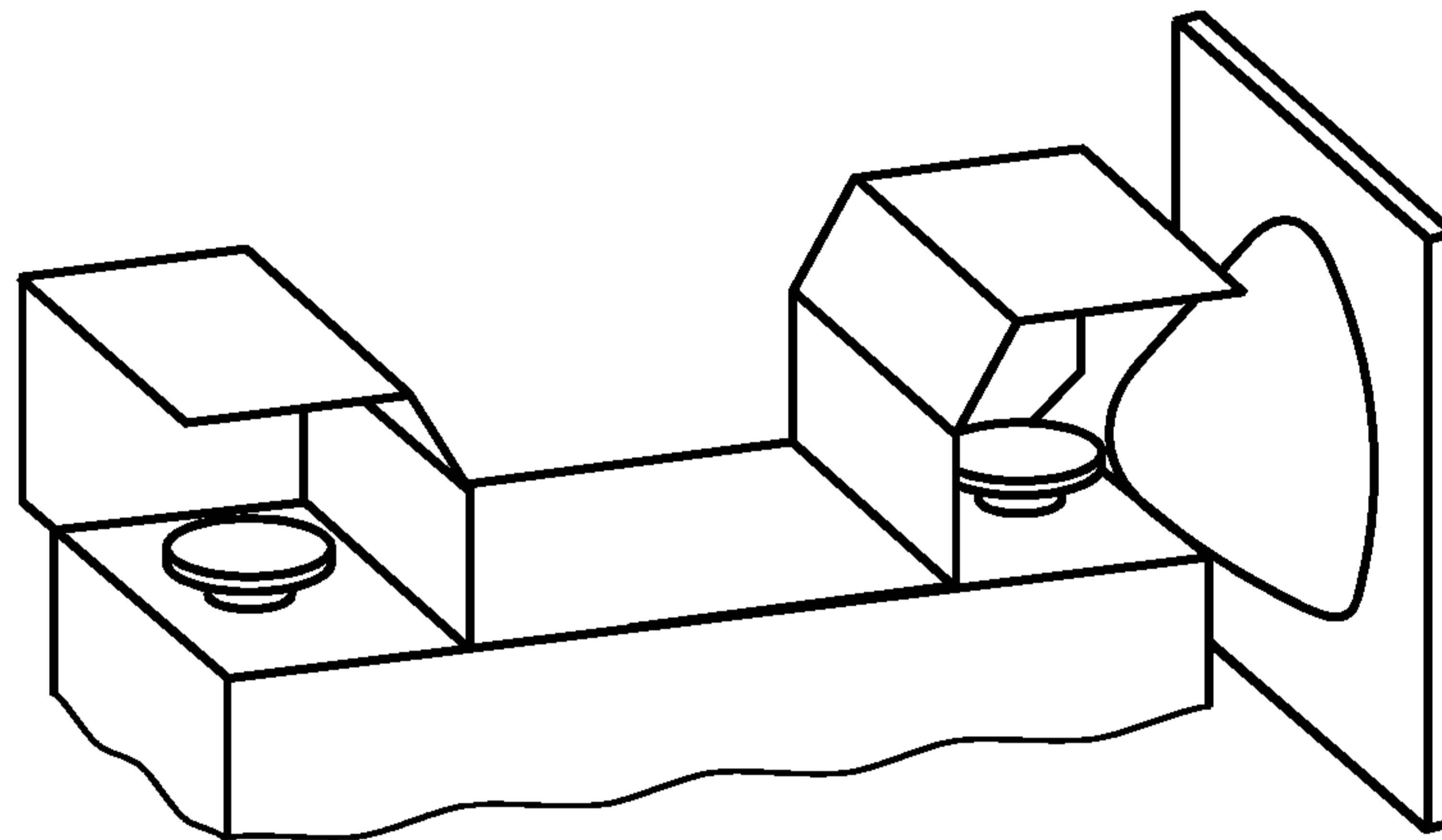
Рисунок А.6 — Применение испытательного конуса
