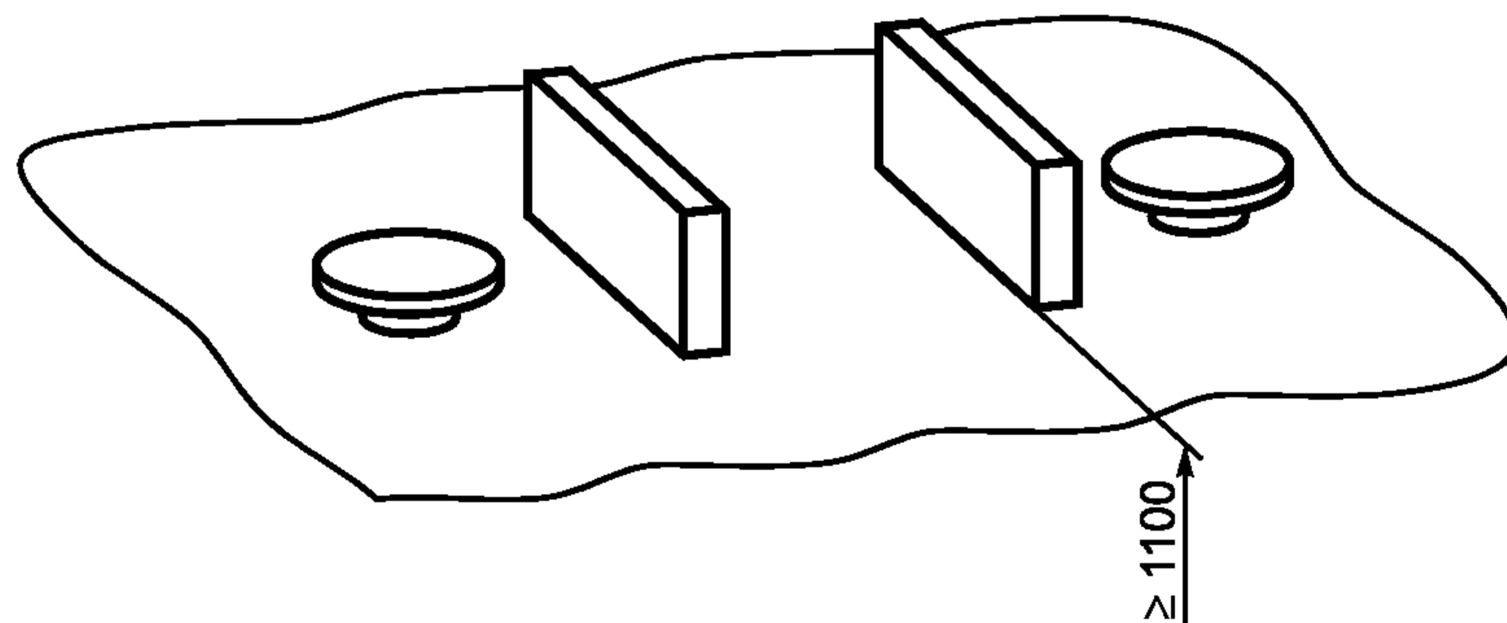
Рисунок А.11 — Предотвращение возможности обхода местом установки
