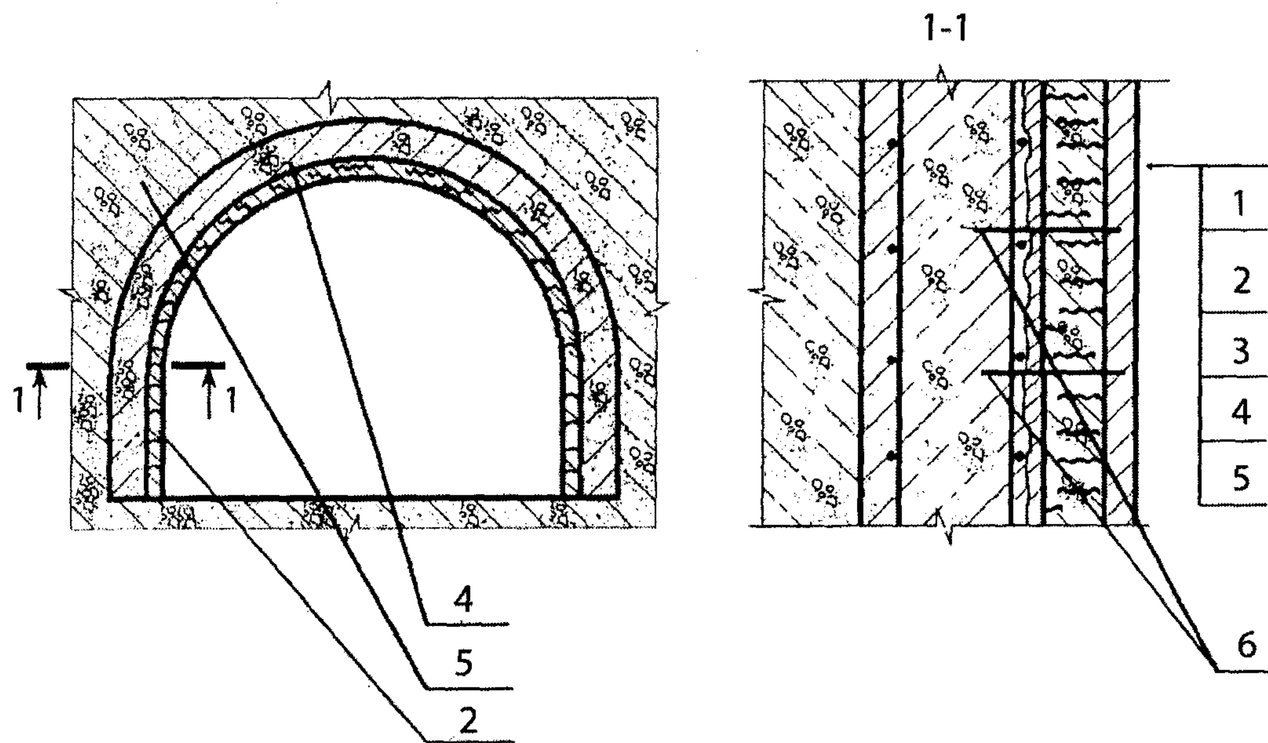
**Рис.8.14. Примеры применения торкрем-фибробетонных защитных покрытий при ремонте строительных конструкций и агрегатов, подвергаемых воздействиям высоких температур**
