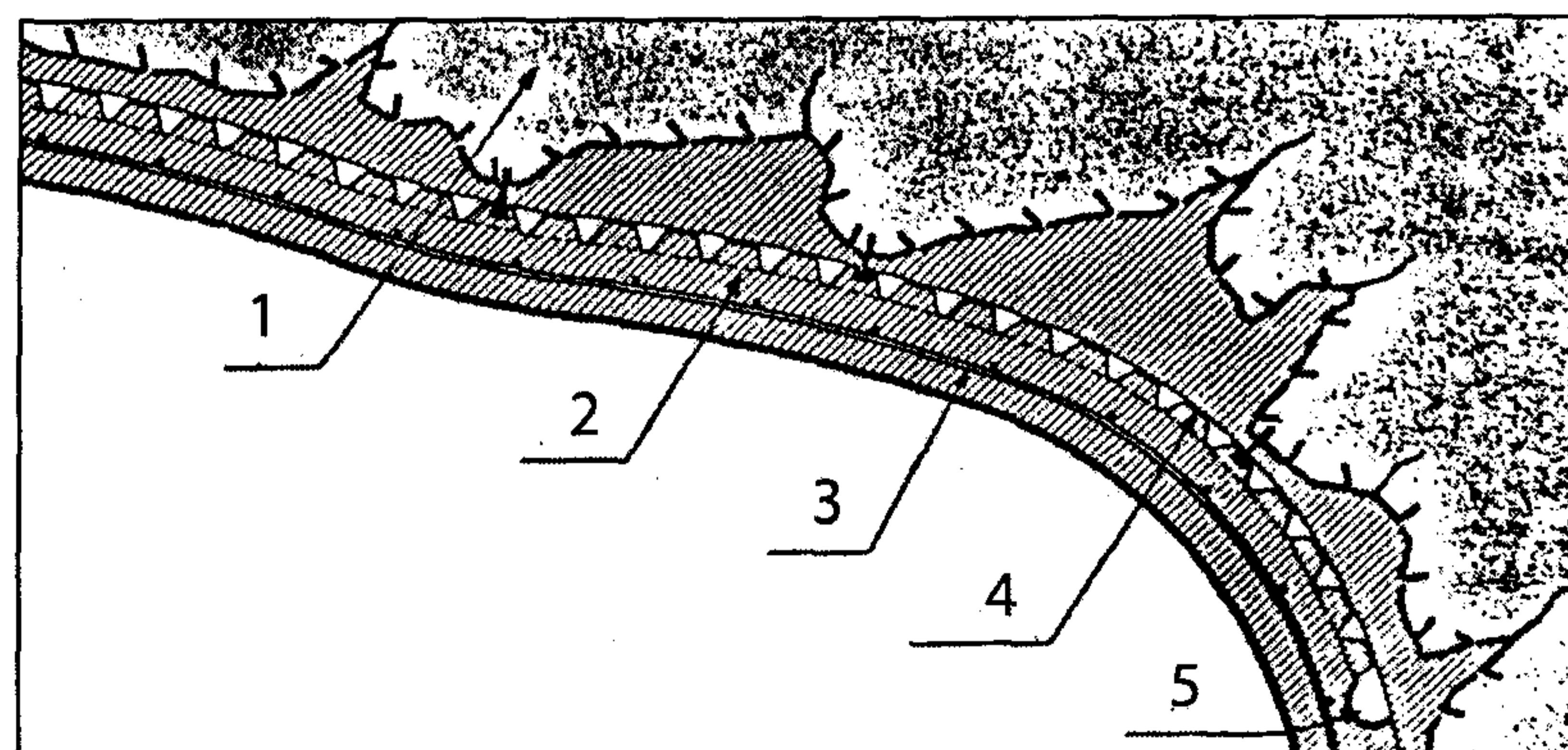
Рис.8.2. Поперечное сечение торкред-бетонного покрытия с использованием в качестве водоотвода «дренажной» фольги и желоба
