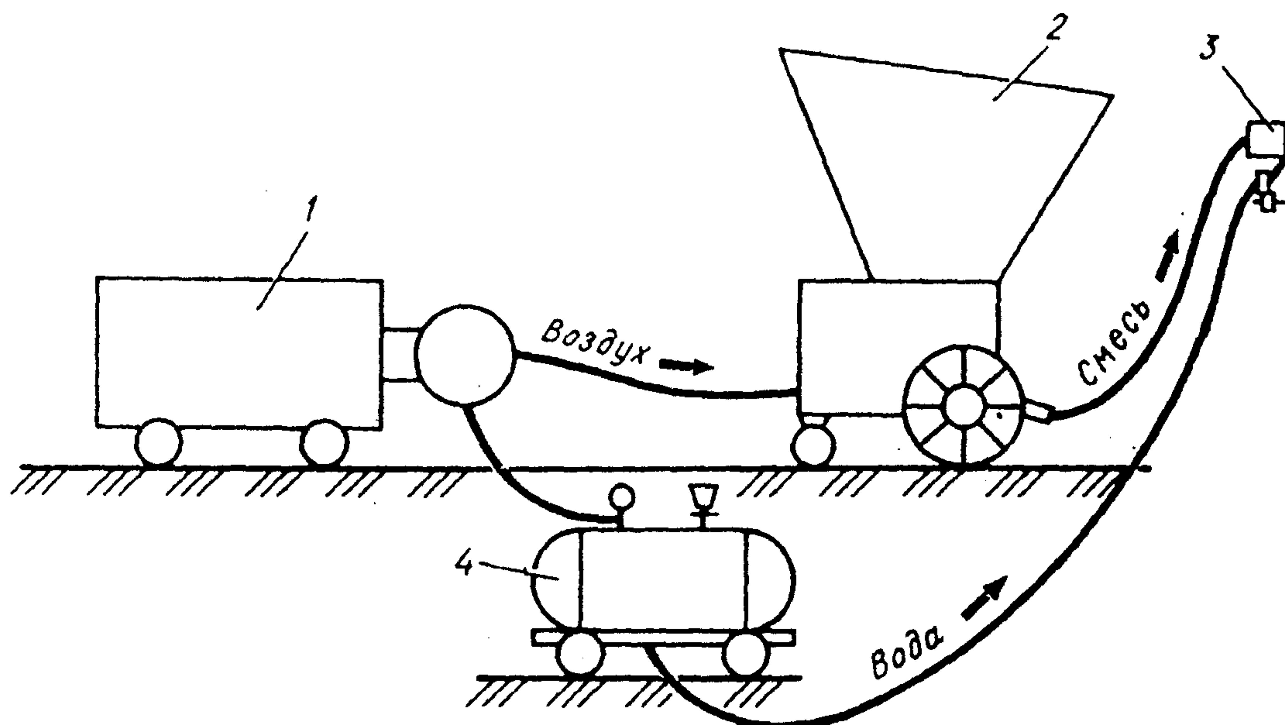
Рис. 1. Схема расположения стационарного оборудования для выполнения торкетных работ методом сухого торкетирования.
