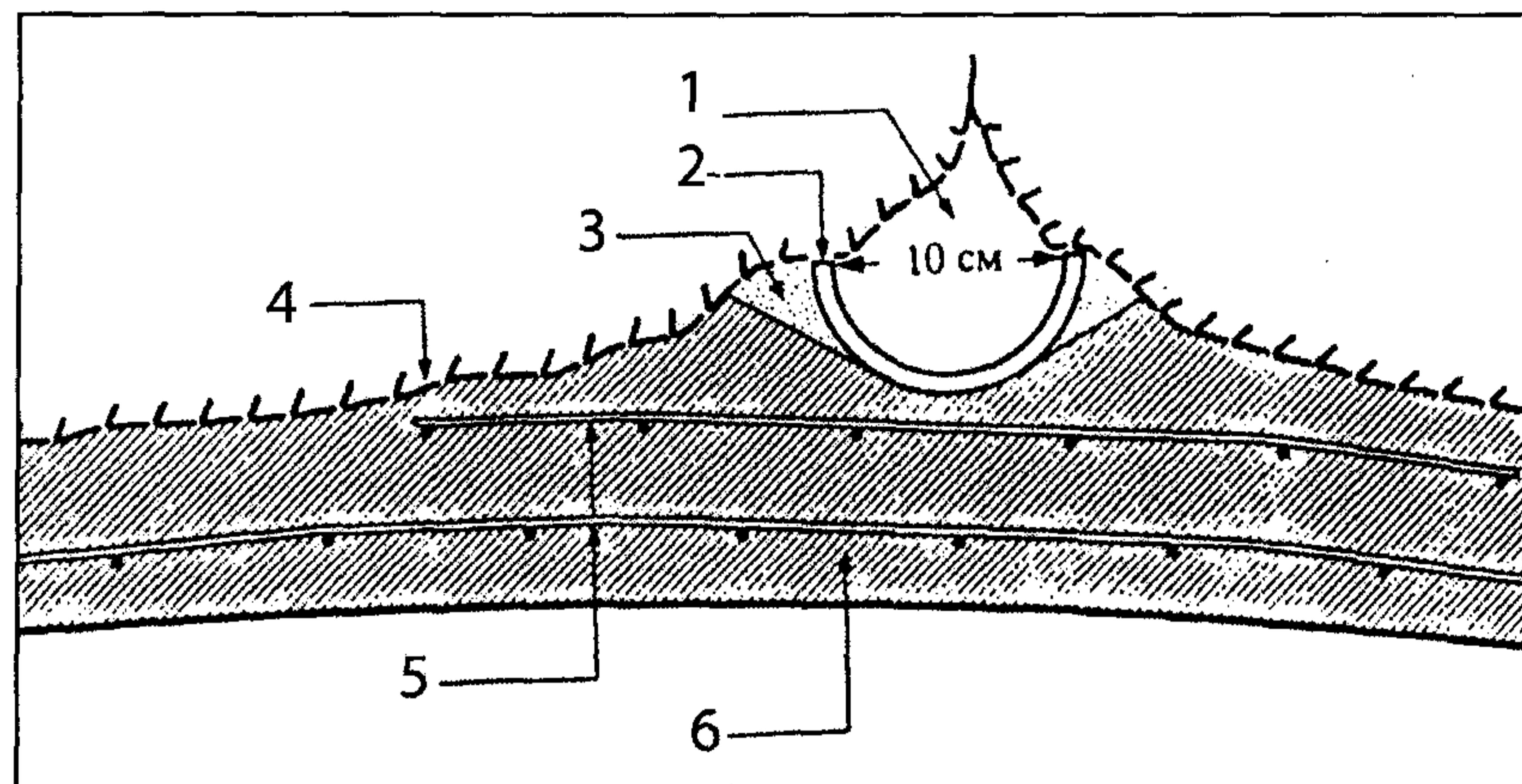
Рис.8.1. Пример устройства водоотвода (дрены) за пределы покрытия из торкред-бетона.
