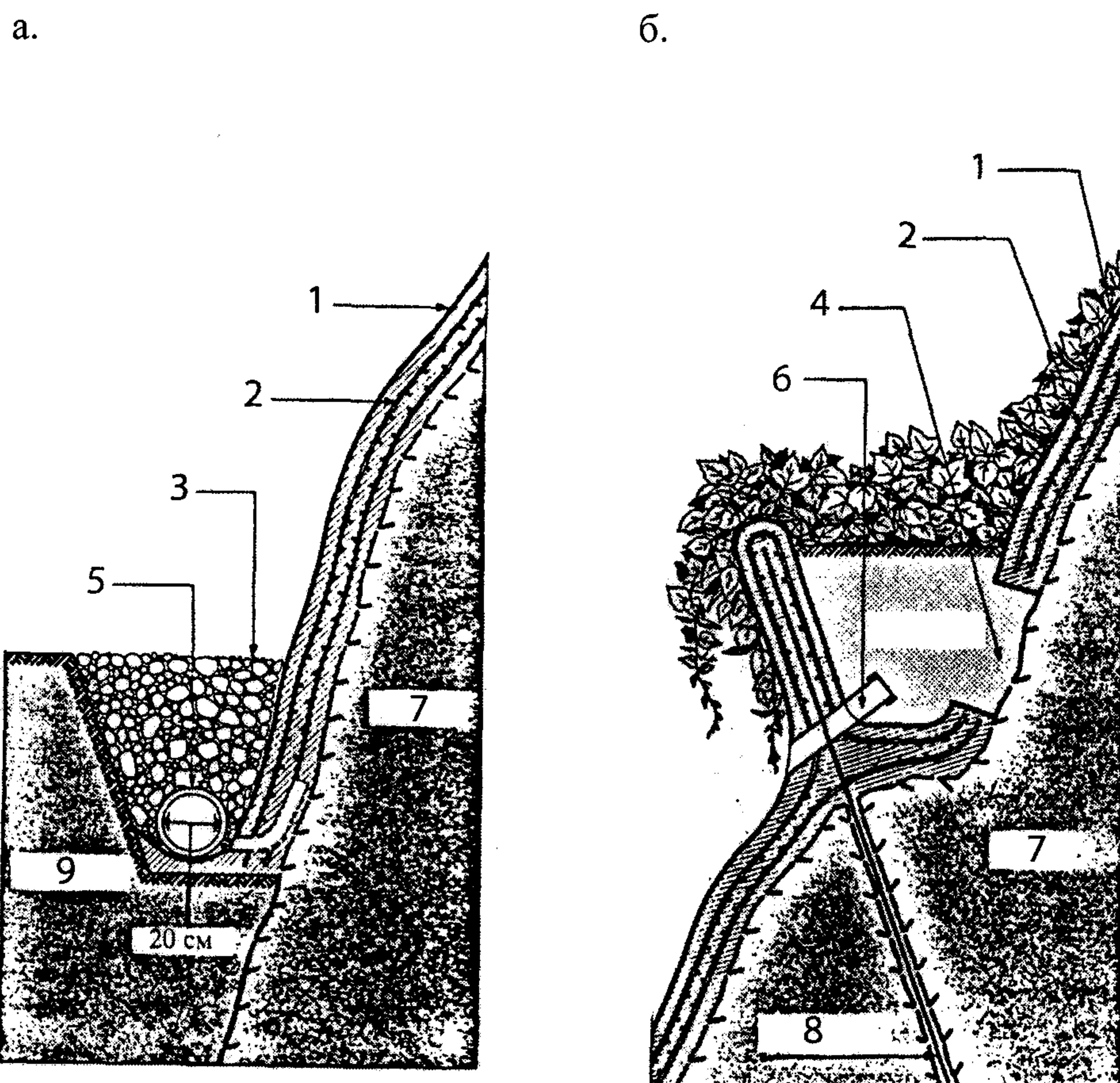
Рис.8.10. Упрочнение склона горной породы (скалы) торкред-бетонным покрытием с различными вариантами водоотвода атмосферных осадков: с использованием дренажной системы (а) и водоотводящей трубы (б)
