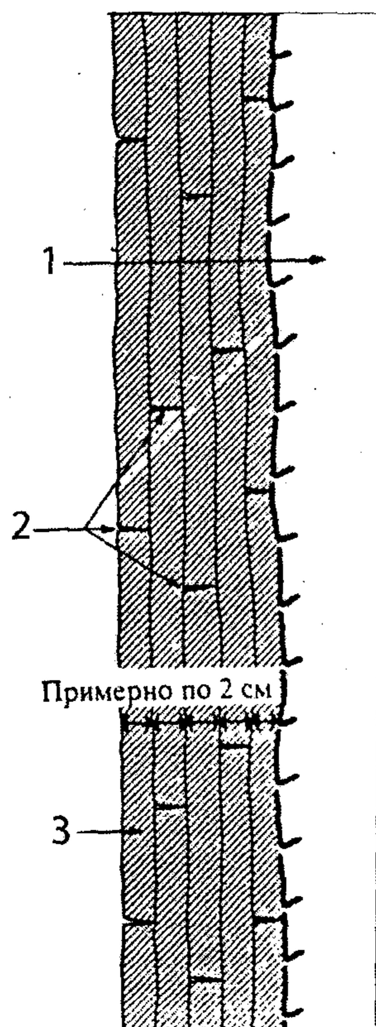
Рис.8.3. Схематическое изображение усадочных трещин в торкред-бетоне при его правильном нанесении
