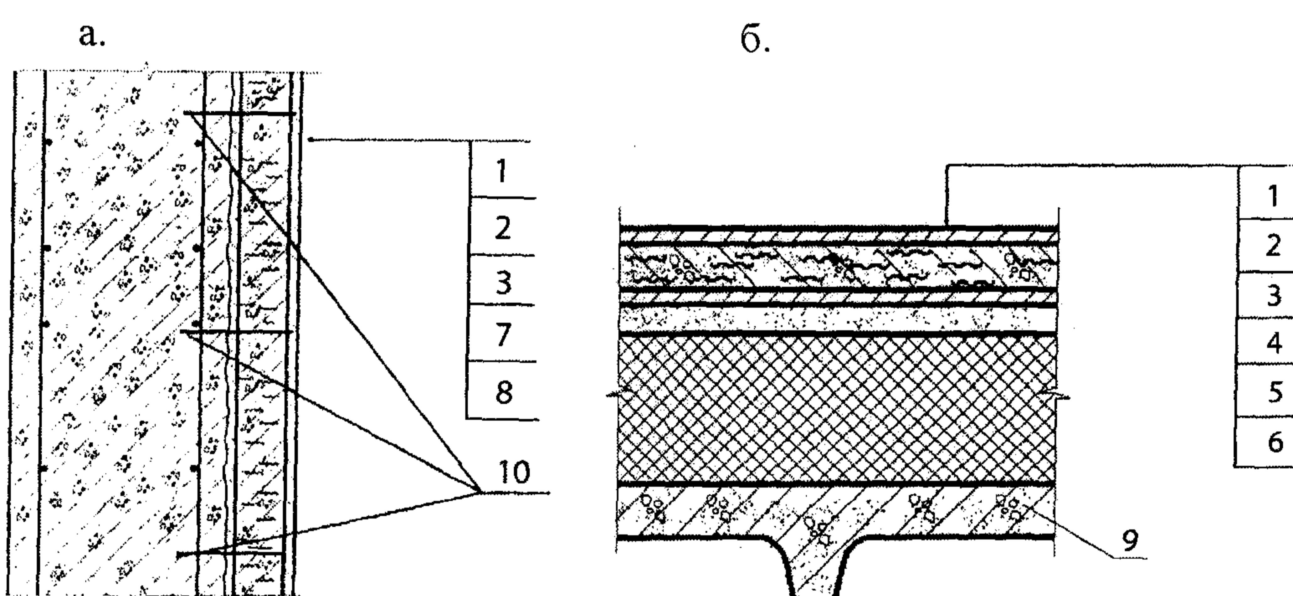
Рис.8.13. Примеры применения торкрем-фибробетонных покрытий в вертикальном (стена силоса – а) и горизонтальном (кровля – б) исполнениях
