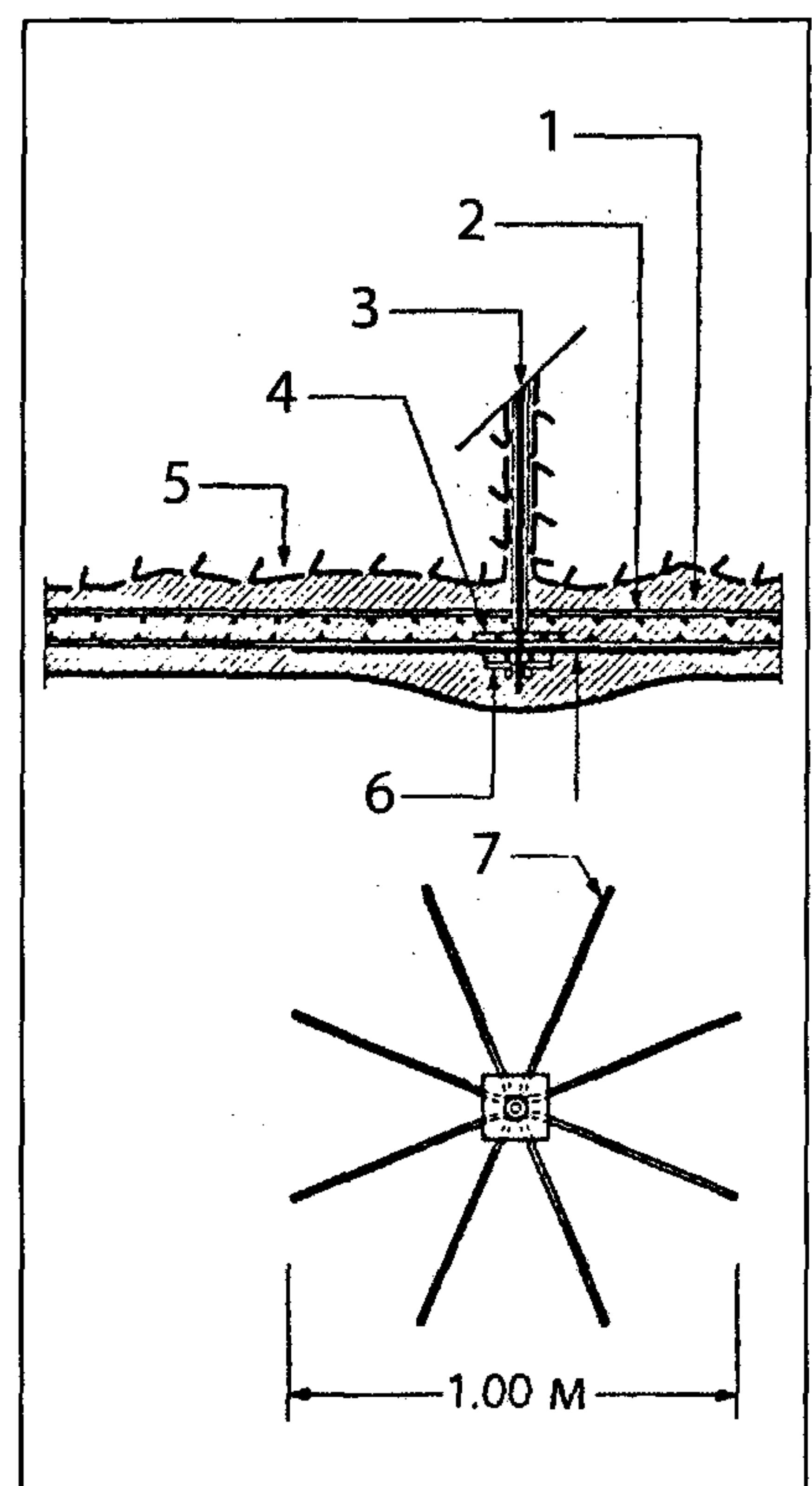
Рис.8.5. Армирование в области анкерной головки
