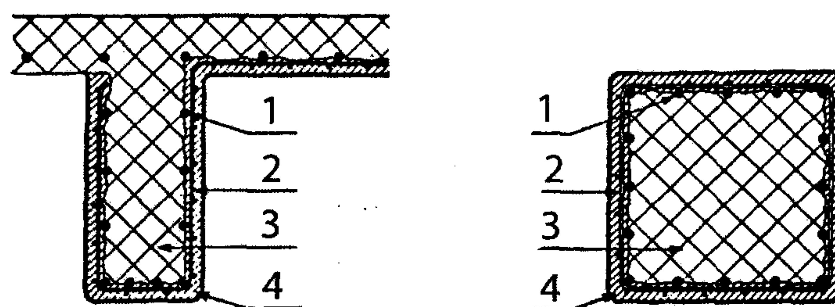
Рис.8.11. Восстановление железобетонных конструкций
