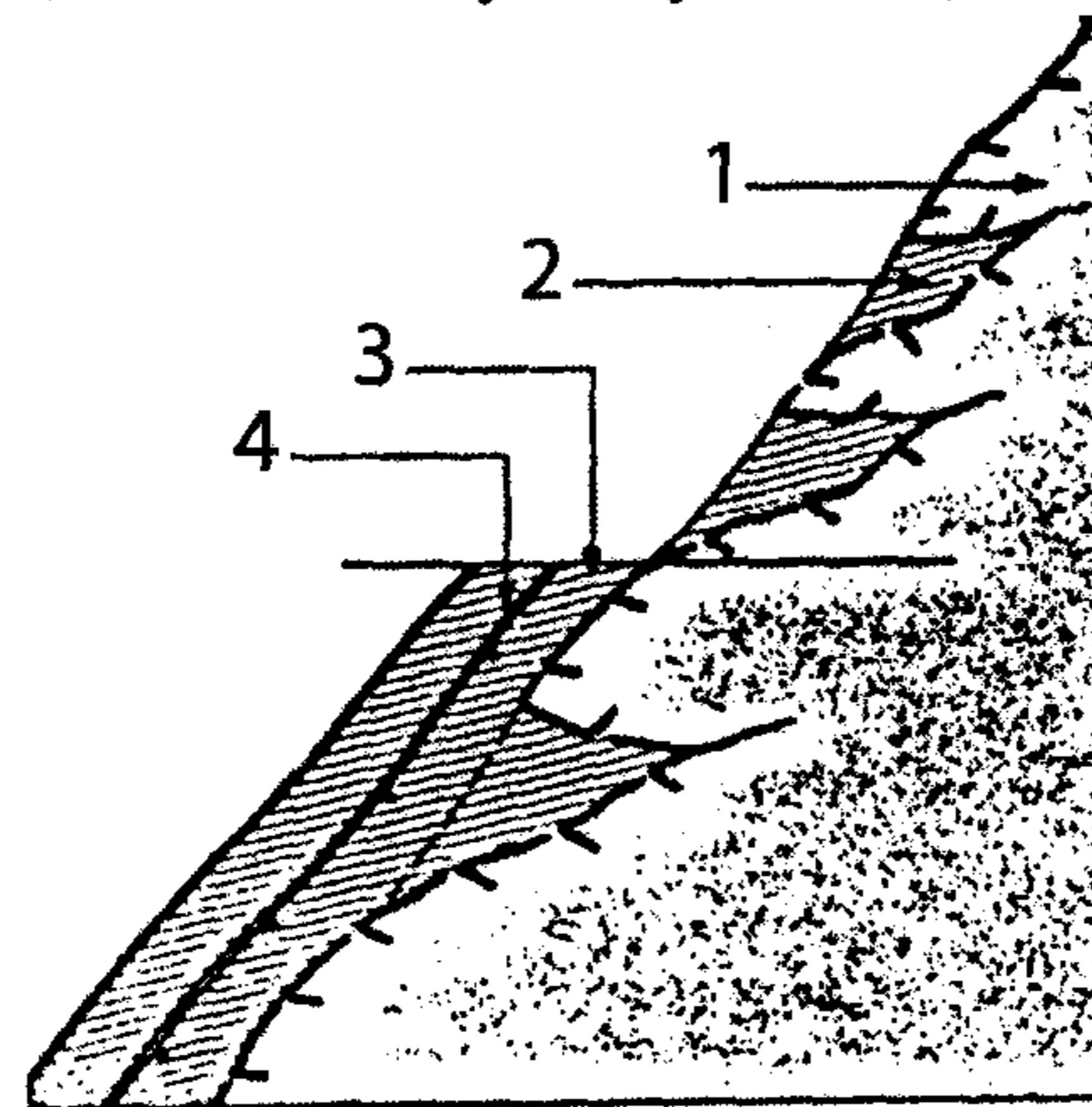
Рис.8.9. Конструктивное решение сплачивания скалы торкрет-бетонным покрытием
