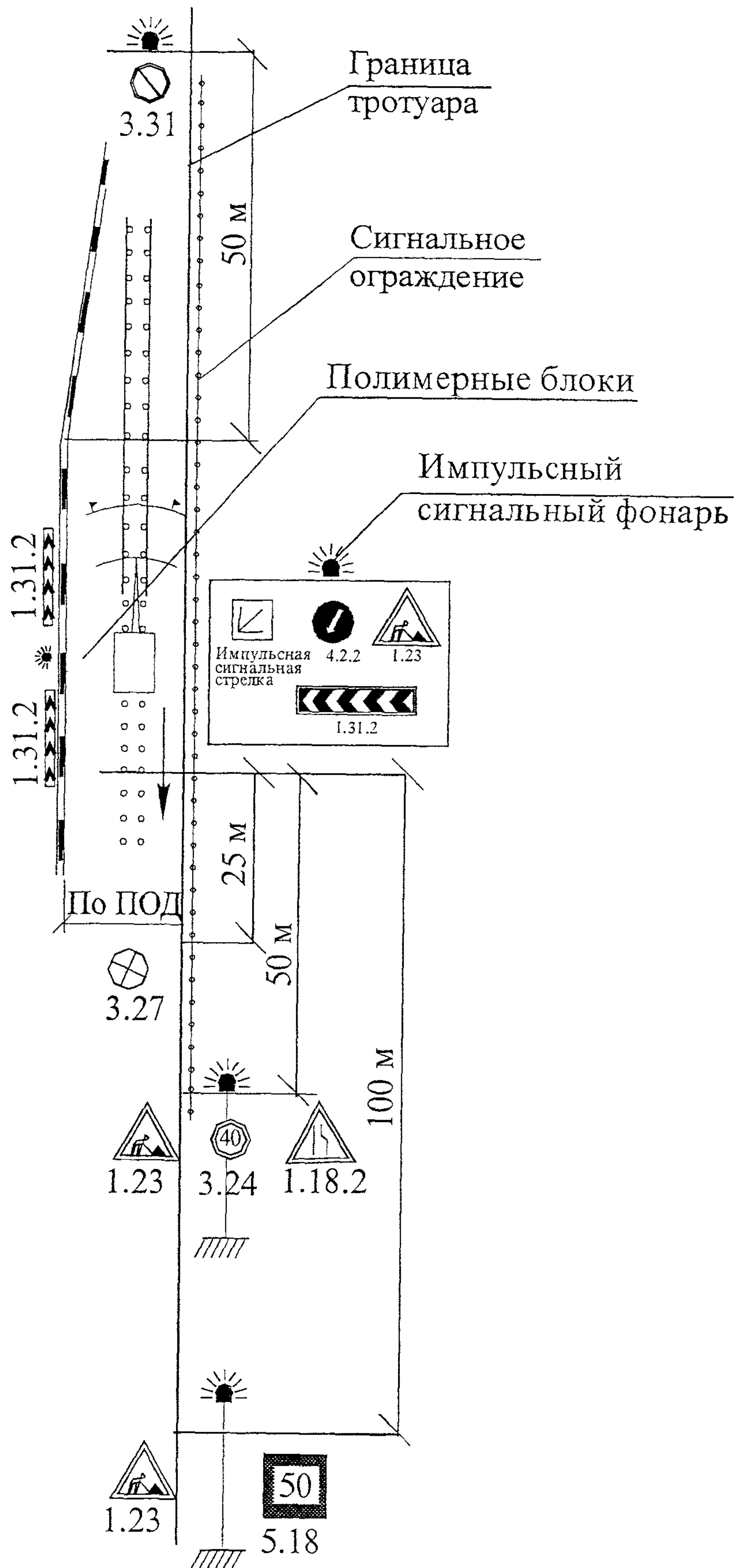
Рисунок 10 – Схема разработки грунта на проезжей части автодороги
