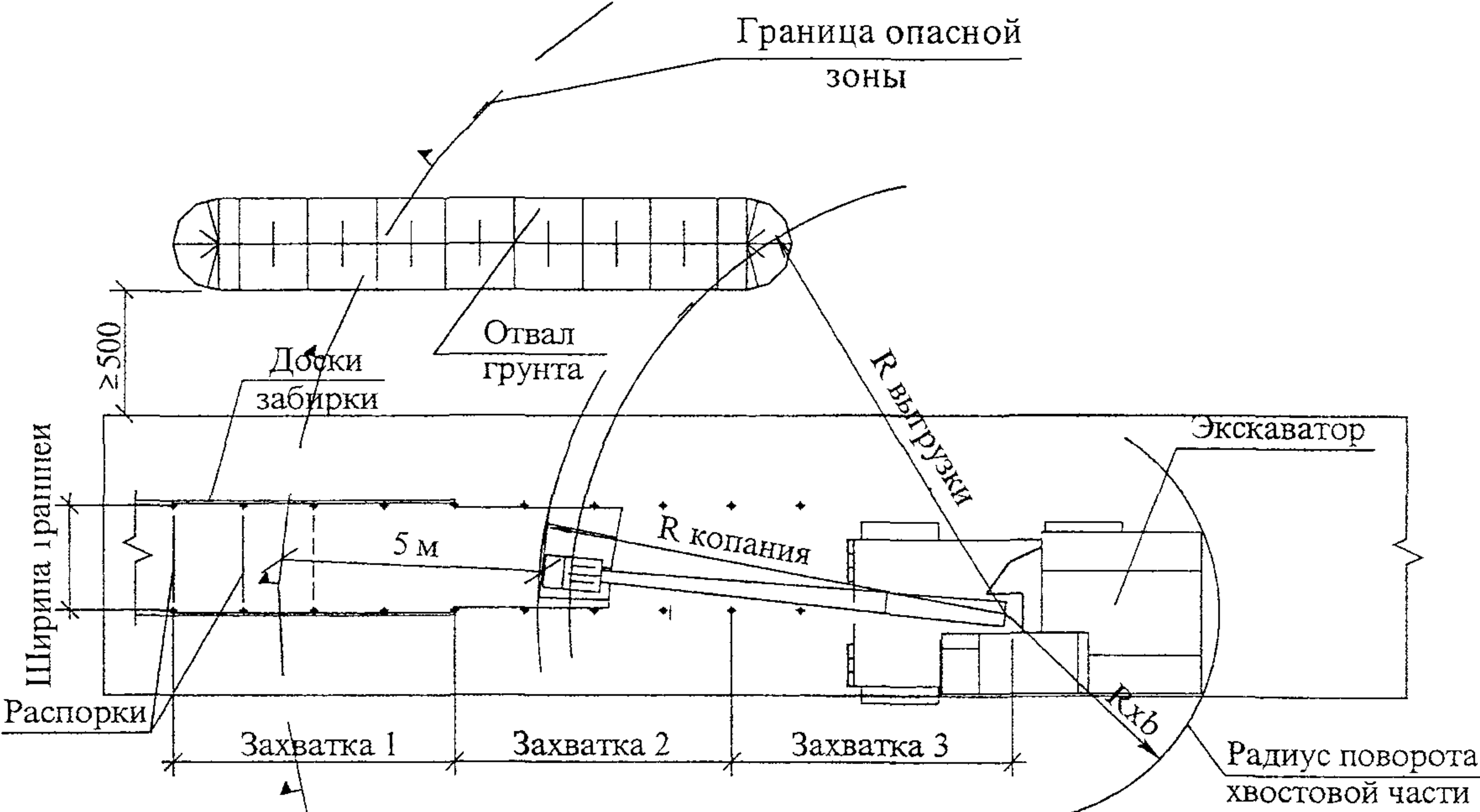
Рисунок 7 – Схема производства работ по разработке грунта траншеи экскаватором и устройства забирок
