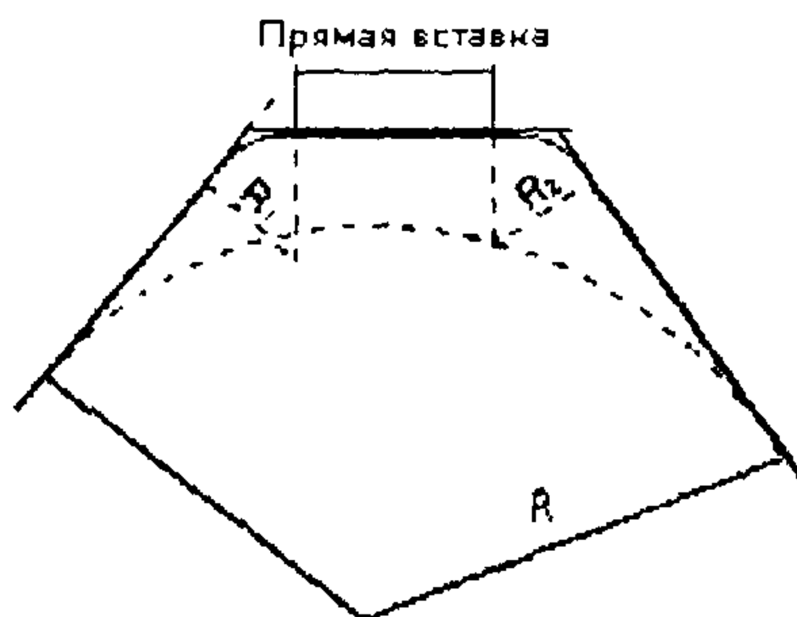
Рис. 1.2. Рекомендации по использованию одной кривой вместо двух кривых малого радиуса
