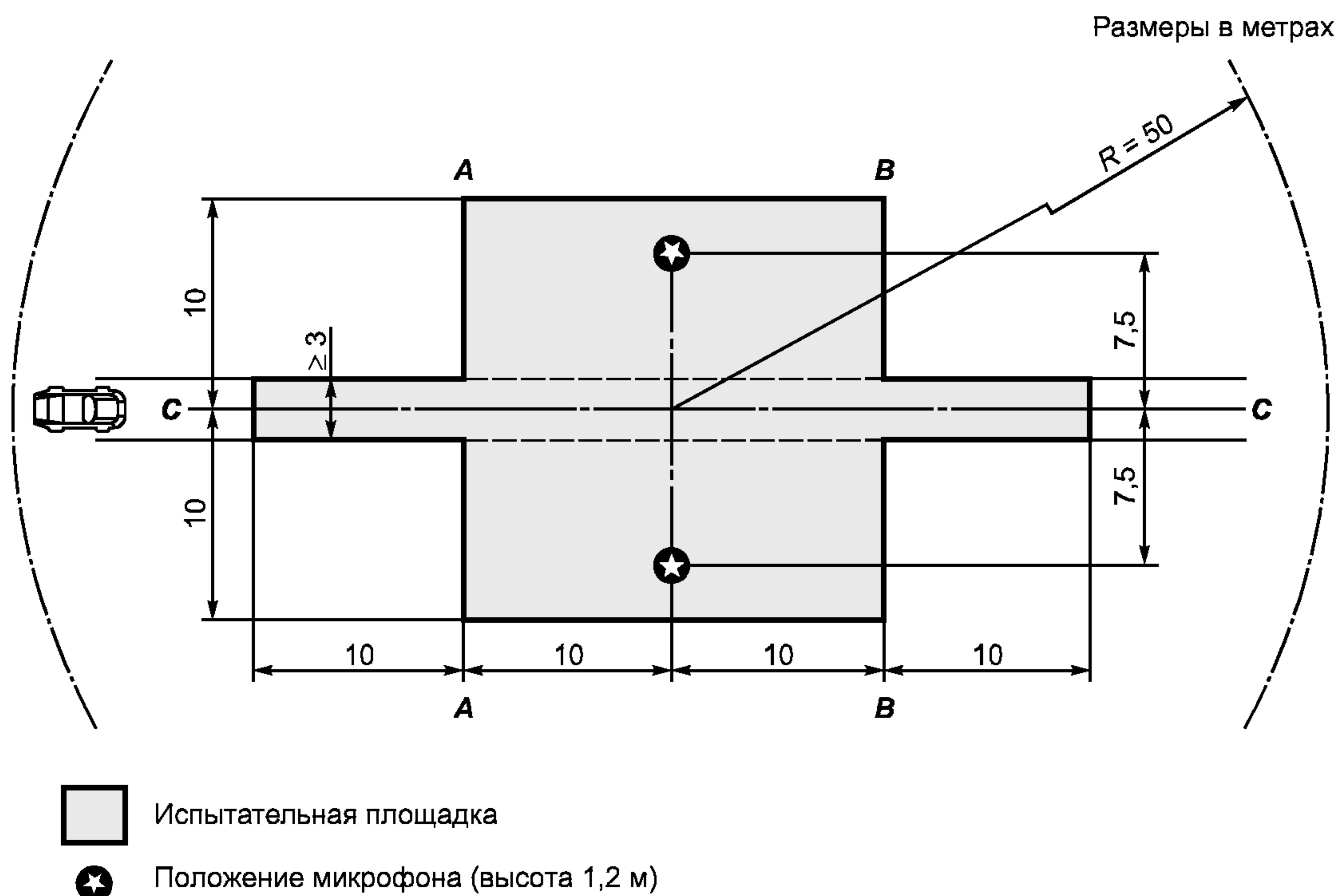
Рисунок 1 — Размеры испытательной площадки
