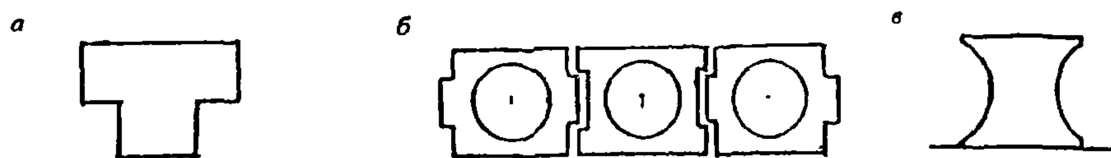
а - тавровое сечение; б - прямоугольное (коробчатое) сечение; в - двутавровое сечение.
