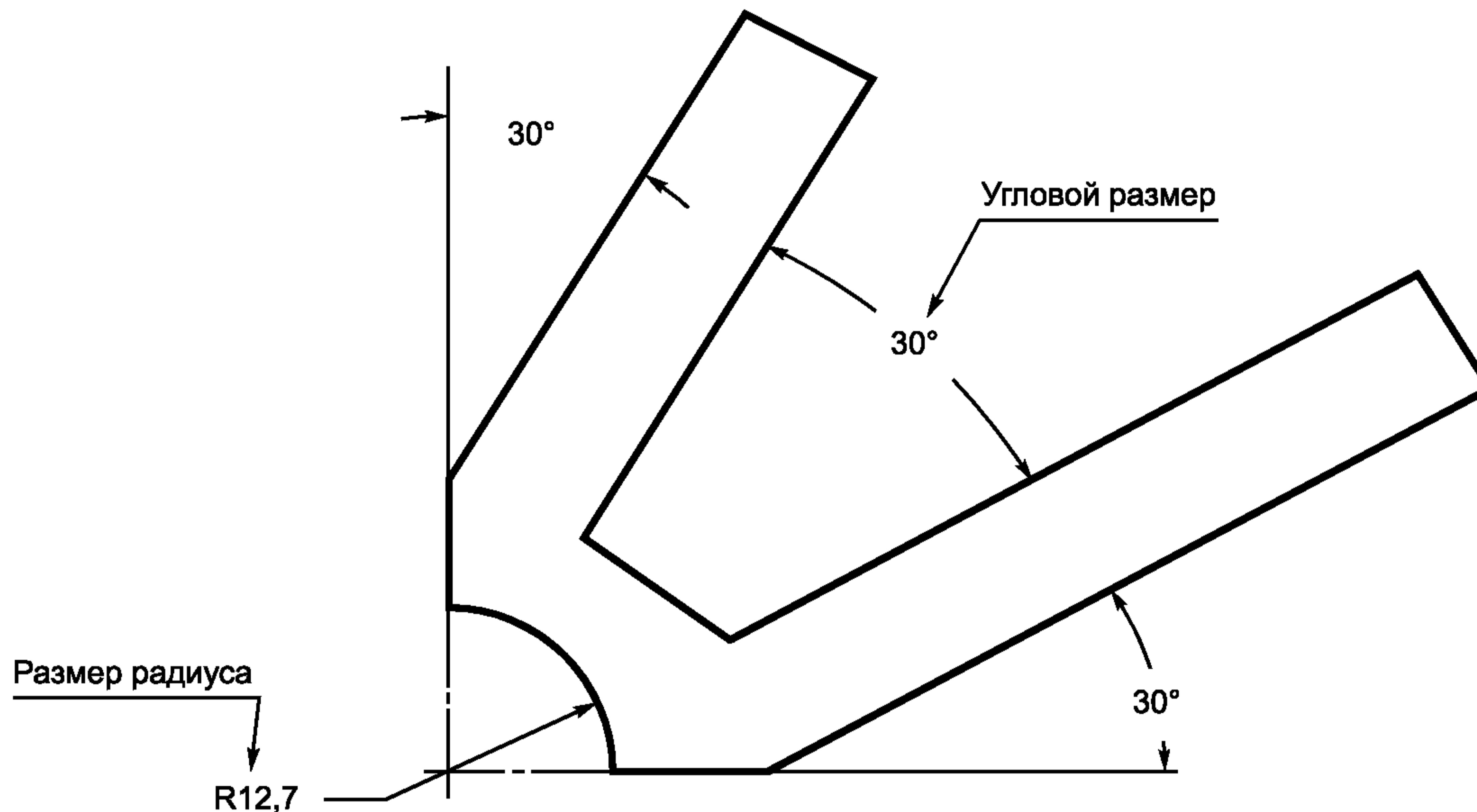
Рисунок 1 — Размеры угла и радиуса
