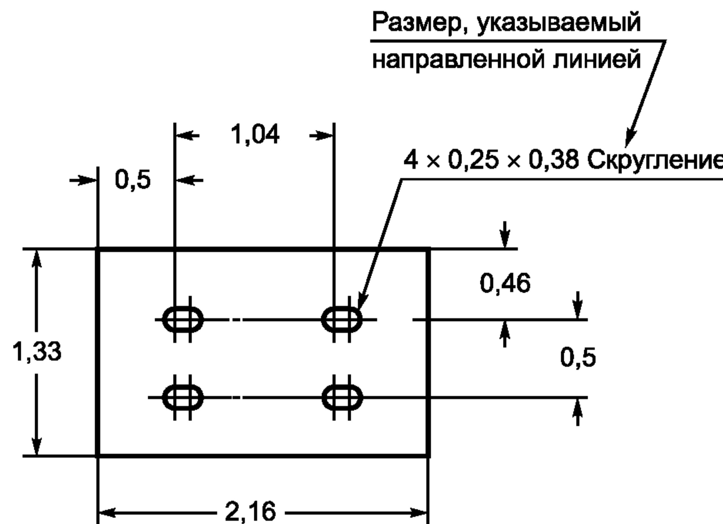
Рисунок 8 — Размер, указываемый направленной линией
