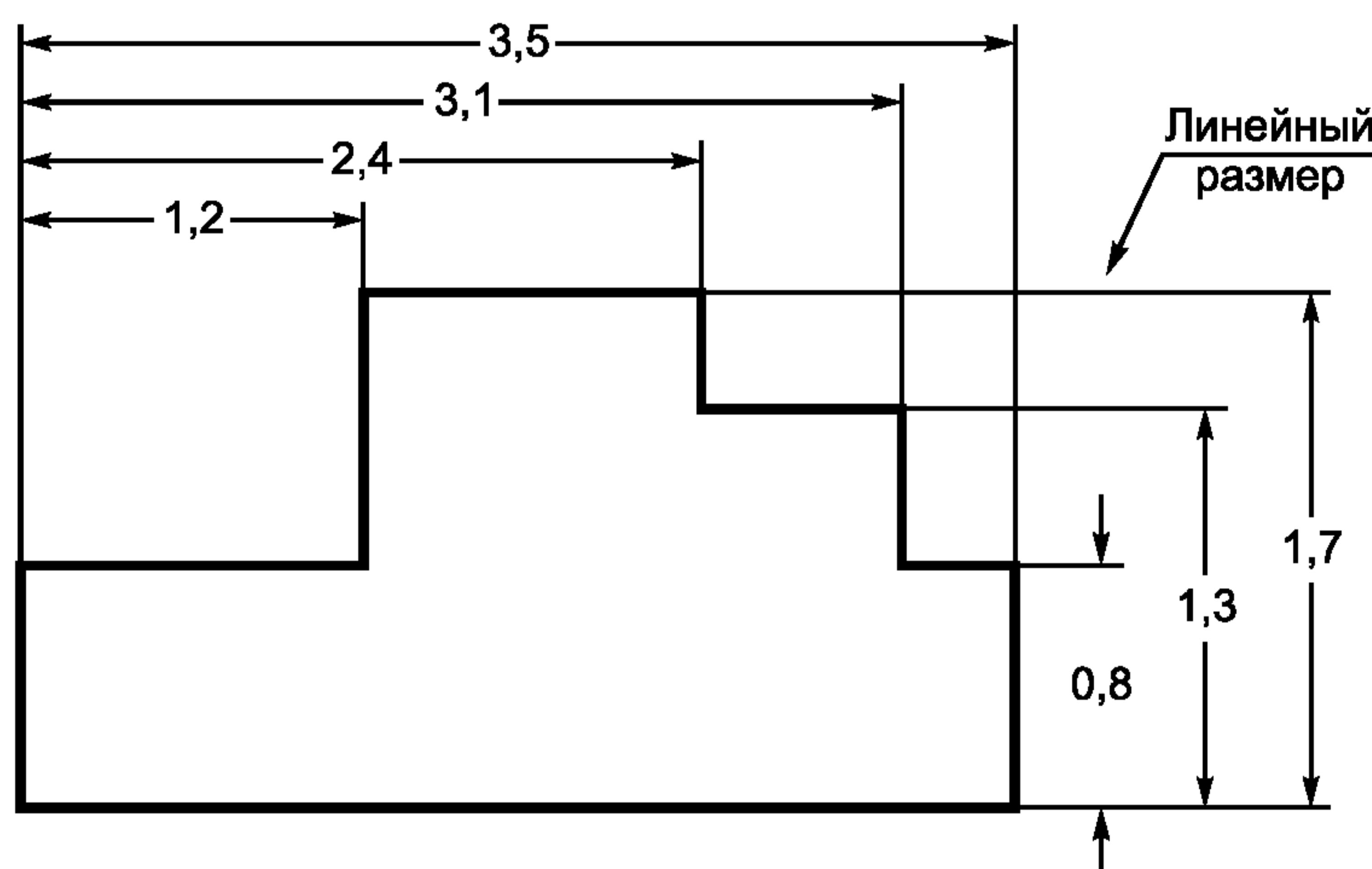
Рисунок 6 — Группы параллельных размеров
