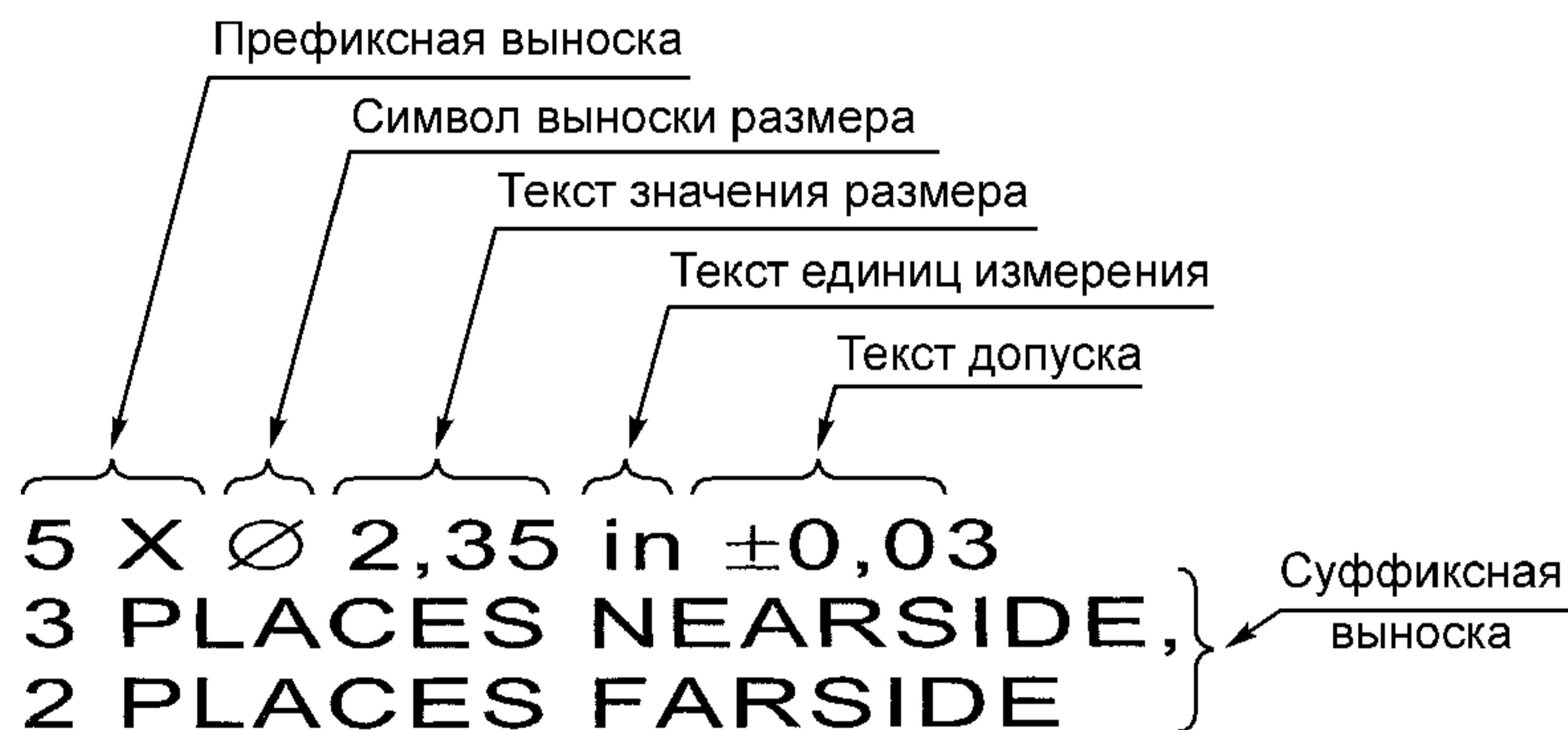
Рисунок 5 — Структурированная выноска размера
