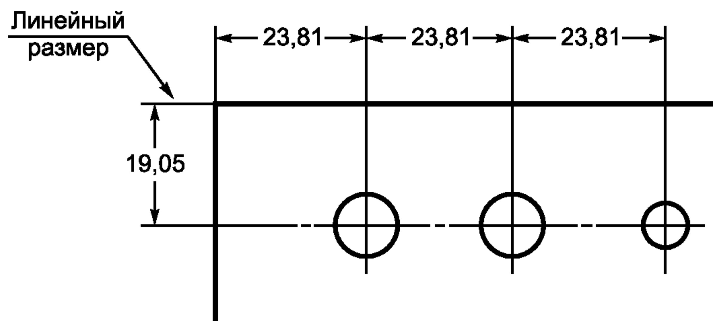
Рисунок 7 — Группа последовательных размеров
