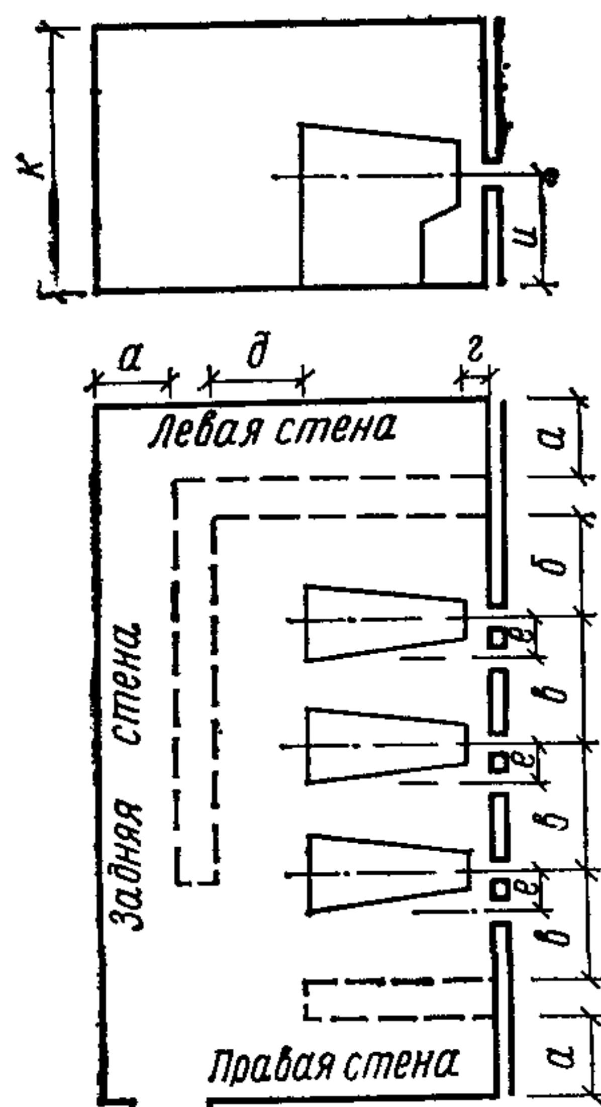
Рис. 4. Схема планировки проекционной
