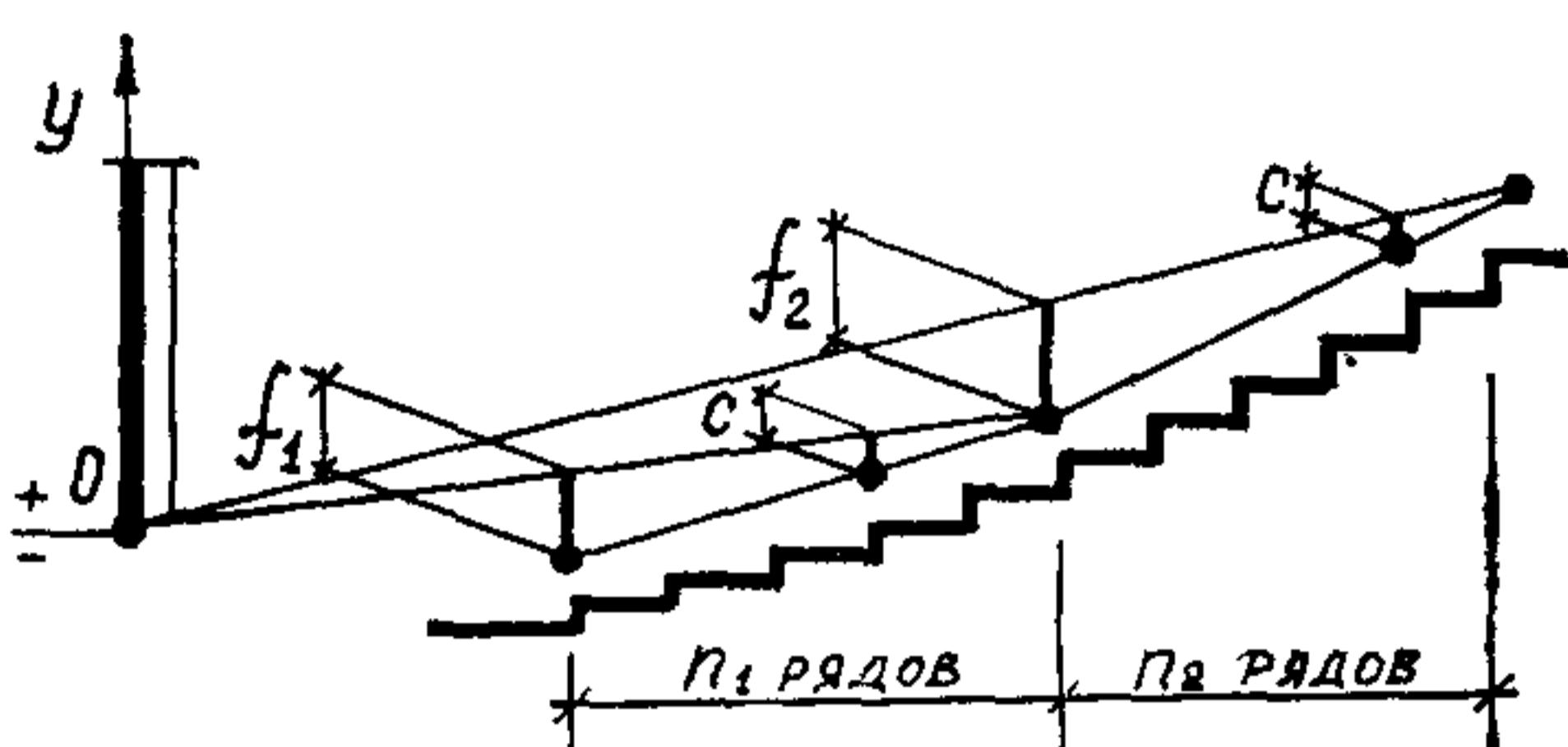
**Рис. 5. Профиль зрительских мест по отрезкам ломаной линии**
