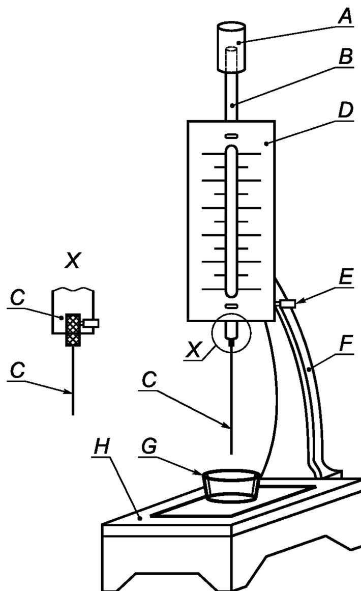
*A* — дополнительная нагрузка; *B* — стержень; *C* — игла Вика; *D* — градуированная шкала; *E* — винтовой зажим; *F* — поддерживающая опора; *G* — конусная цилиндрическая форма; *H* — основание пластины
