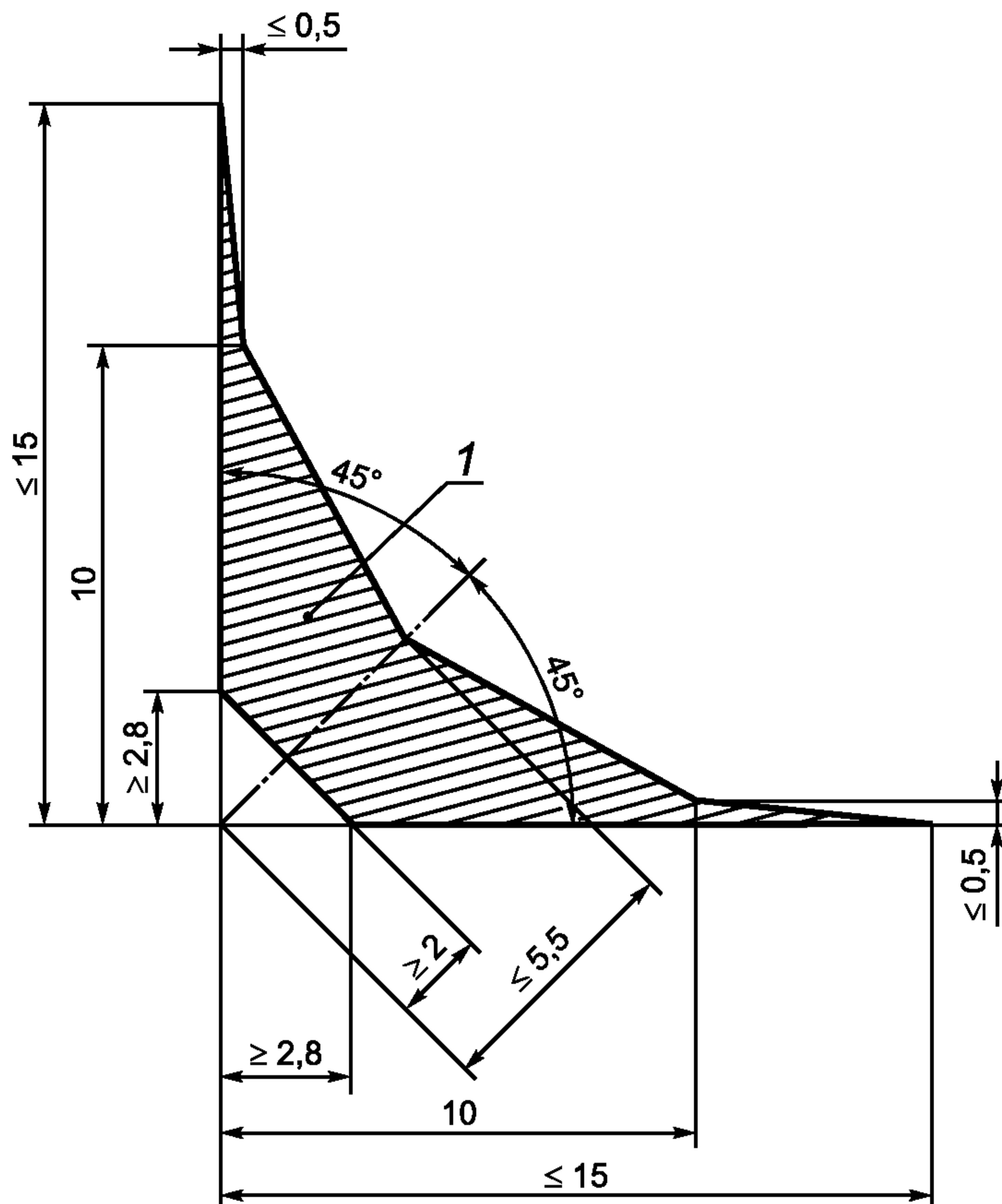
1 — область, в которой разрешается закруглять углы
