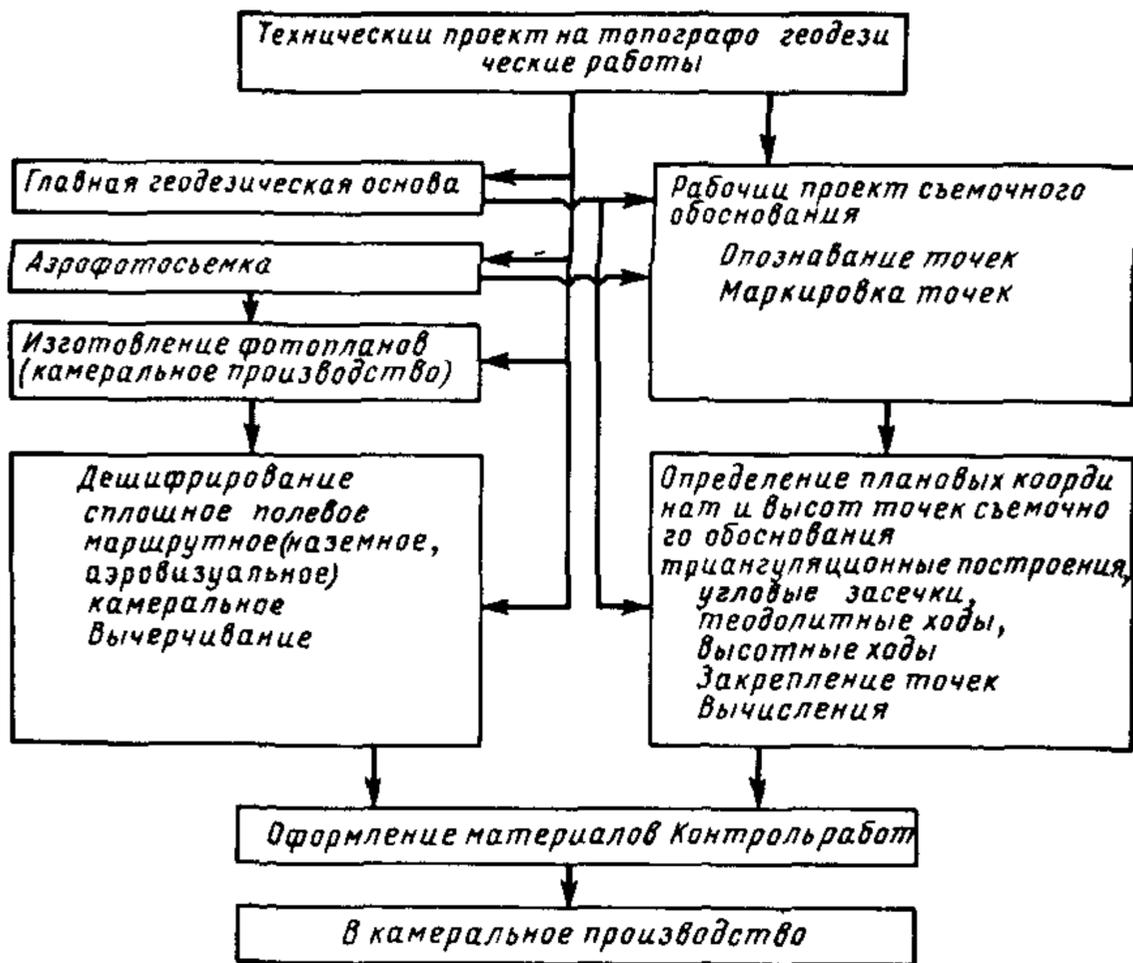
Рис. 1. Технологическая схема полевых работ при стереотопографической съемке
