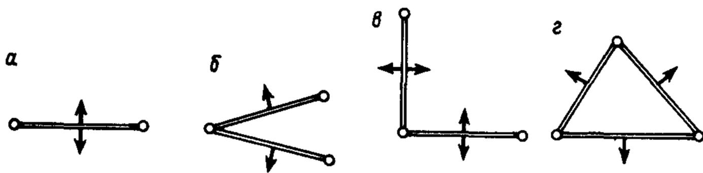
Рис. 36. Схемы расположения базисов фотографирования:
