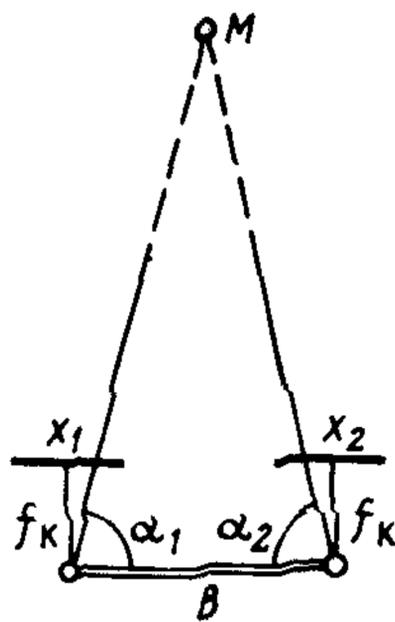
Рис. 38. Схема измерения контрольных направлений
