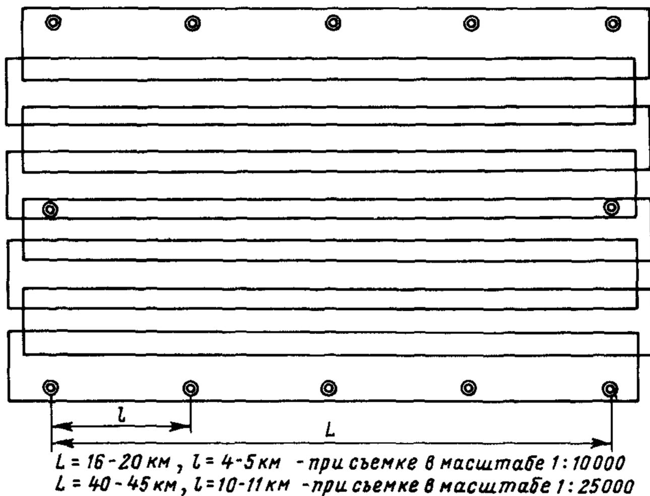
Рис. 9. Схема съемочного обоснования блока
