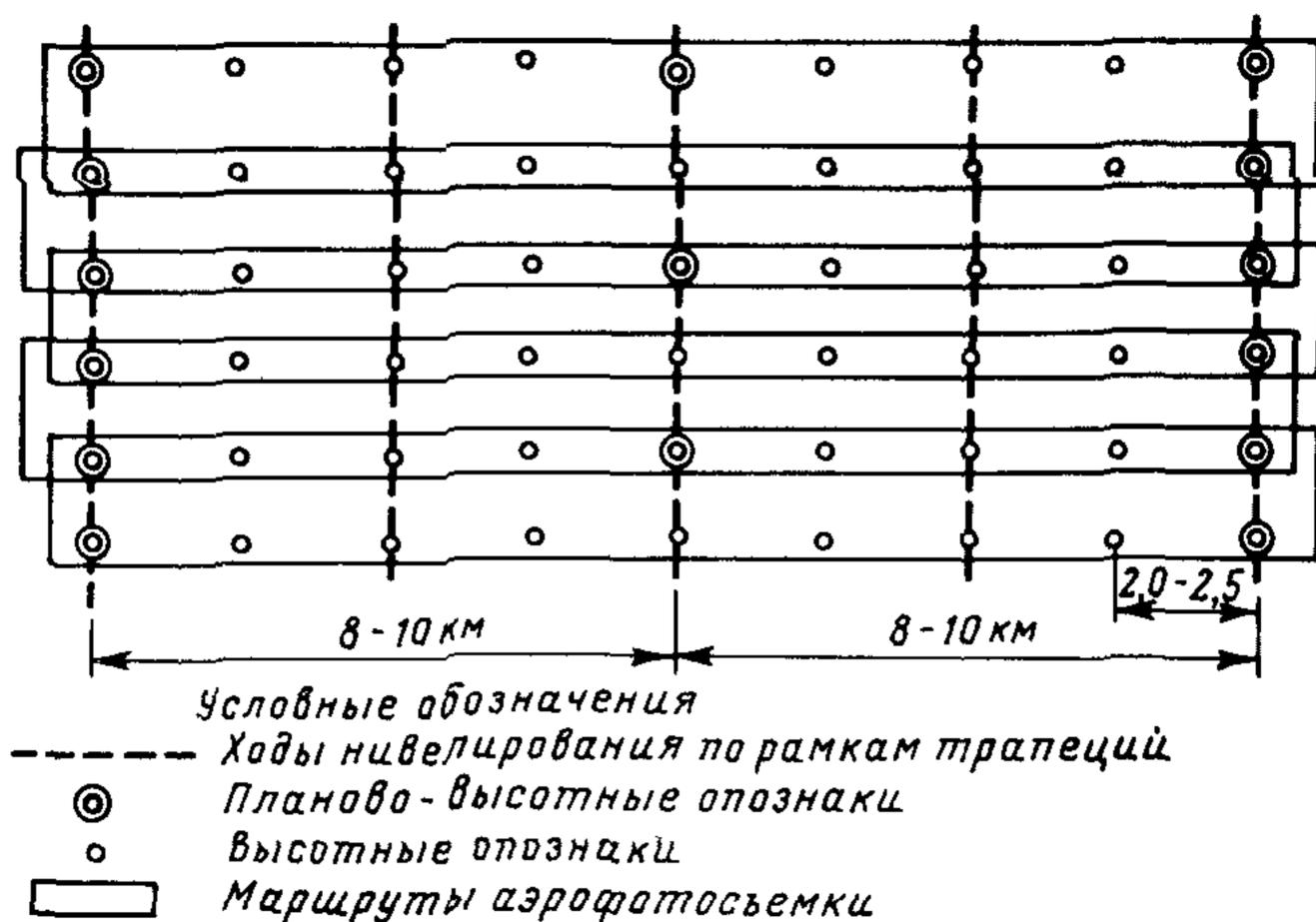
Рис. 3. Съёмка в масштабе 1:10 000 с сечением рельефа через 1,0 м
