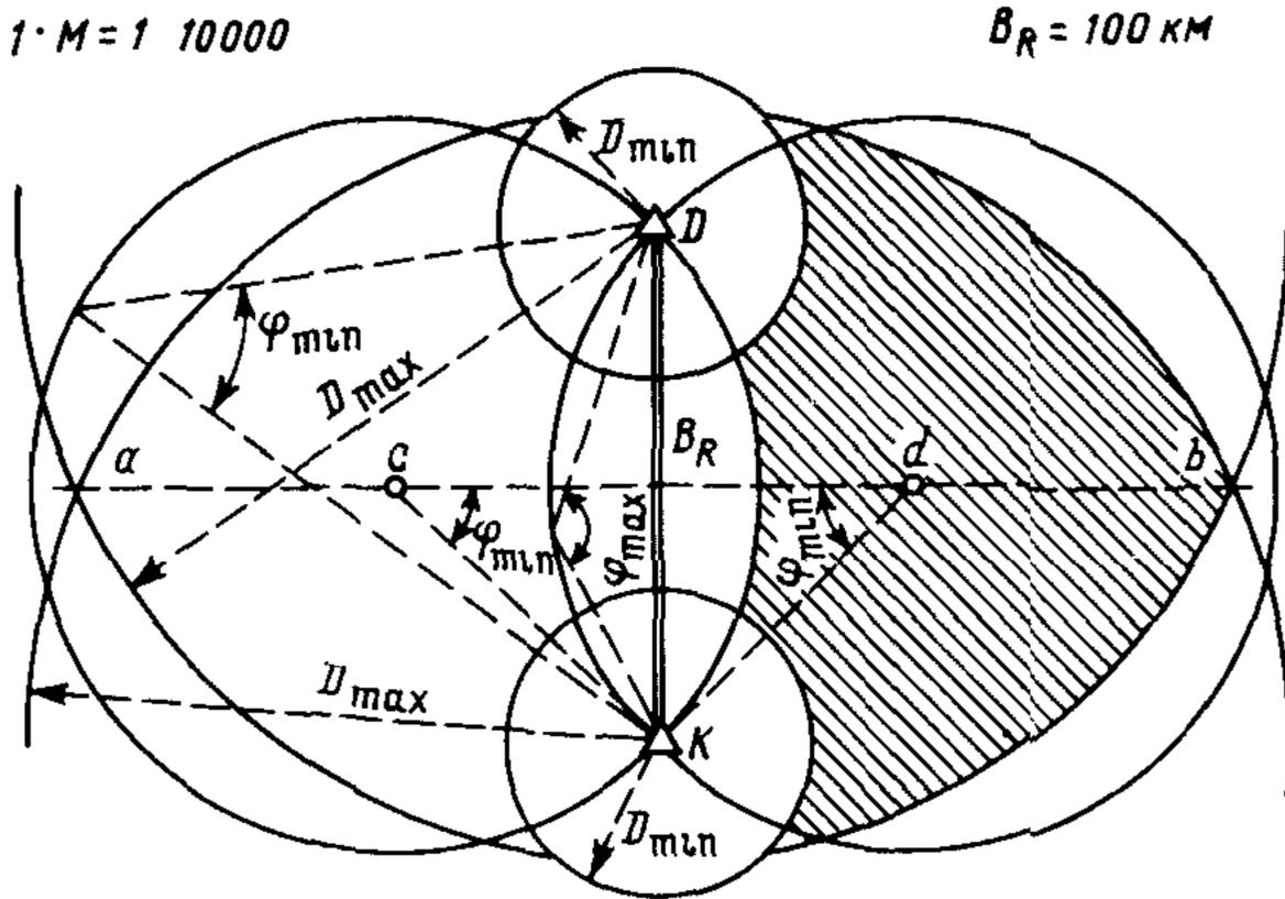
Рис. 39. Палетка рабочей зоны самолетного радиодальномера
