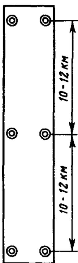
Рис. 10. Схема съемочного обоснования каркасного маршрута
