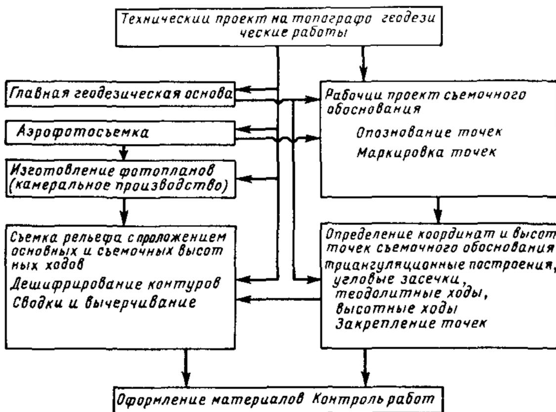
Рис. 2. Технологическая схема полевых работ при комбинированной съемке
