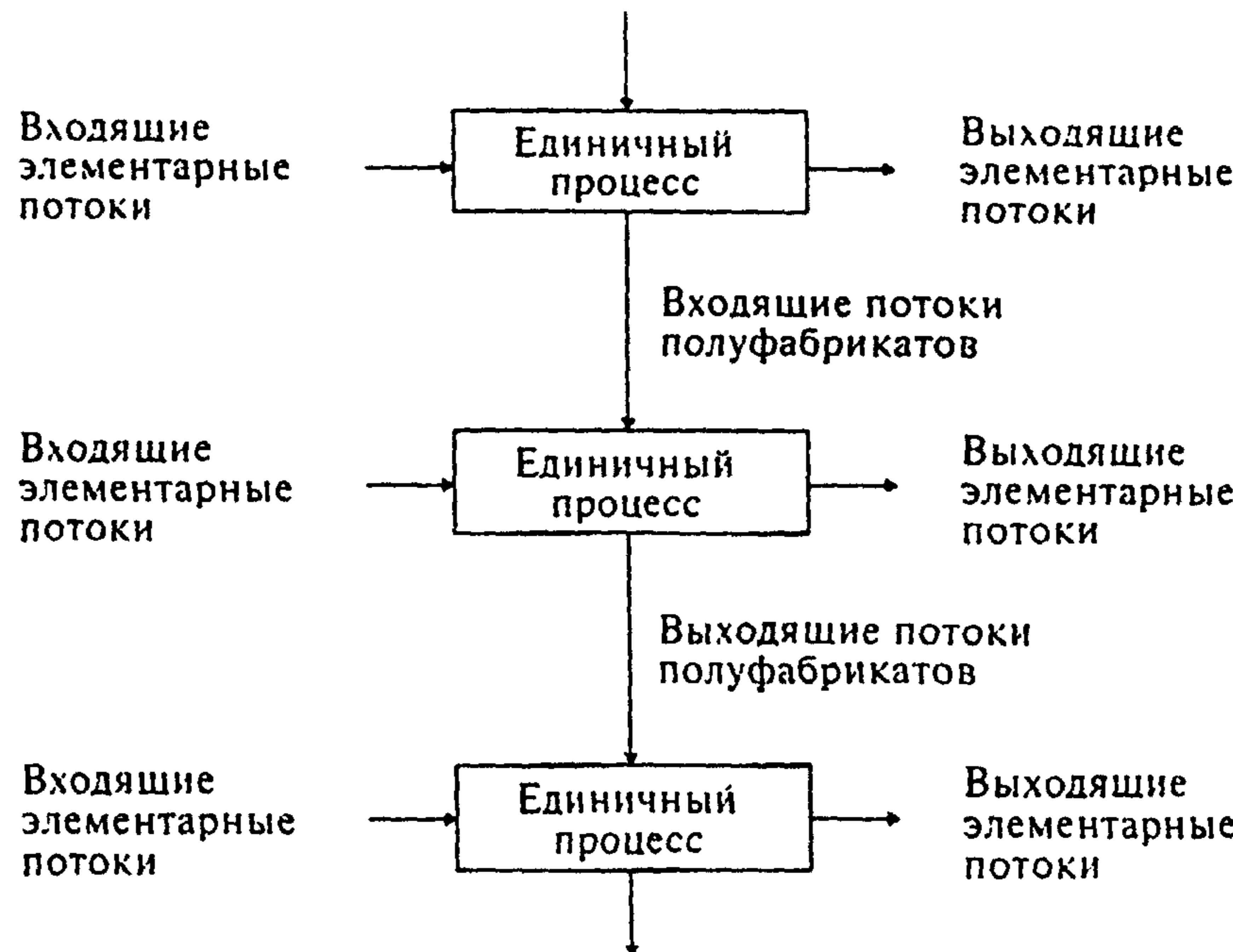
Рисунок 4 – Совокупность единичных процессов в производственной системе
