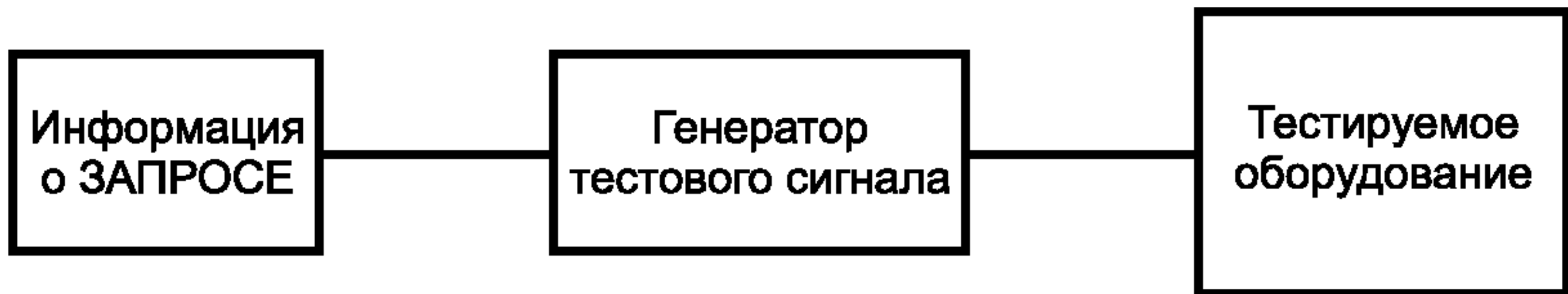
Рисунок А.2 — Оборудование для тестирования качества сигнала при приеме
