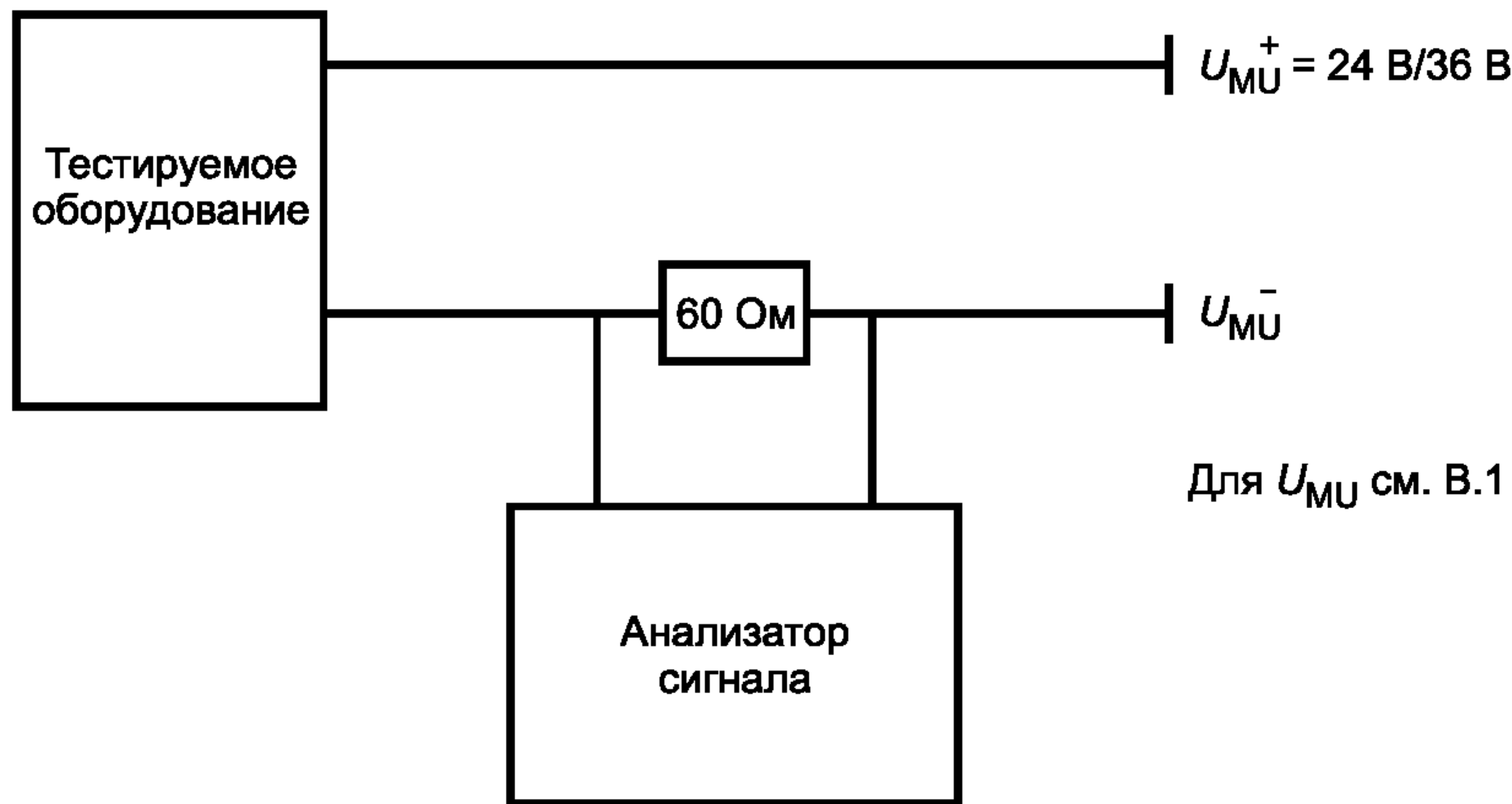
Рисунок А.1 — Оборудование для тестирования качества сигнала при передаче
