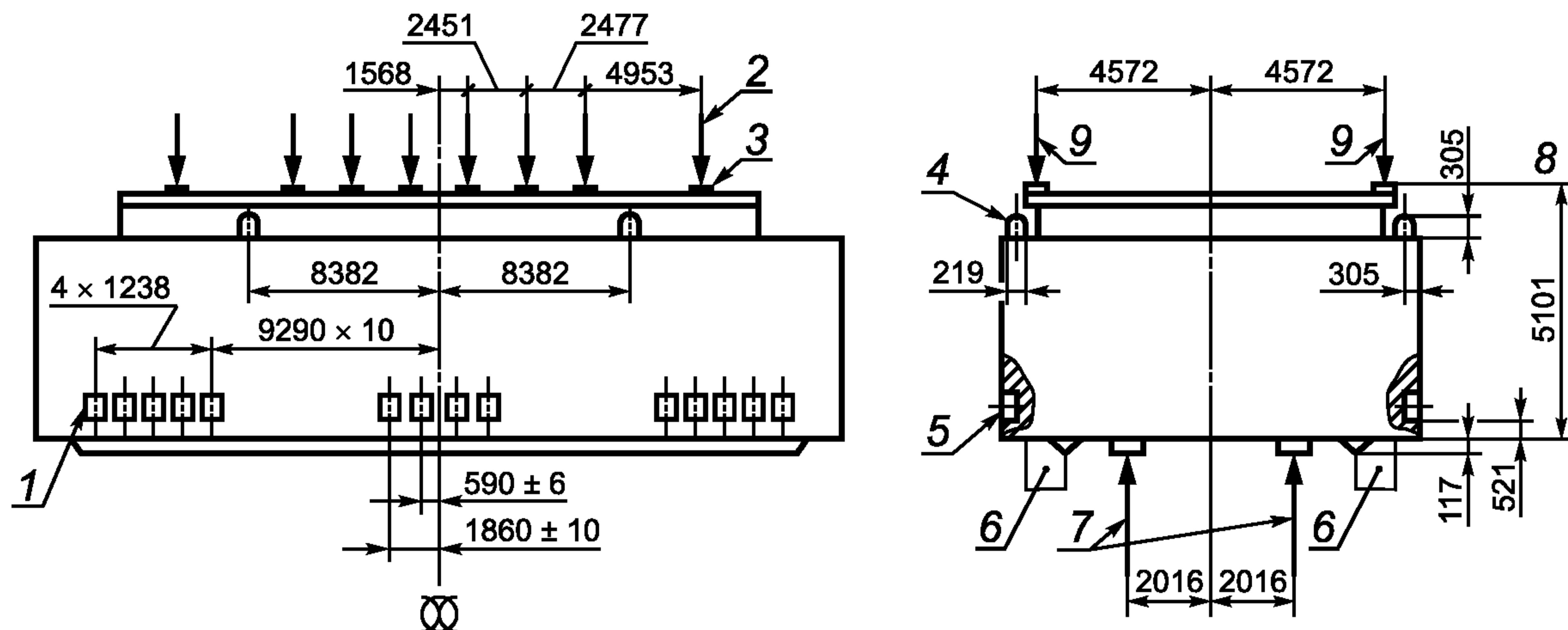
1 — бортовые гнезда; 2 — точки опоры верхних прижимных домкратов; 3 — площадь давления 915 мм<sup>2</sup>; 4 — установочная тумба; 5 — нагрузка 46 т на каждое гнездо; 6 — кильблоки; 7 — нагрузка 34 т на каждые 1295 мм; 8 — точки контакта прижимного домкрата; 9 — нагрузка 21 т на каждую точку опоры верхнего прижимного домкрата
