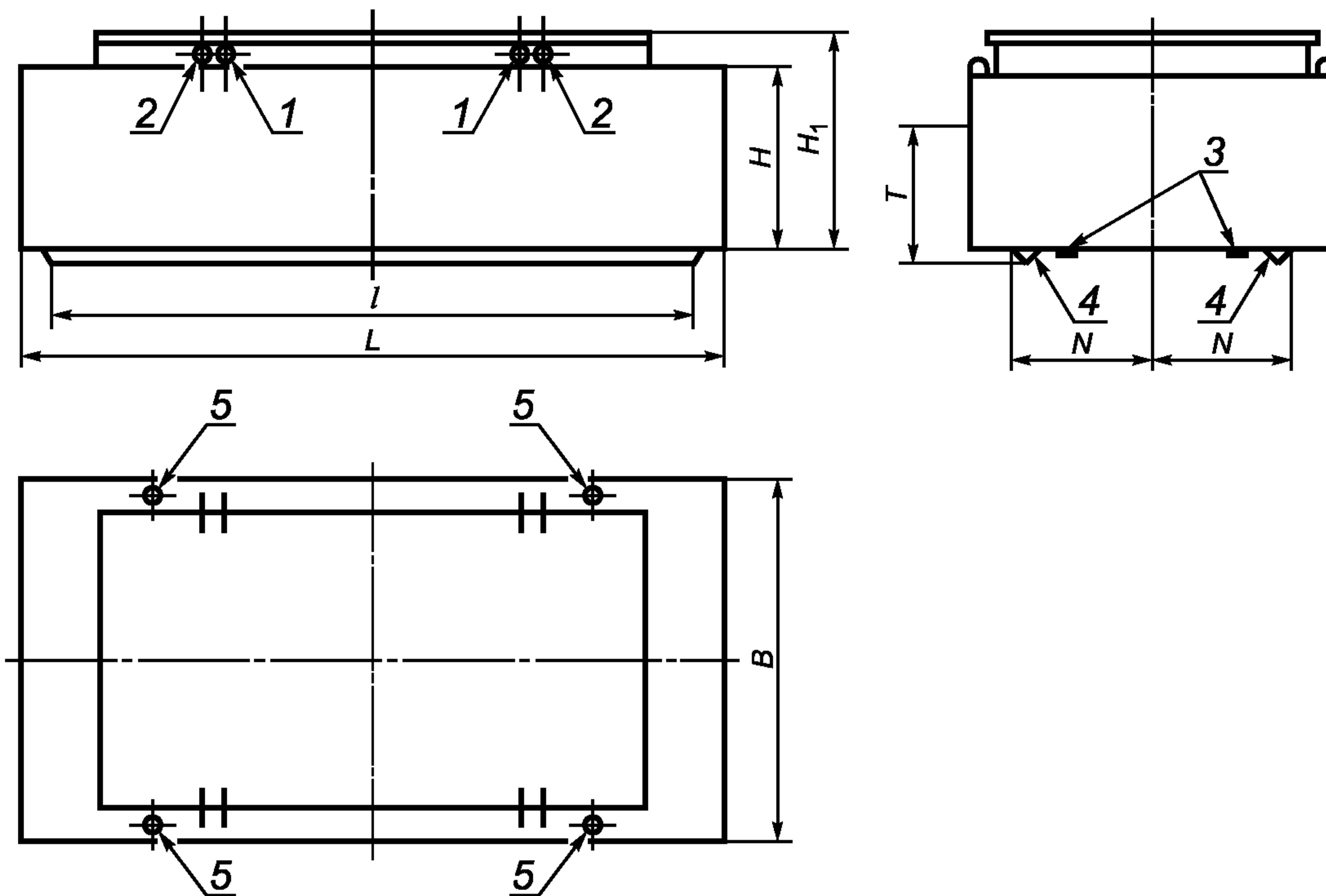
1 — места присоединения пожарных шлангов; 2 — места присоединения шлангов подачи СО<sub>2</sub>; 3 — накладные листы под док-краты; 4 — направляющий угольник размерами 150 × 150 × 12 мм; 5 — установочные тумбы
