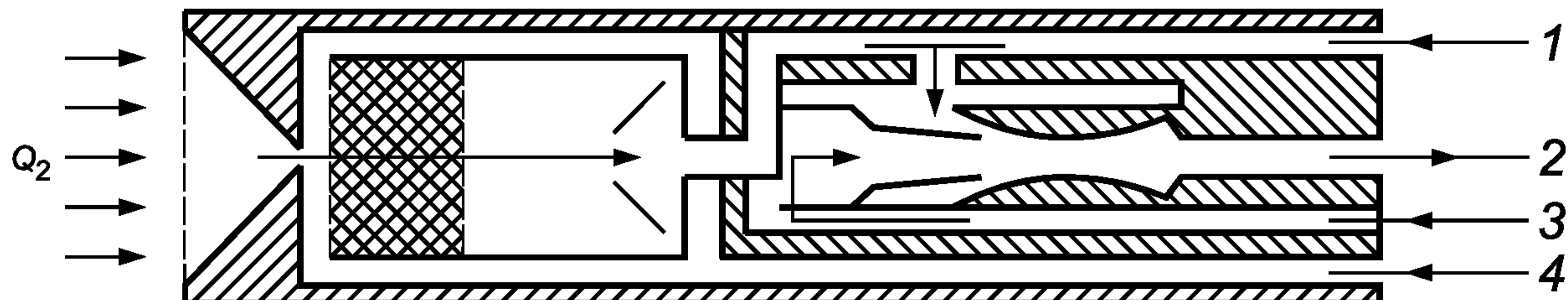
1 — область пониженного давления зонда;  $Q_2$  — расход разбавляемого газа/ пробы ( $Q_2$ ); 2 — расход разбавленной пробы ( $Q_1 + Q_2$ ); 3 — расход газа-разбавителя/воздуха ( $Q_1$ ); 4 — продувка калибровочным газом/воздухом
