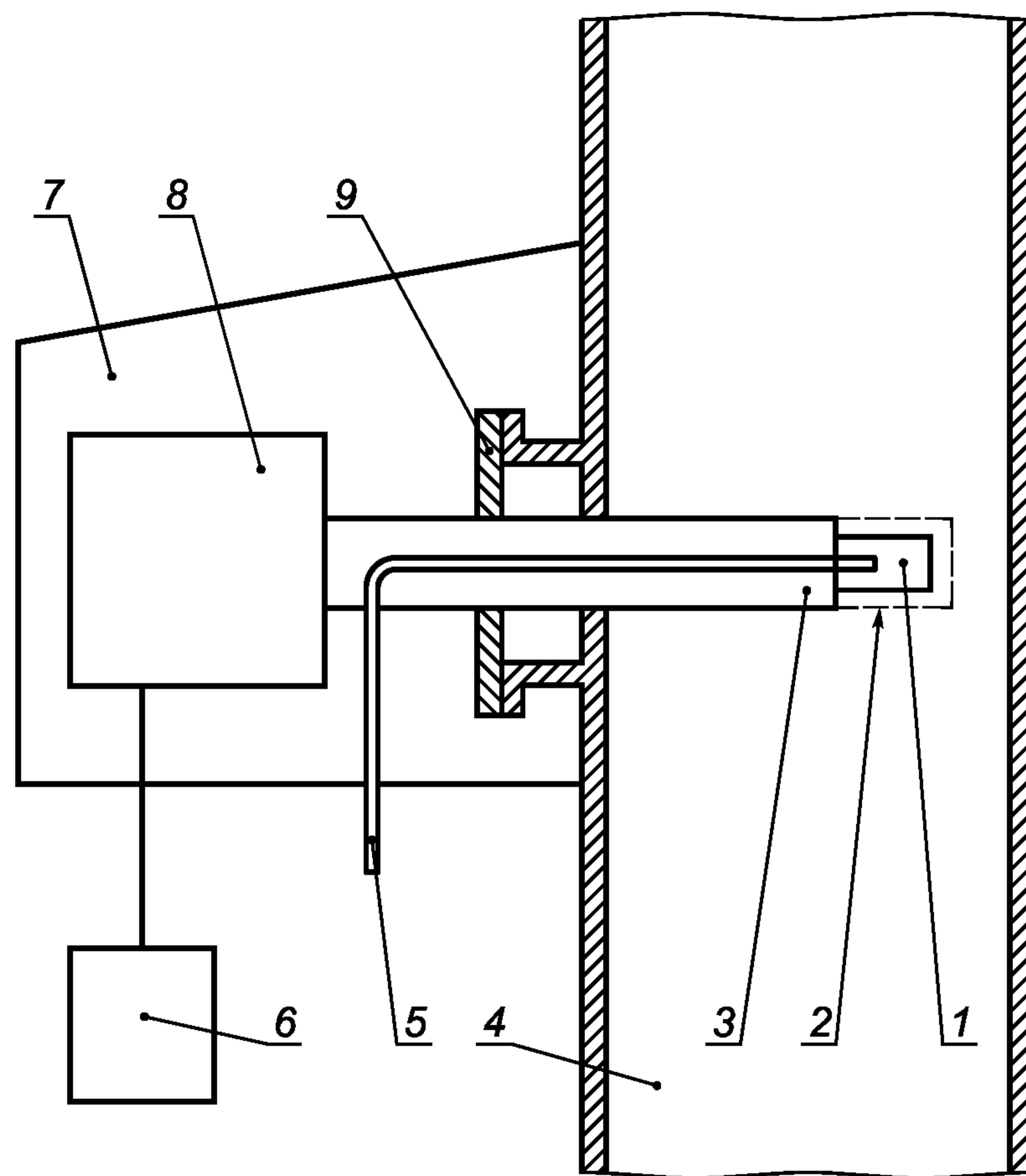
1 — измерительная ячейка; 2 — фильтр для защиты измерительной ячейки; 3 — зонд; 4 — газоход или труба; 5 — трубка для подачи калибровочного газа; 6 — блок регистрации данных; 7 — защитный кожух; 8 — приемопередающий блок; 9 — крепление зонда
