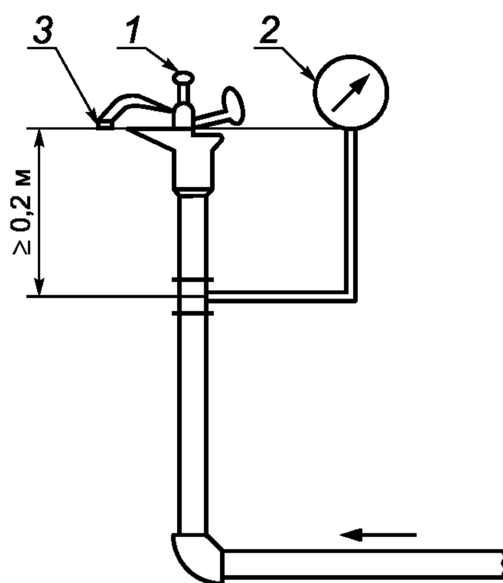
1 — испытуемый дождевальный аппарат; 2 — манометр; 3 — основная насадка
