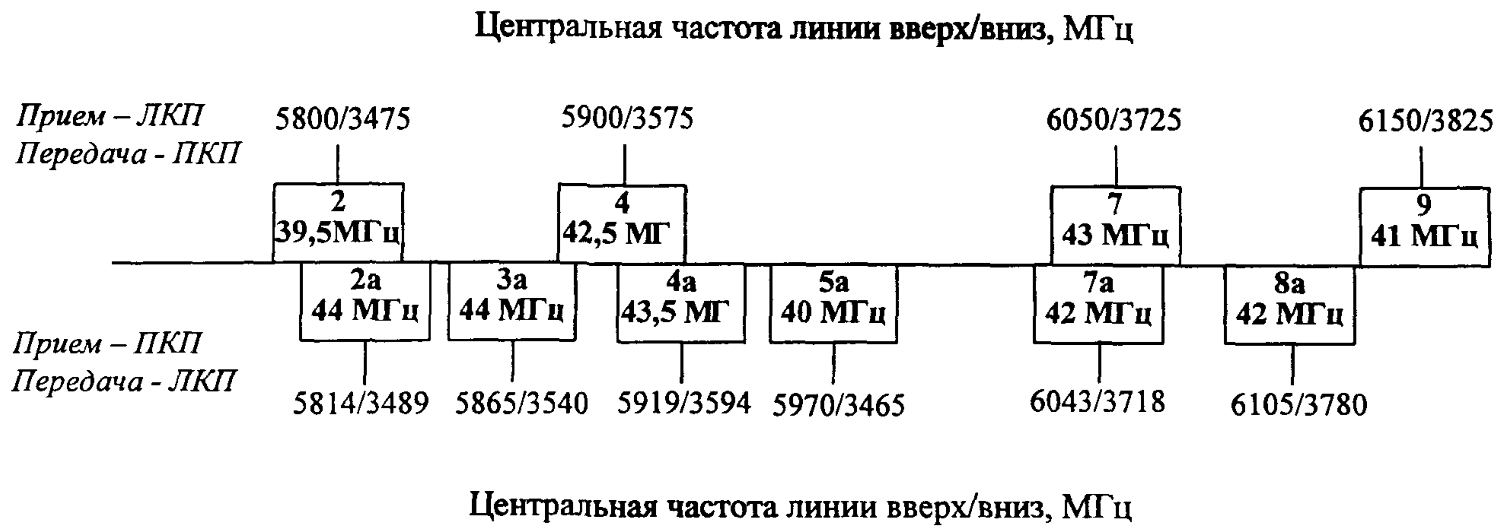
Рис. 3.6.5. Схема частотного плана стволов КА “Ямал-100” (позиция 90°в.д.)
