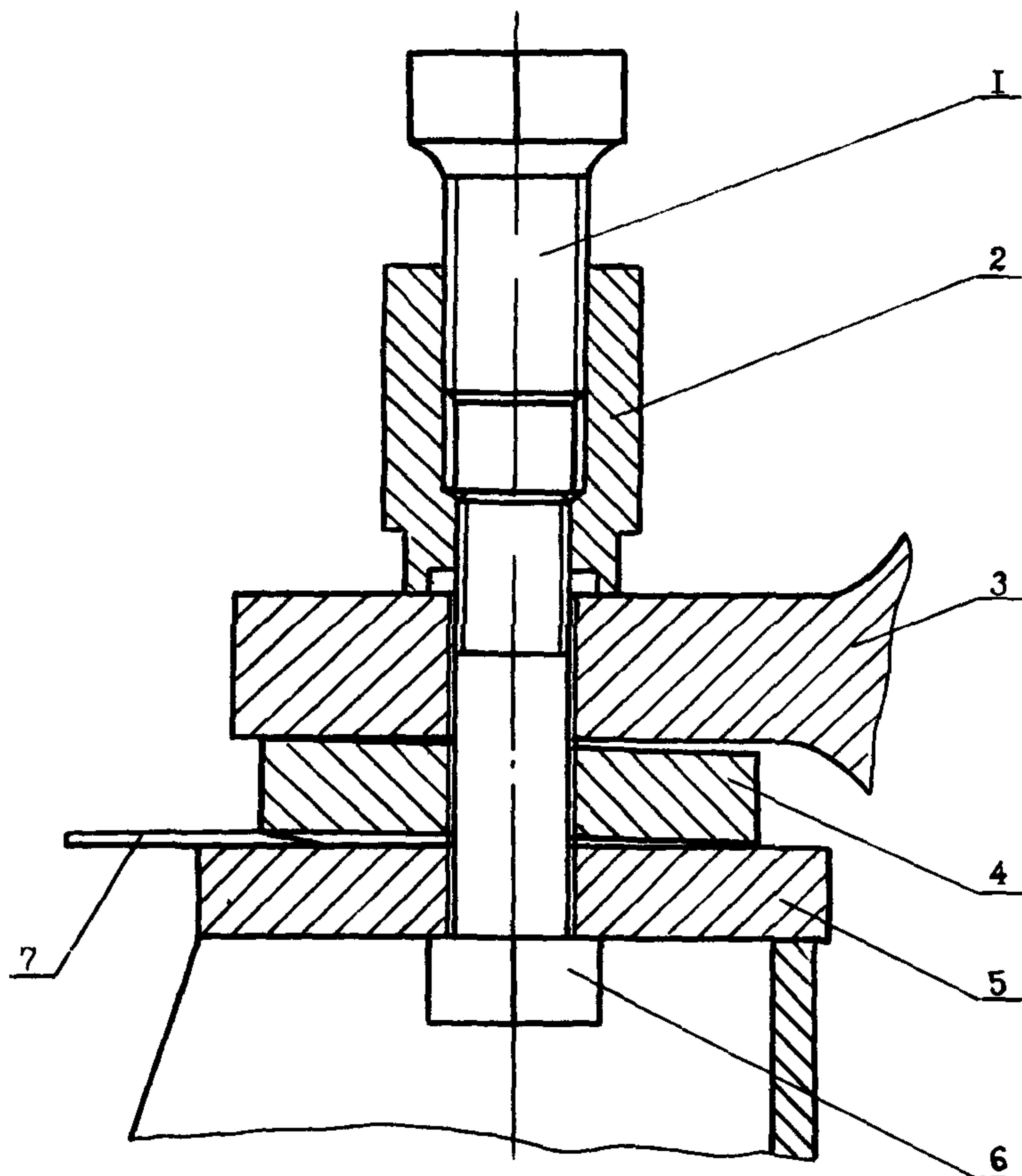
I - механизм подачи (болт); 2 - насадка; 3 - лапа механизма, 4 - подкладка; 5 - фундамент; 6 - болт;
