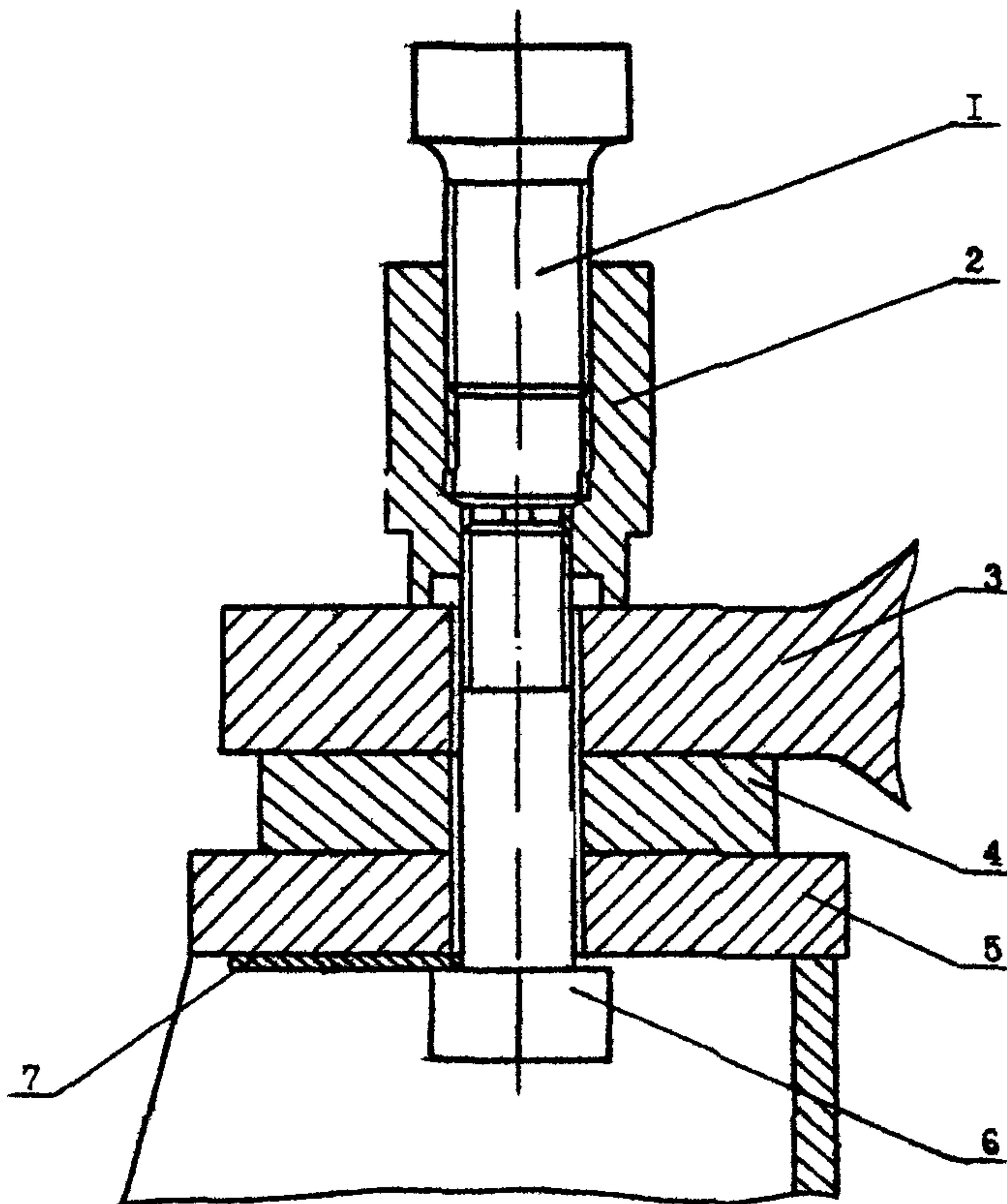
1 - механизм подачи (болт); 2 - насадка; 3 - донар механизма;
