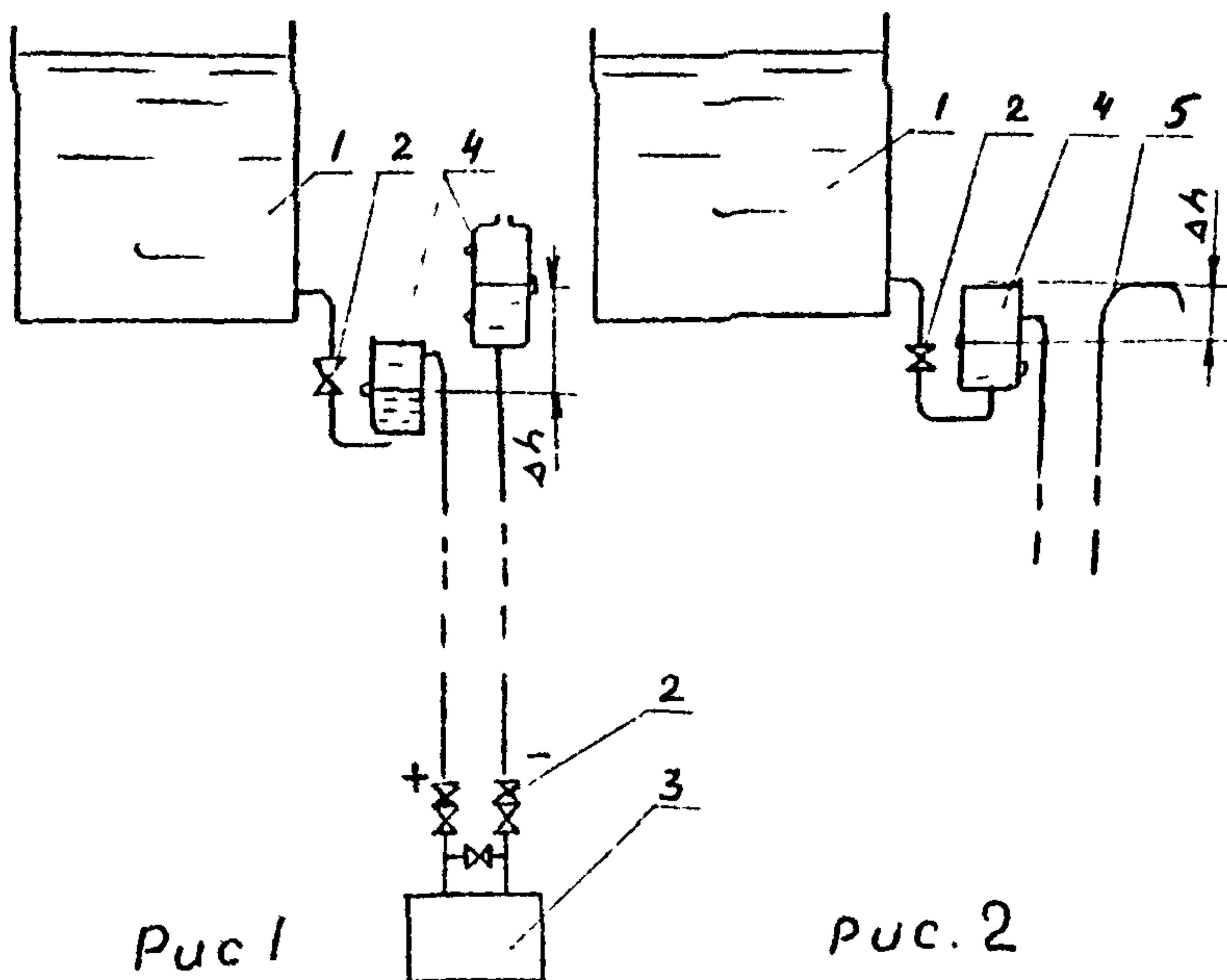
1 - резервуар, 2 - запорные клапаны, 3 - прибор,
