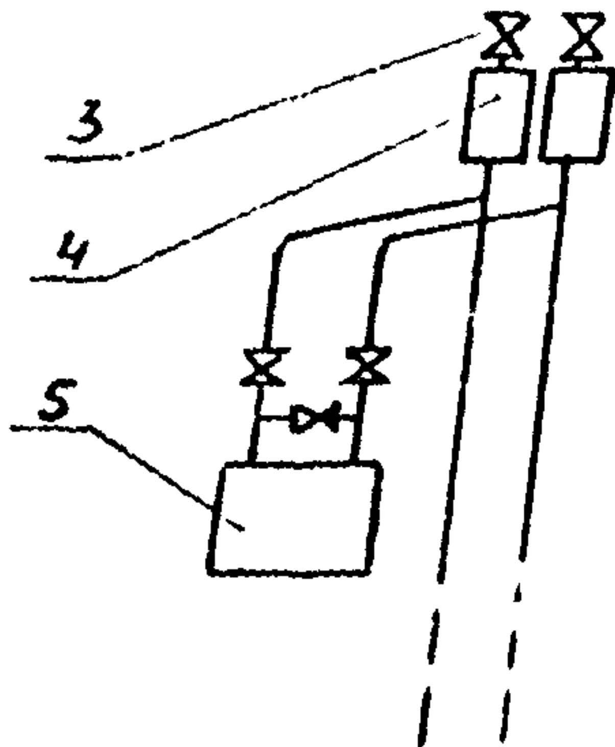
Рис. 2 Отборное устройство на вертикальном трубопроводе
