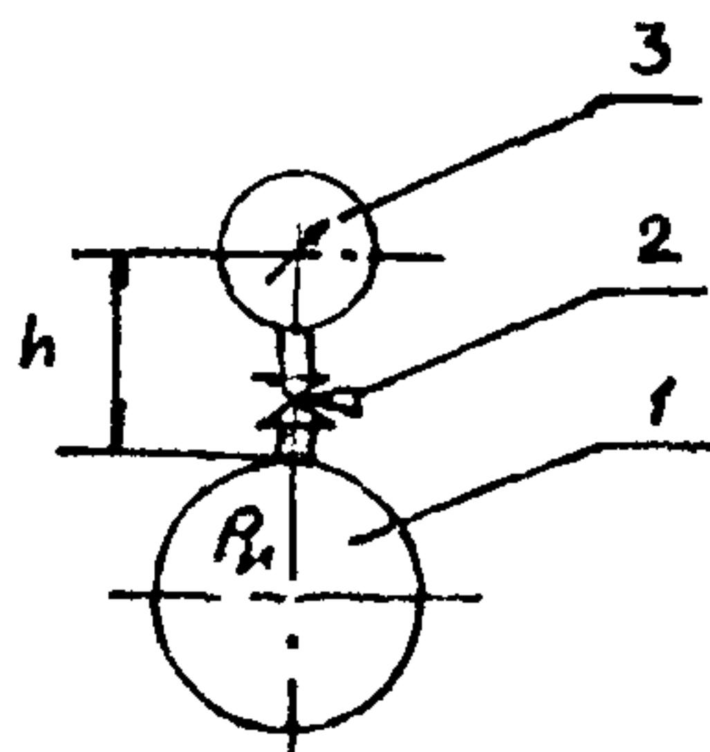
1 - объект измерения, 2 - запорный клапан, 3 - манометр
