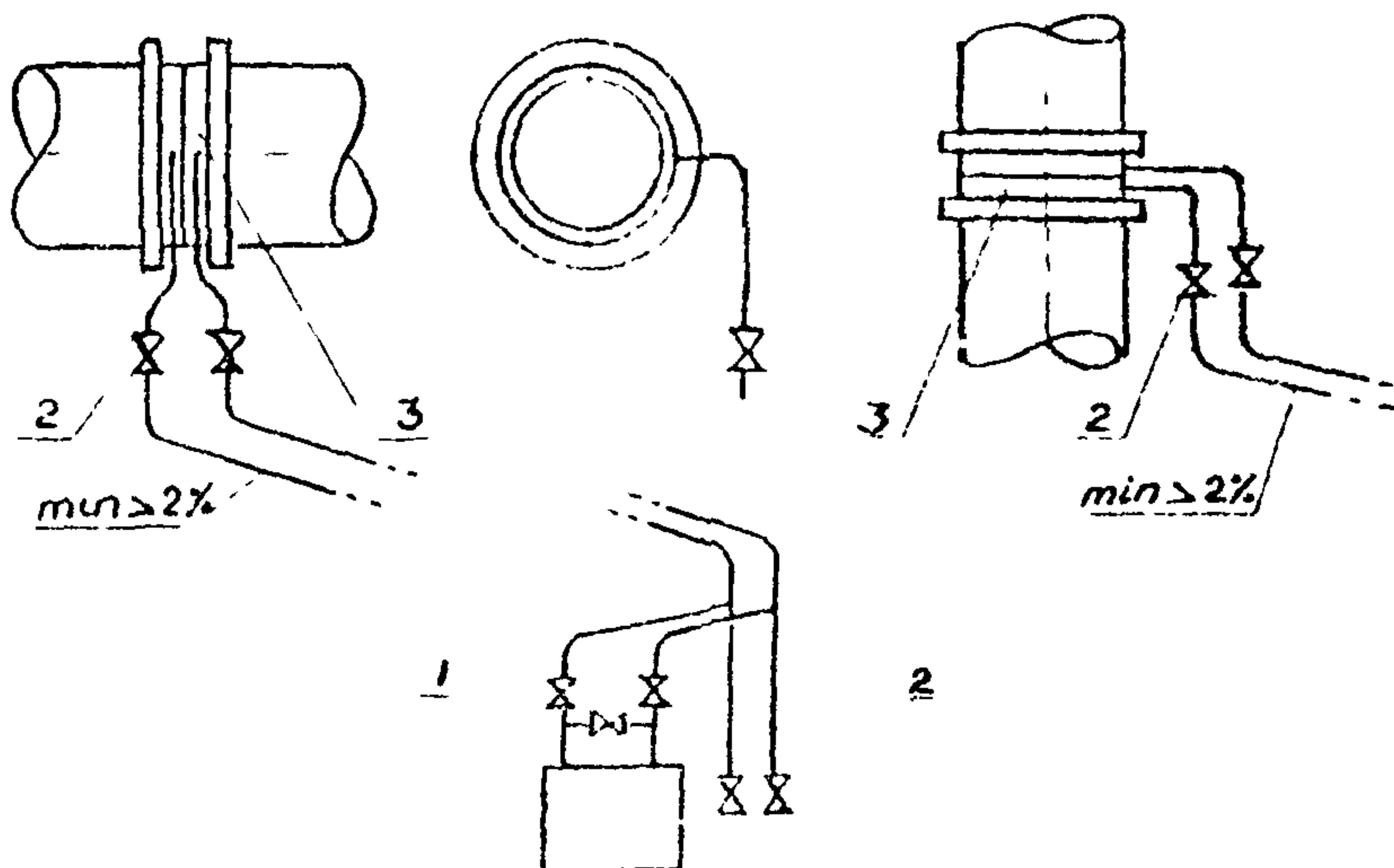
1. Прибор, 2. Запорный клапан, 3. Сужающее устройство.
