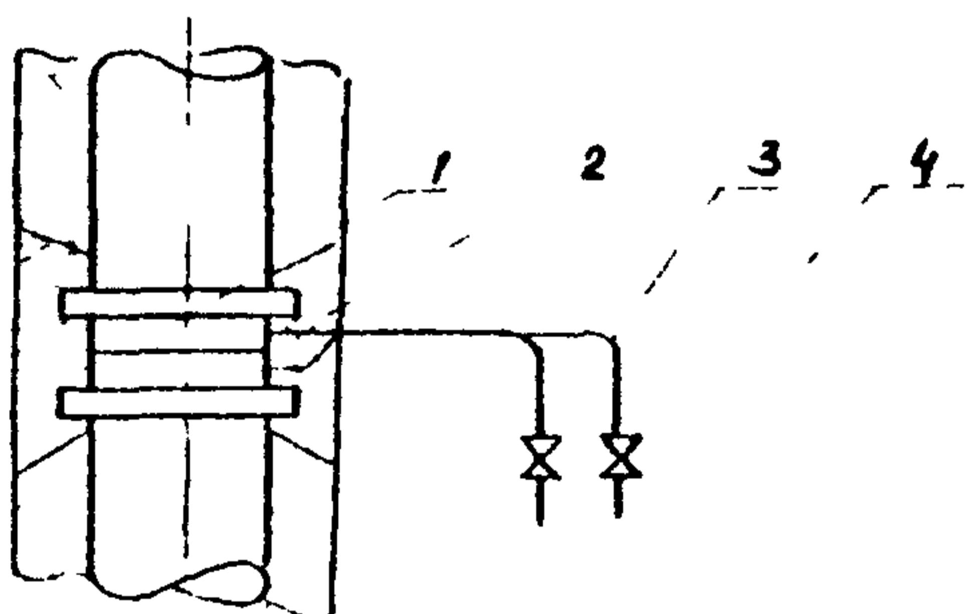
I – сужающее устройство, 2 – тепловая изоляция,
