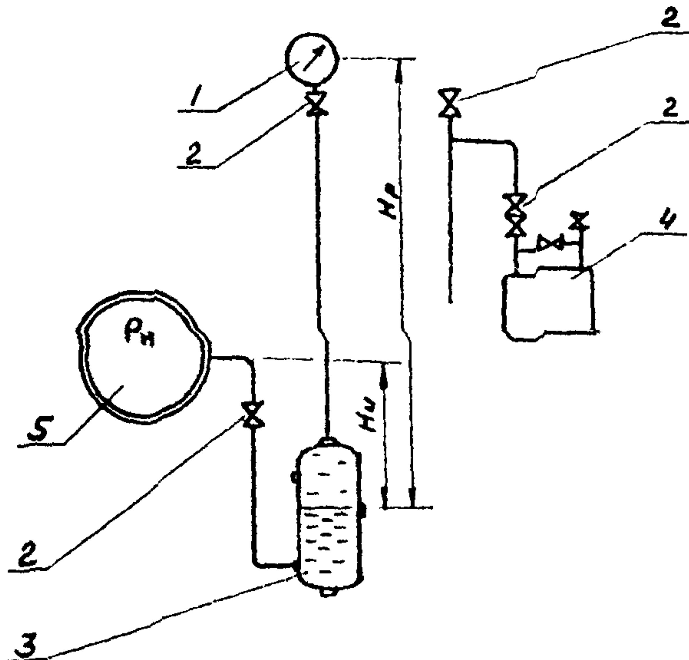
1 - объект измерения, 2 - запорный клапан, 3 - сосуд разделительный, 4 - прибор, 5 - объект измерения.
