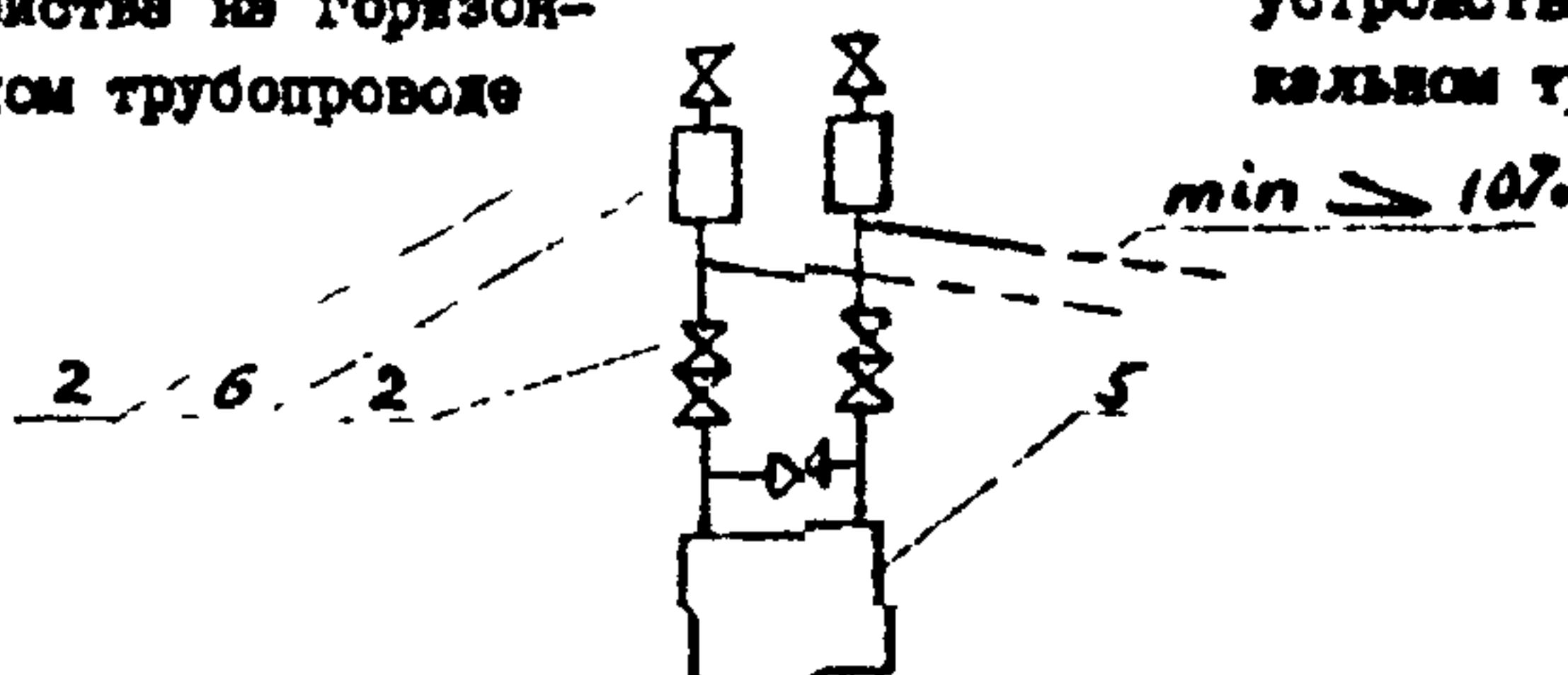
Рис. 2. Установка сужающего устройства на вертикальном трубопроводе
