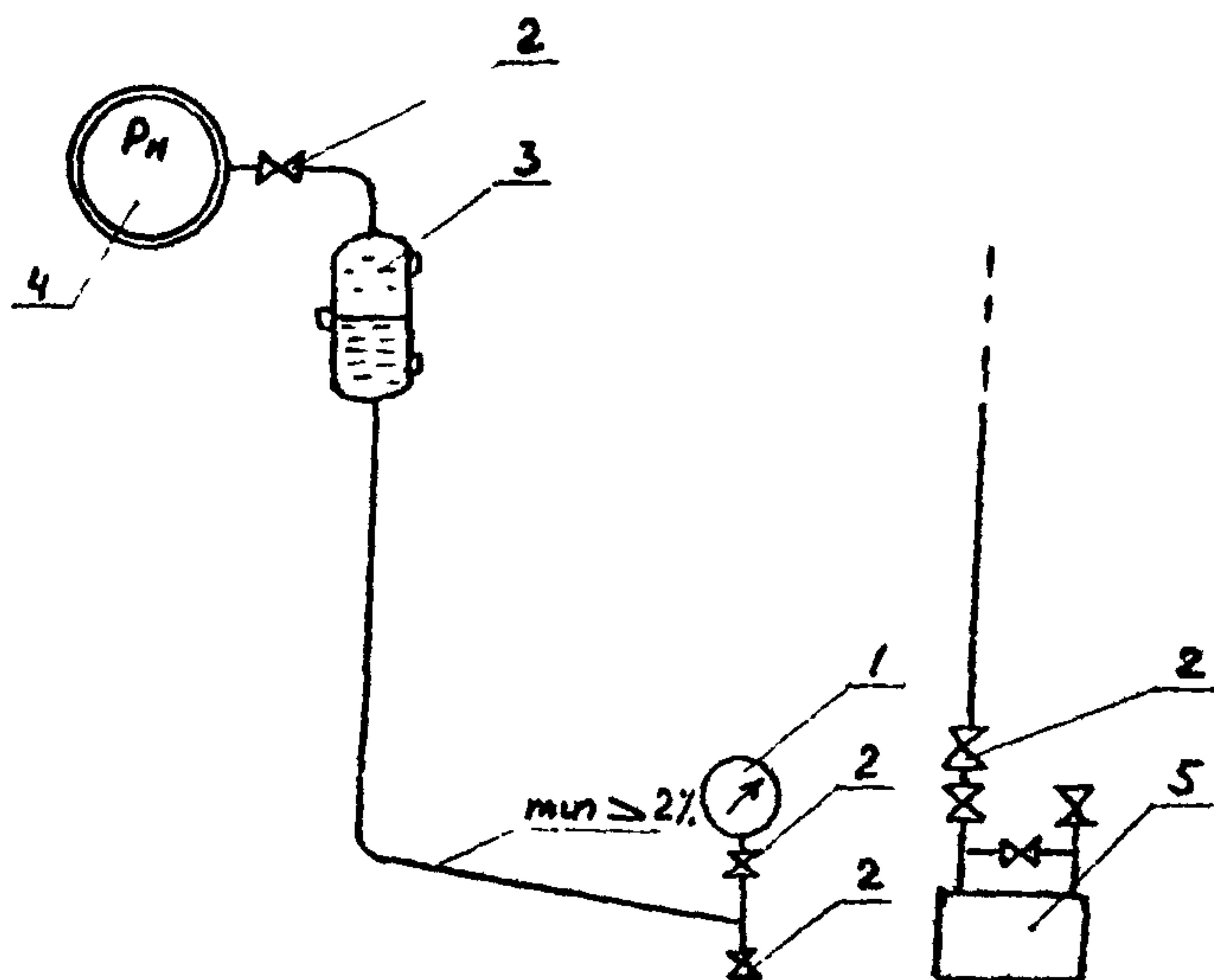
1 - манометр, 2 - запорный клапан, 3 - сосуд разделительный,
