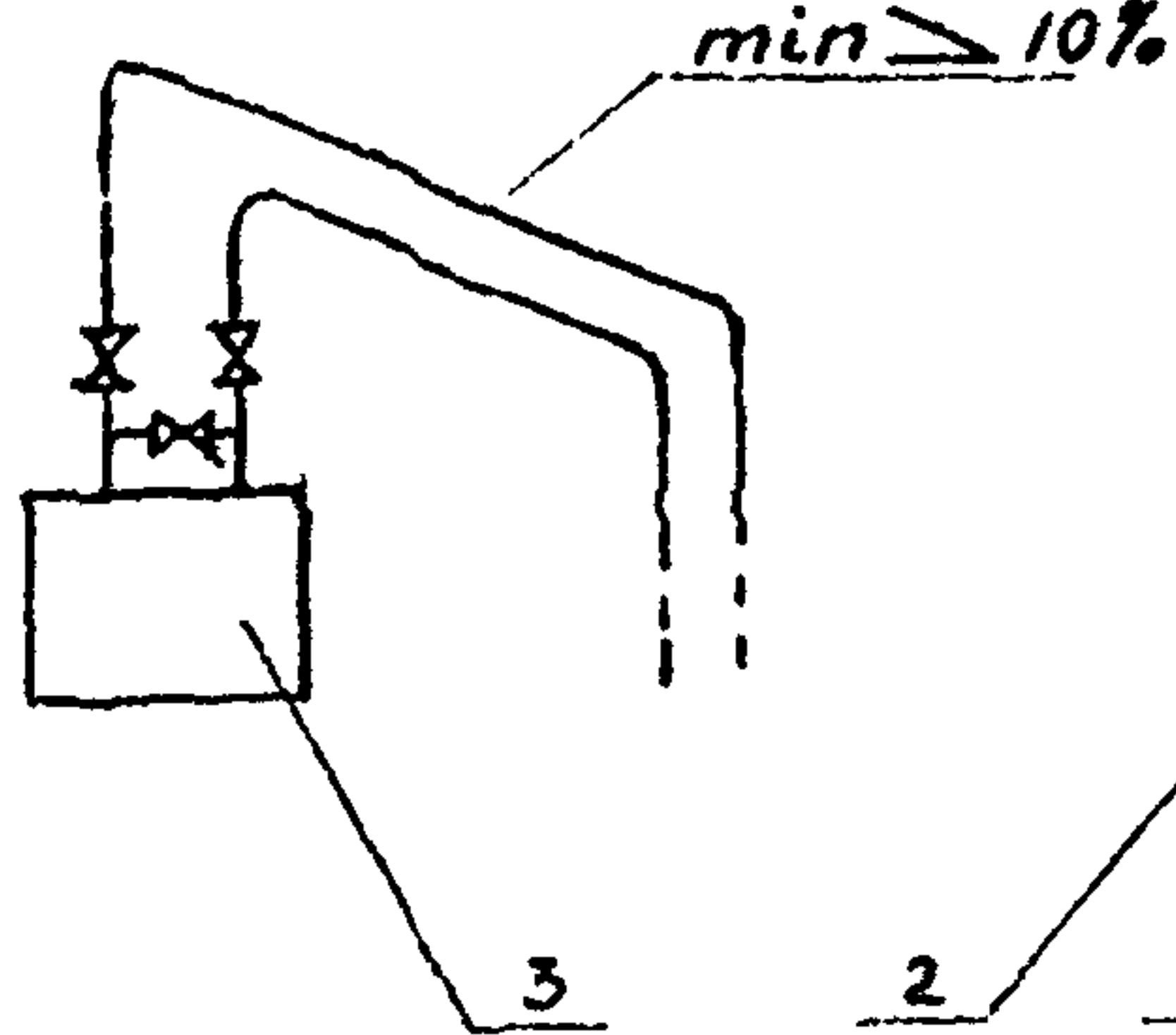
Рис. 2 Установка дифманометра ниже сужающего устройства
