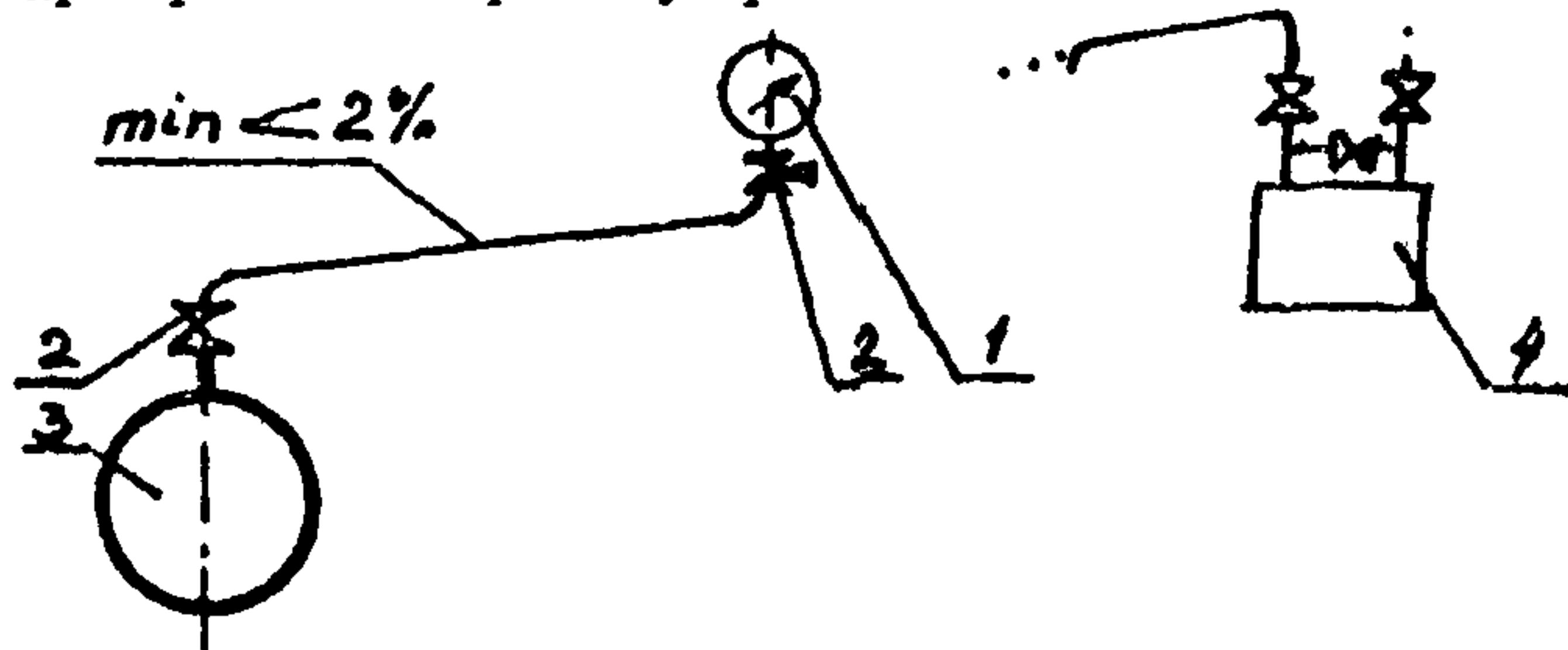
I - манометр, 2 - запорный клапан, 3 - объект измерения,
