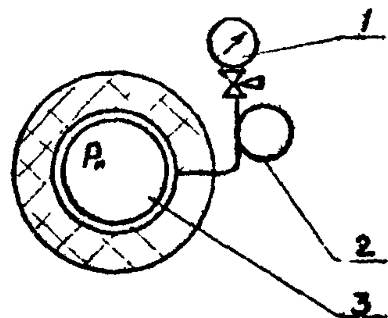
1 - манометр, 2 - отбор давления с кольцеобразной трубкой,
