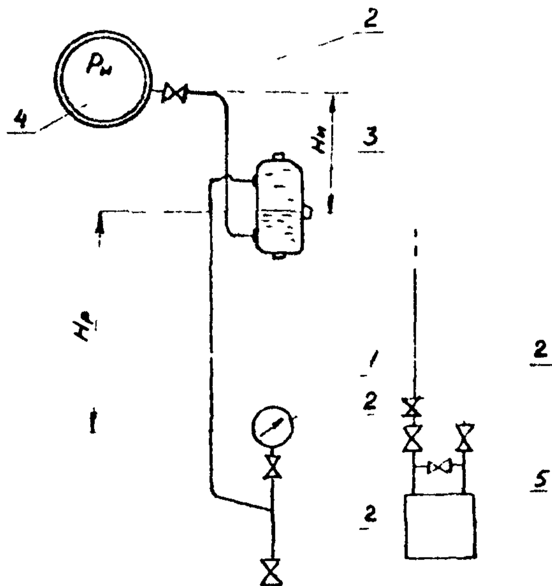
I - манометр, 2 - запорный клапан, 3 - сосуд разделительный,
