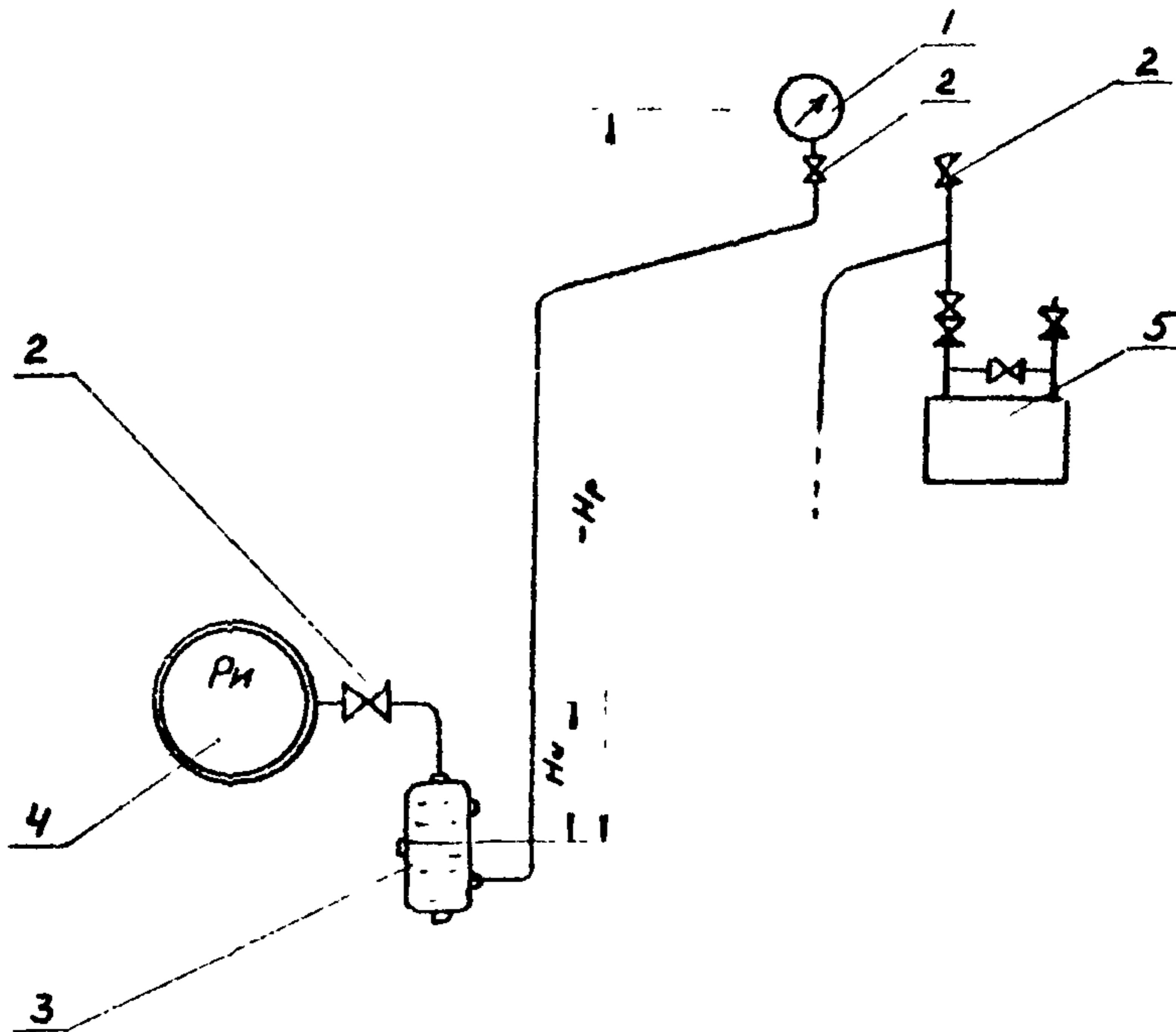
I - манометр, 2 - клапан запорный, 3 - сосуд разделительный,
