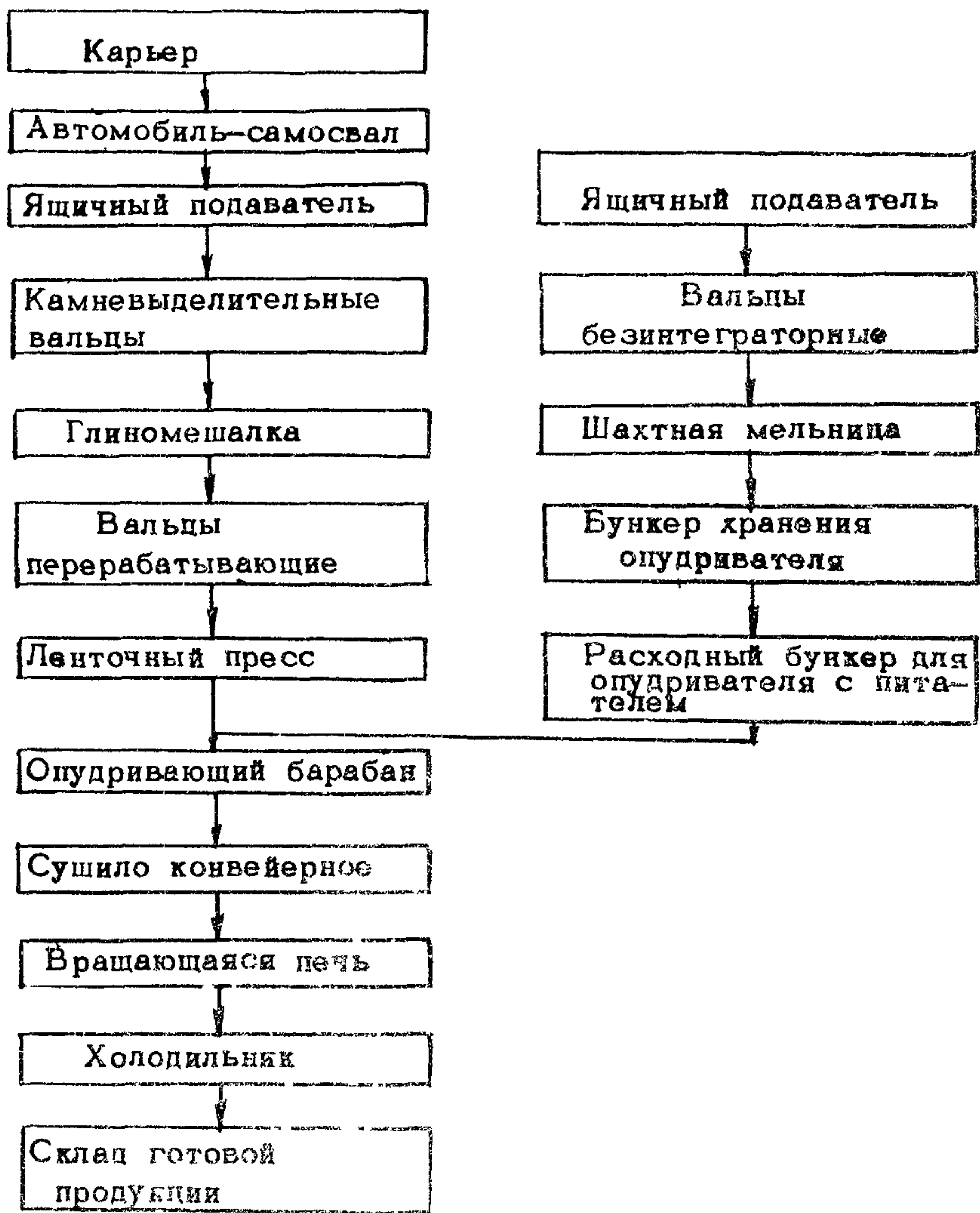
Рис.3. Схема производства керамдора с опудриванием сырьевых гранул
