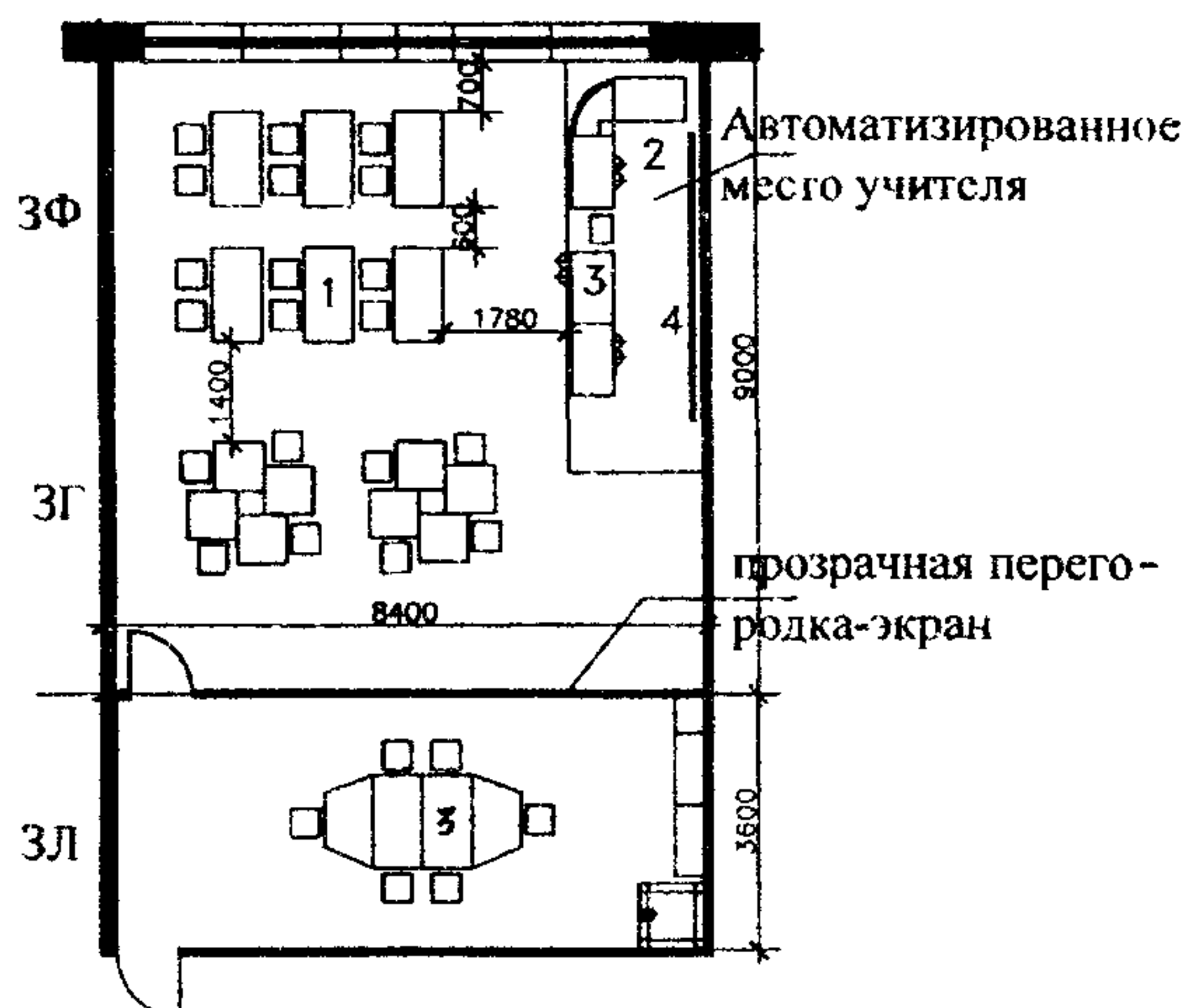
Рис. 7 Учебный кабинет специализированный с зоной лаборантской. В составе кабинета (КТ-II): Спецификация мебели и оборудования см. рис. 8
