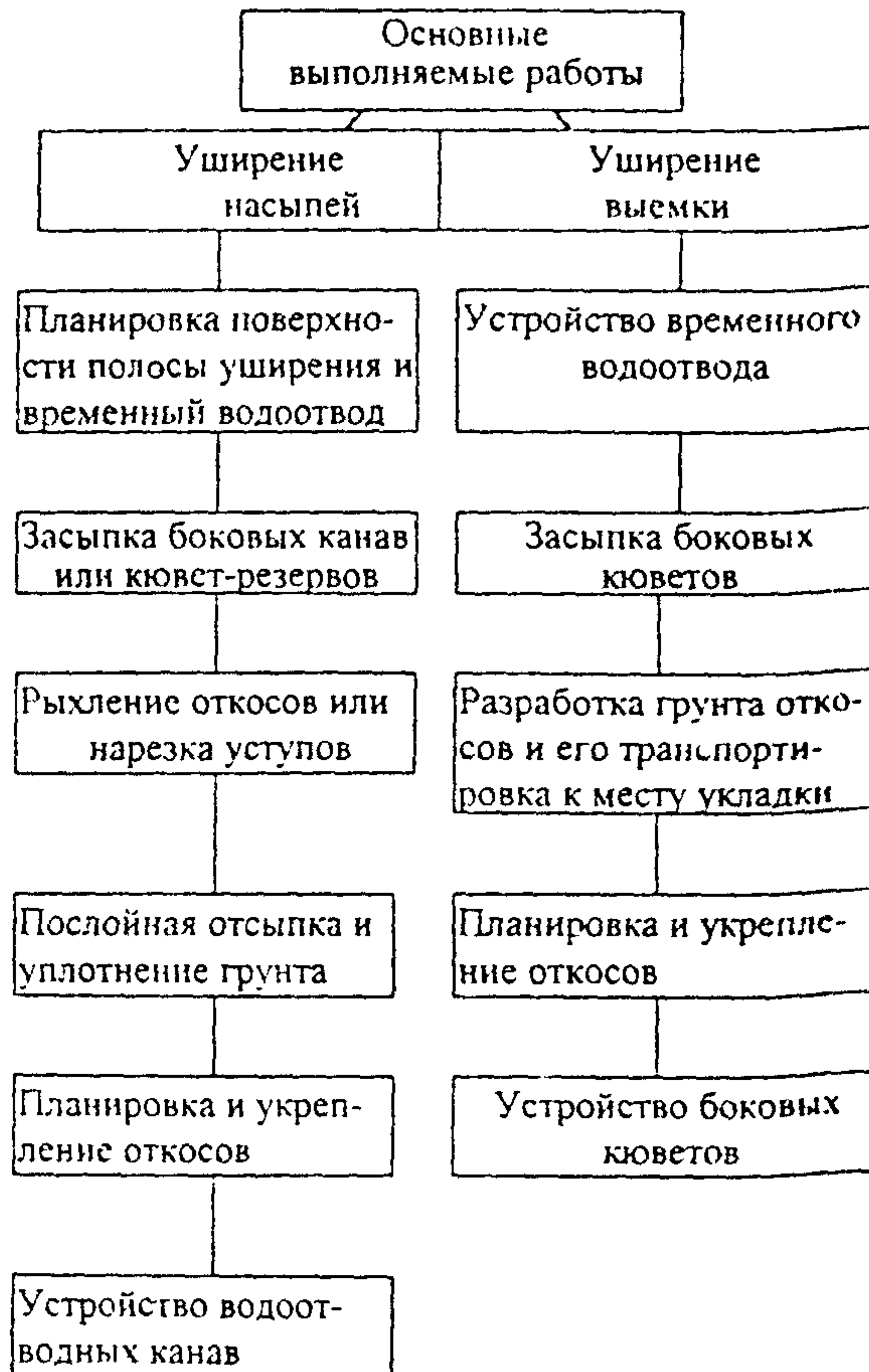
Рис 3. Последовательность работ при уширении земляного полотна
