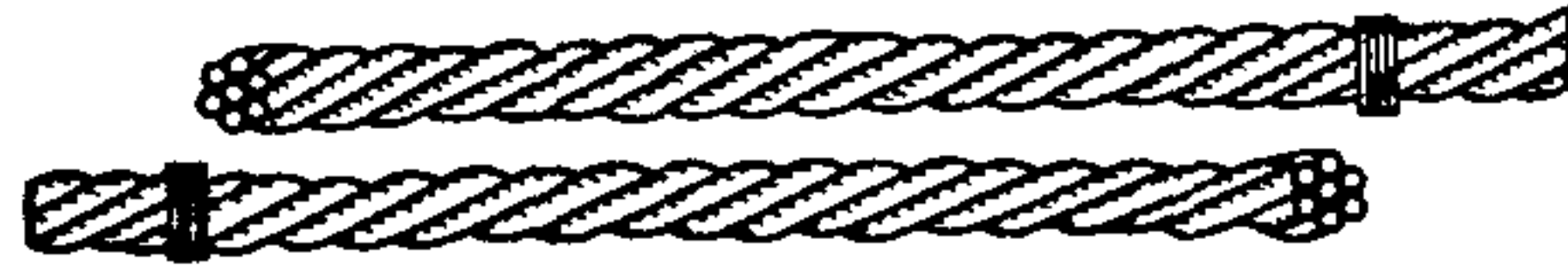
Рис. 47. Перевязка концов канатов перед счалкой
