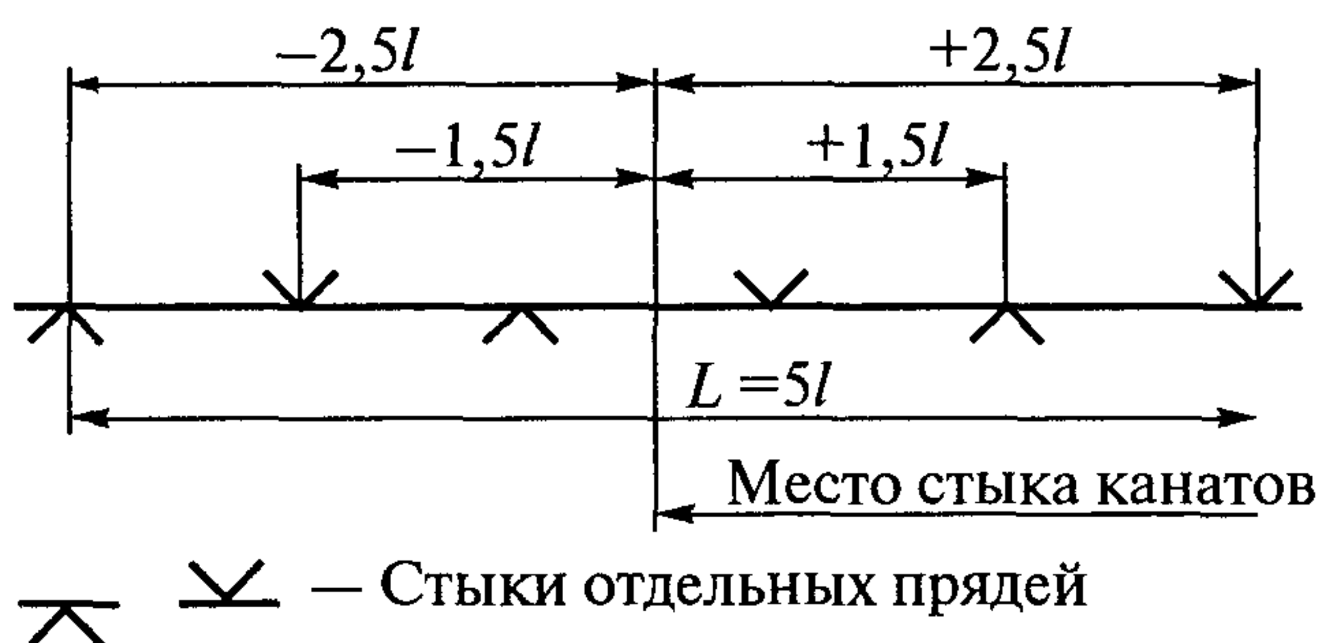
Рис. 46. Схема счалки канатов:
