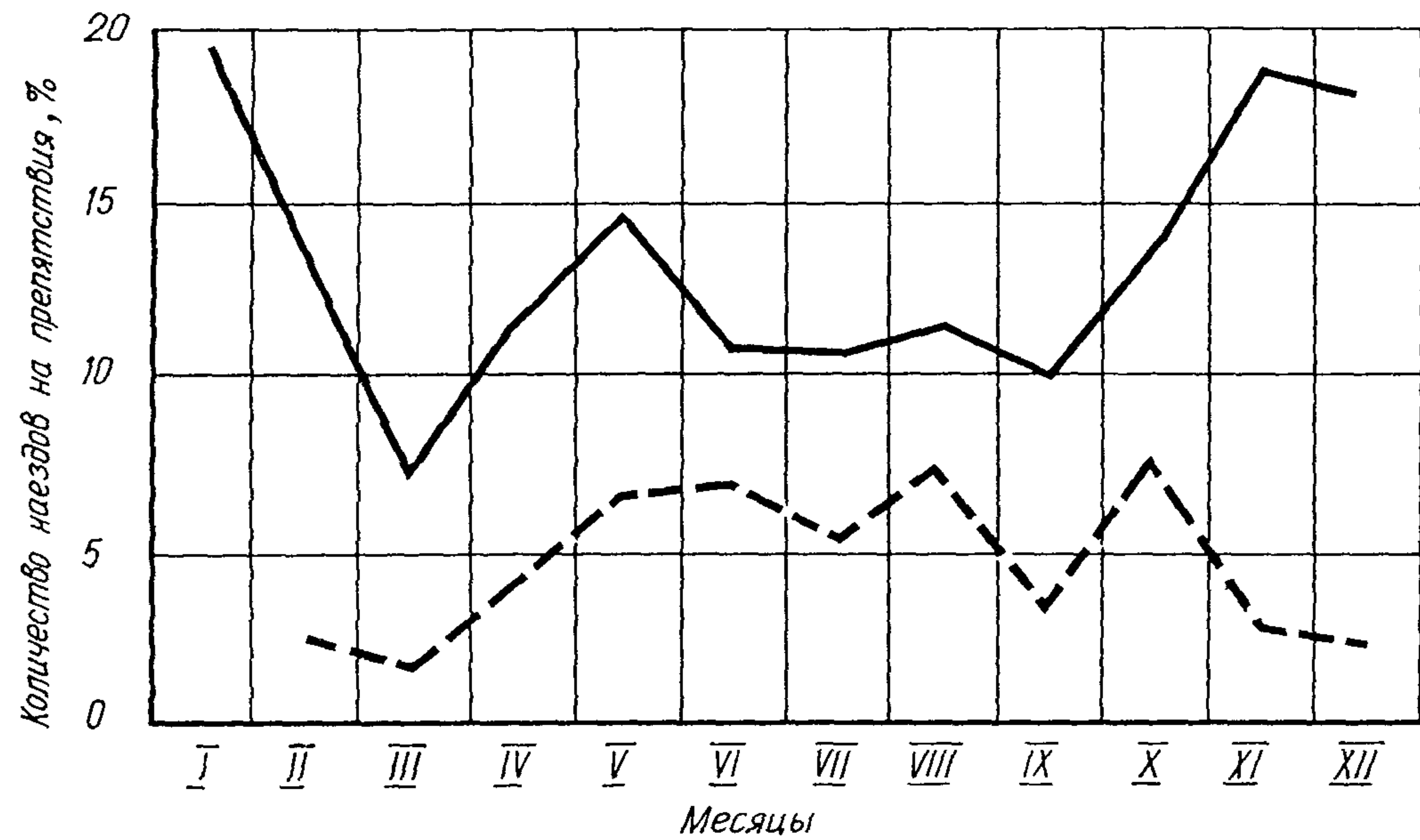
Рис. 12. Наезды на препятствия: — в течение года; — — — на сухой проезжей части
