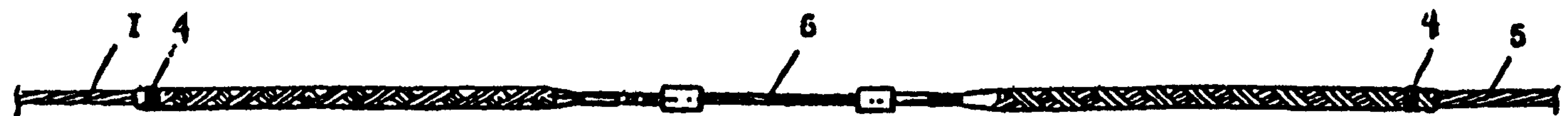
б) Соединение тягового троса с заменяемым грозотросом или тросом-лидером, а также соединение заменяемого грозотроса в петлях анкерных опор
