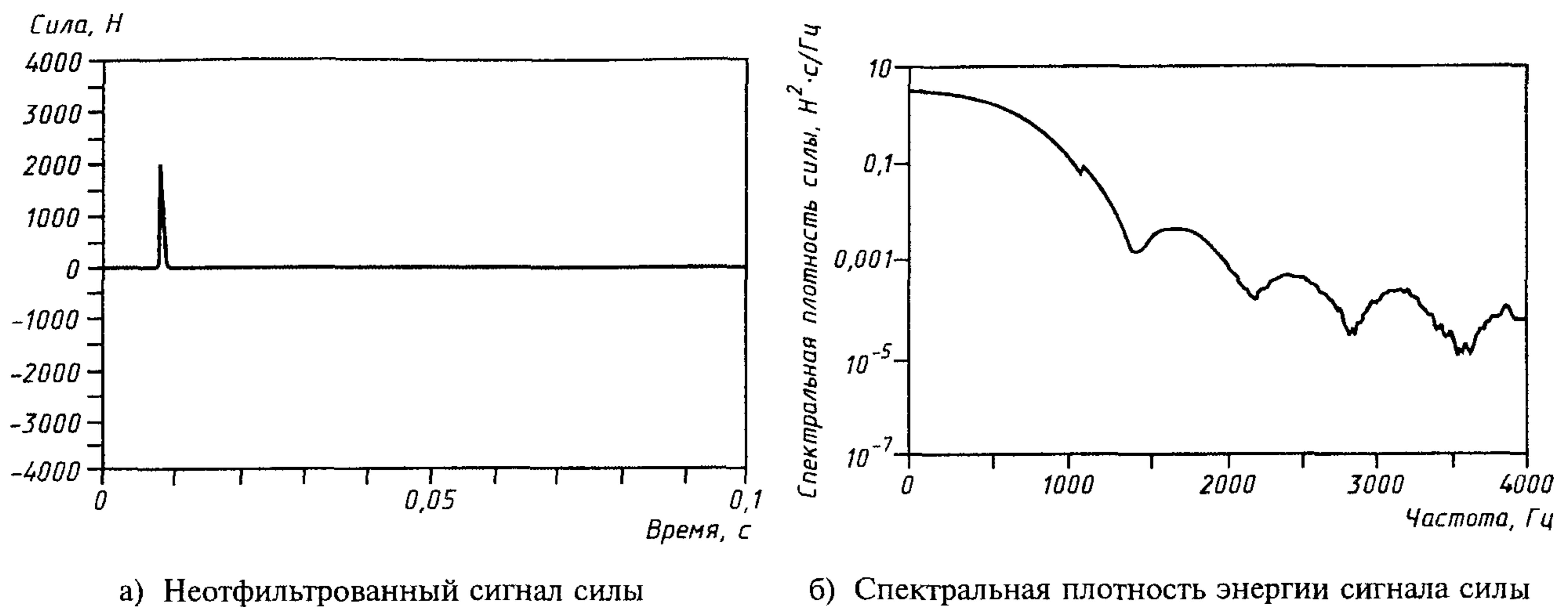
Рисунок 3 — Типичный импульс силы и его спектр
