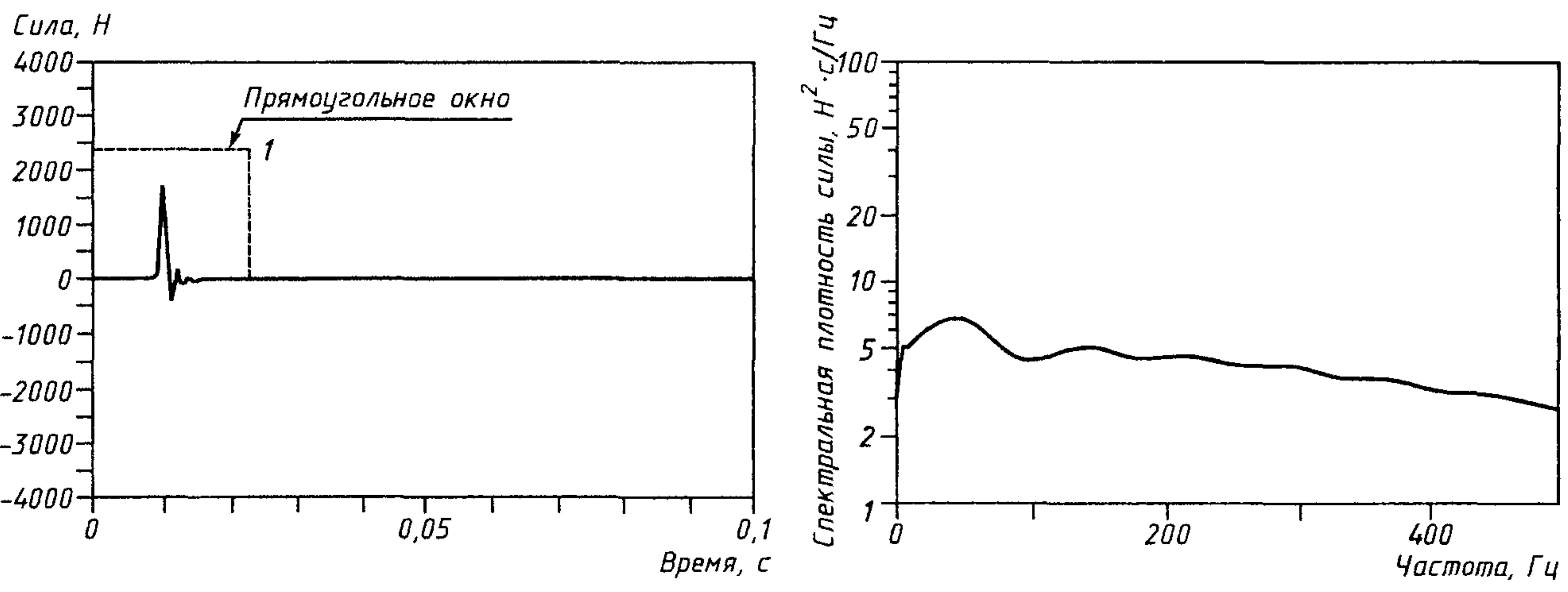
Рисунок 8 — «Просачивание», вызванное применением окна силы
