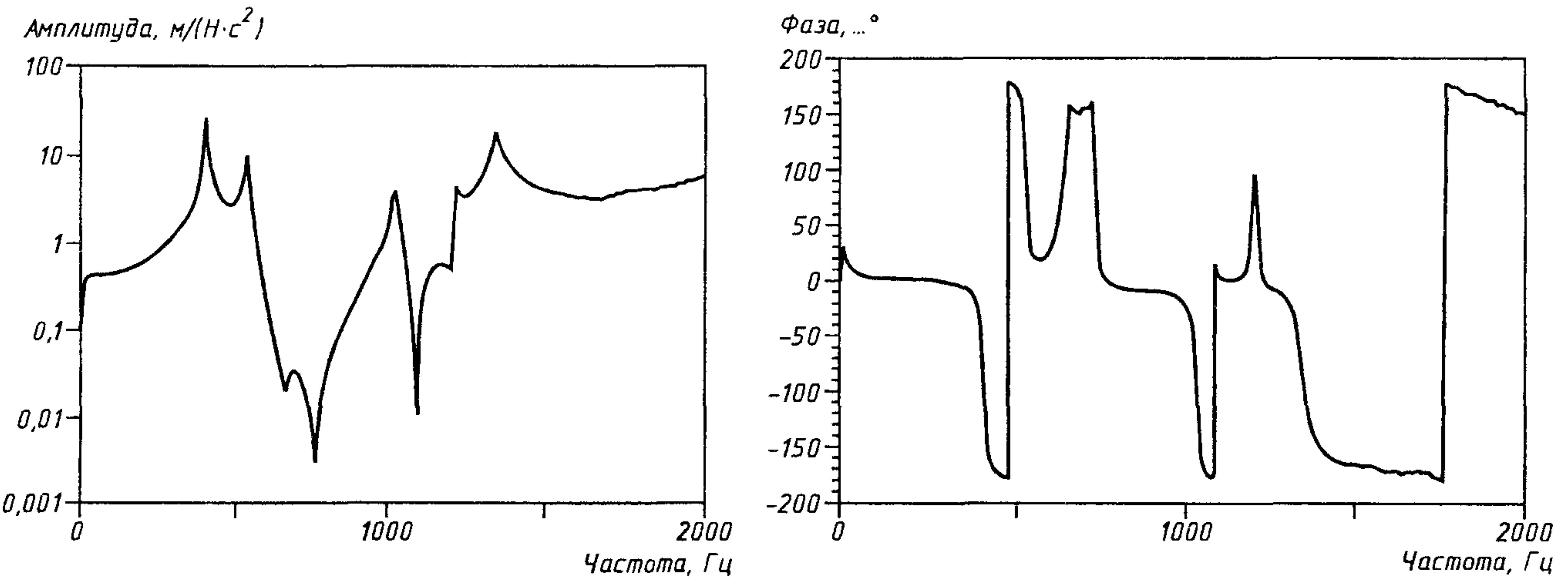
б) Ускоряемость, полученная после применения окна
