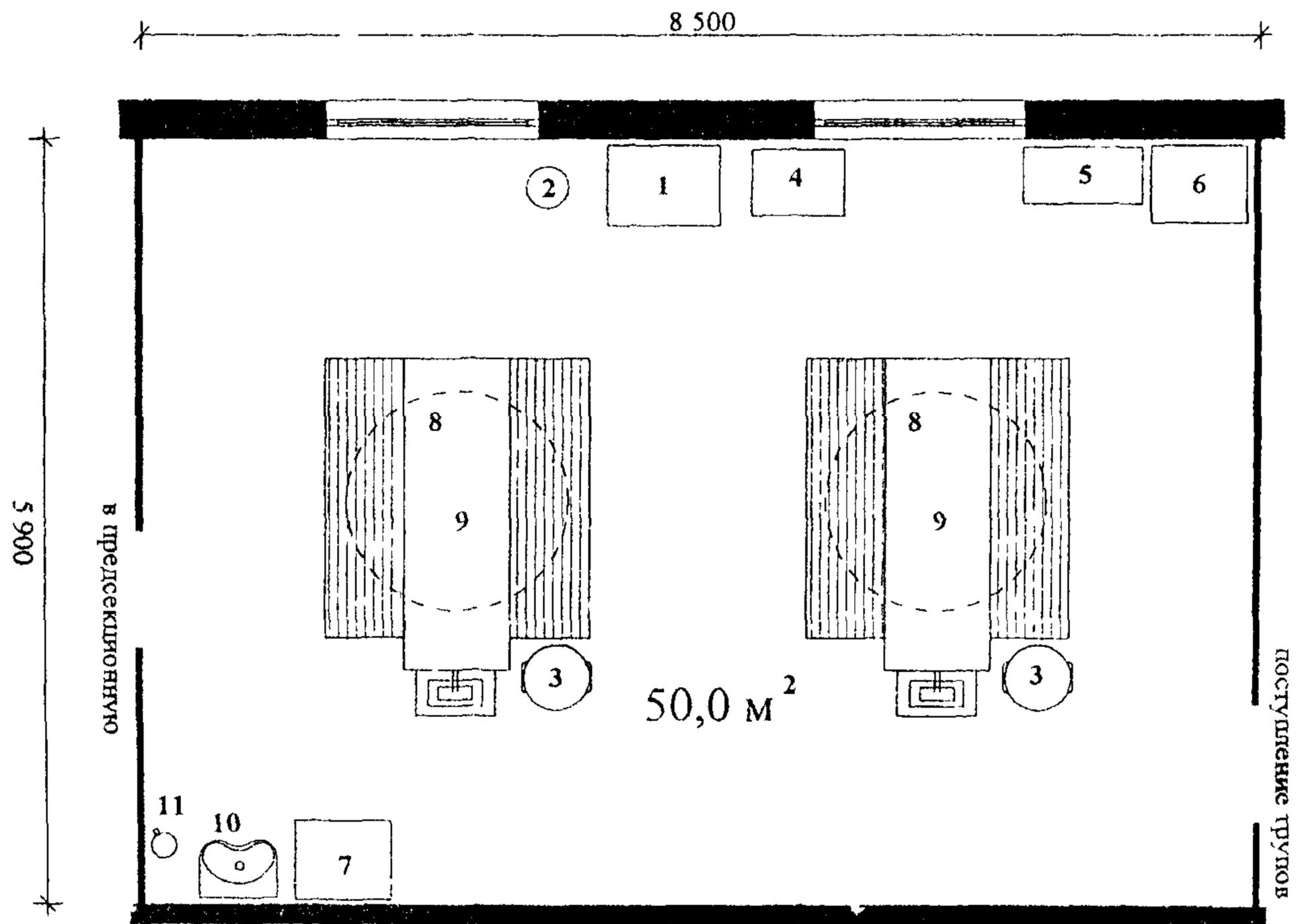
Рис. 3 1 Секционная на 2 стола
