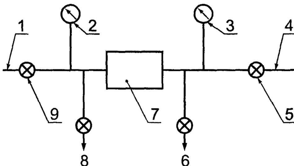
1 — источник газа 1; 2 — манометр 1; 3 — манометр 2; 4 — источник газа 2; 5 — запорный клапан 2; 6 — сливной клапан 2; 7 — газовый смеситель; 8 — сливной клапан 1; 9 — запорный клапан 1
