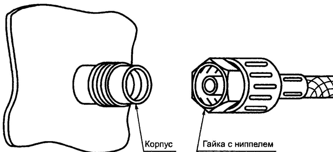
Рисунок 1 — Соединения, специфические для различных газов
