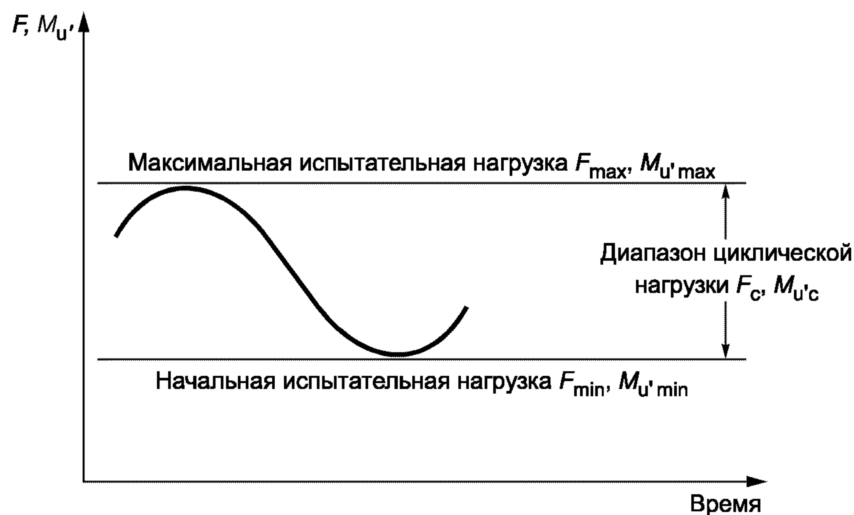
Рисунок 3 — Форма волны испытательной нагрузки
