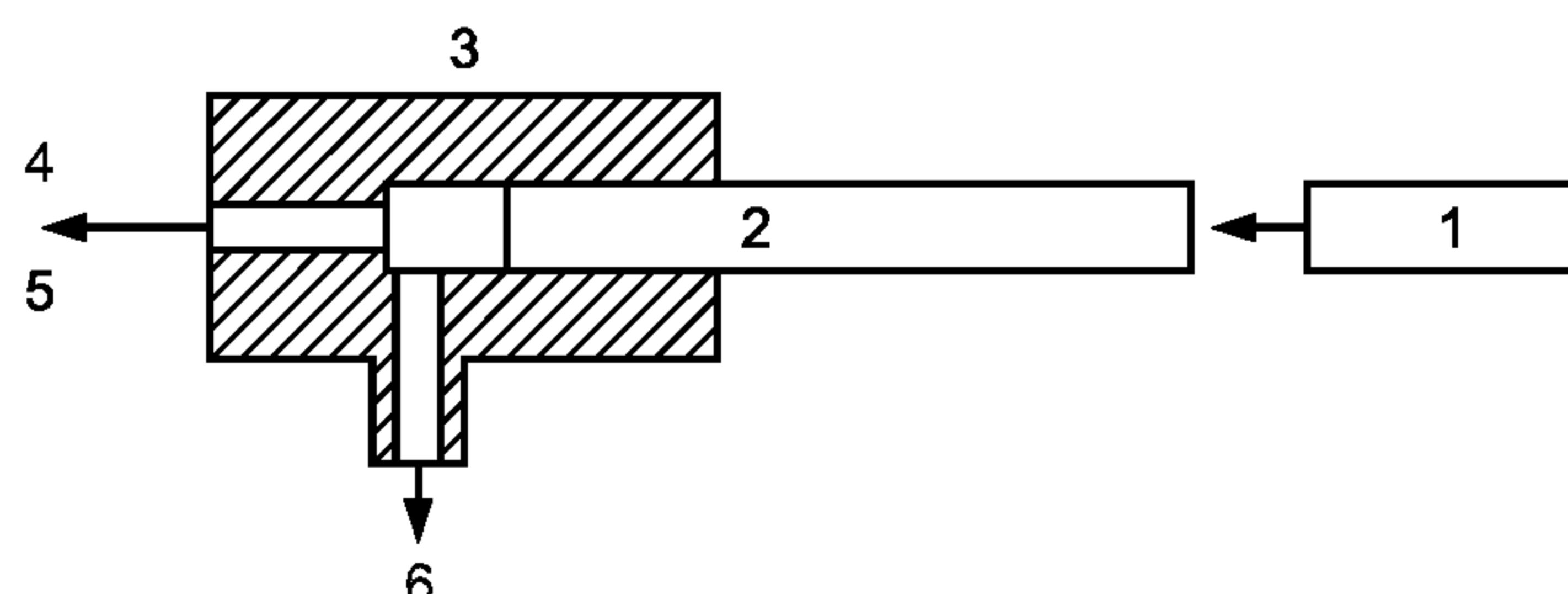
1 — атмосфера испытаний по ГОСТ ИСО 3402; 2 — сменный калибр; 3 — соединительный патрубок; 4 — объемный поток воздуха; 5 — источник всасывания ( $17,5:1:0,3 \text{ см}^3/\text{s}$ ); 6 — место присоединения преобразователя давления
