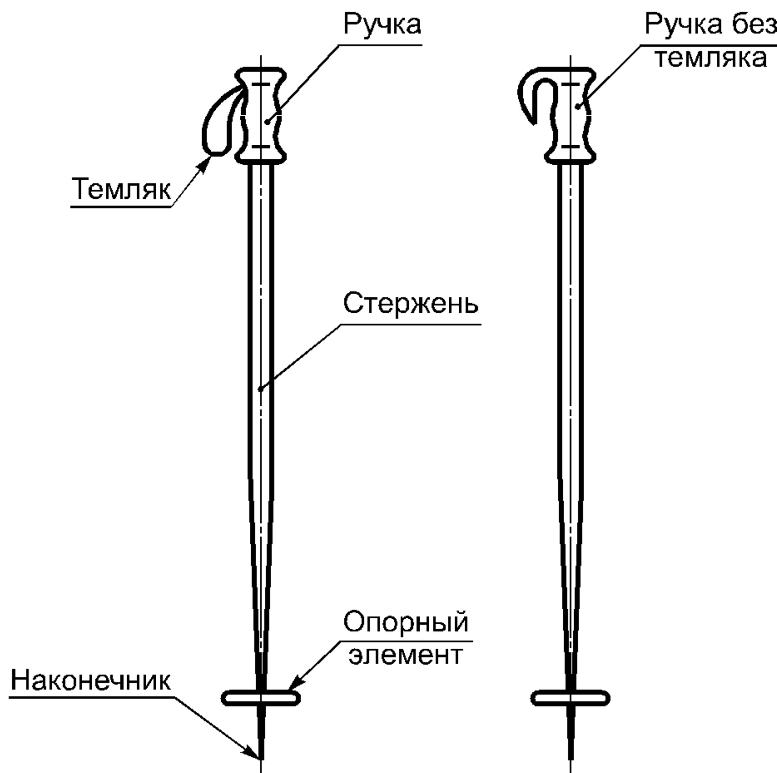
Рисунок 1 — Элементы горнолыжной палки и термины
