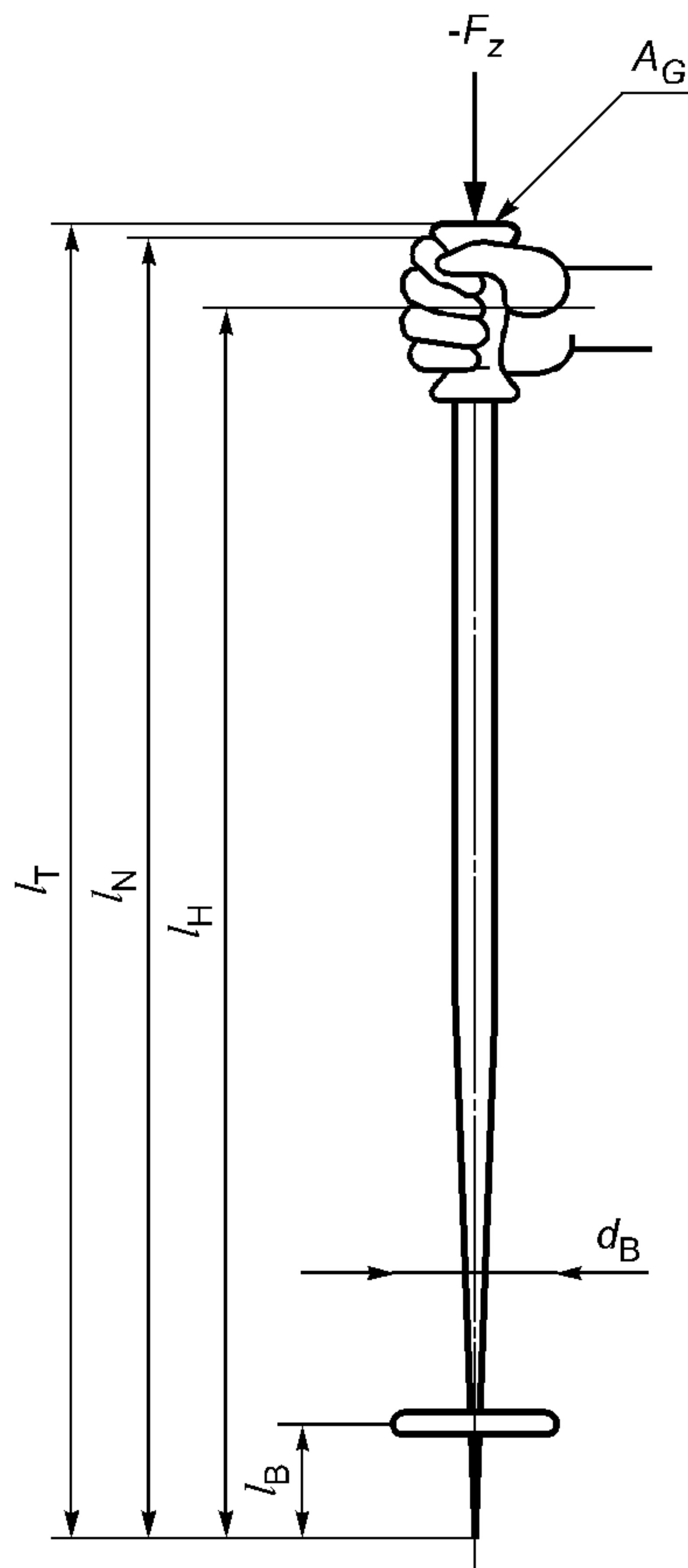
Рисунок 2 — Условное обозначение размеров горнолыжной палки
