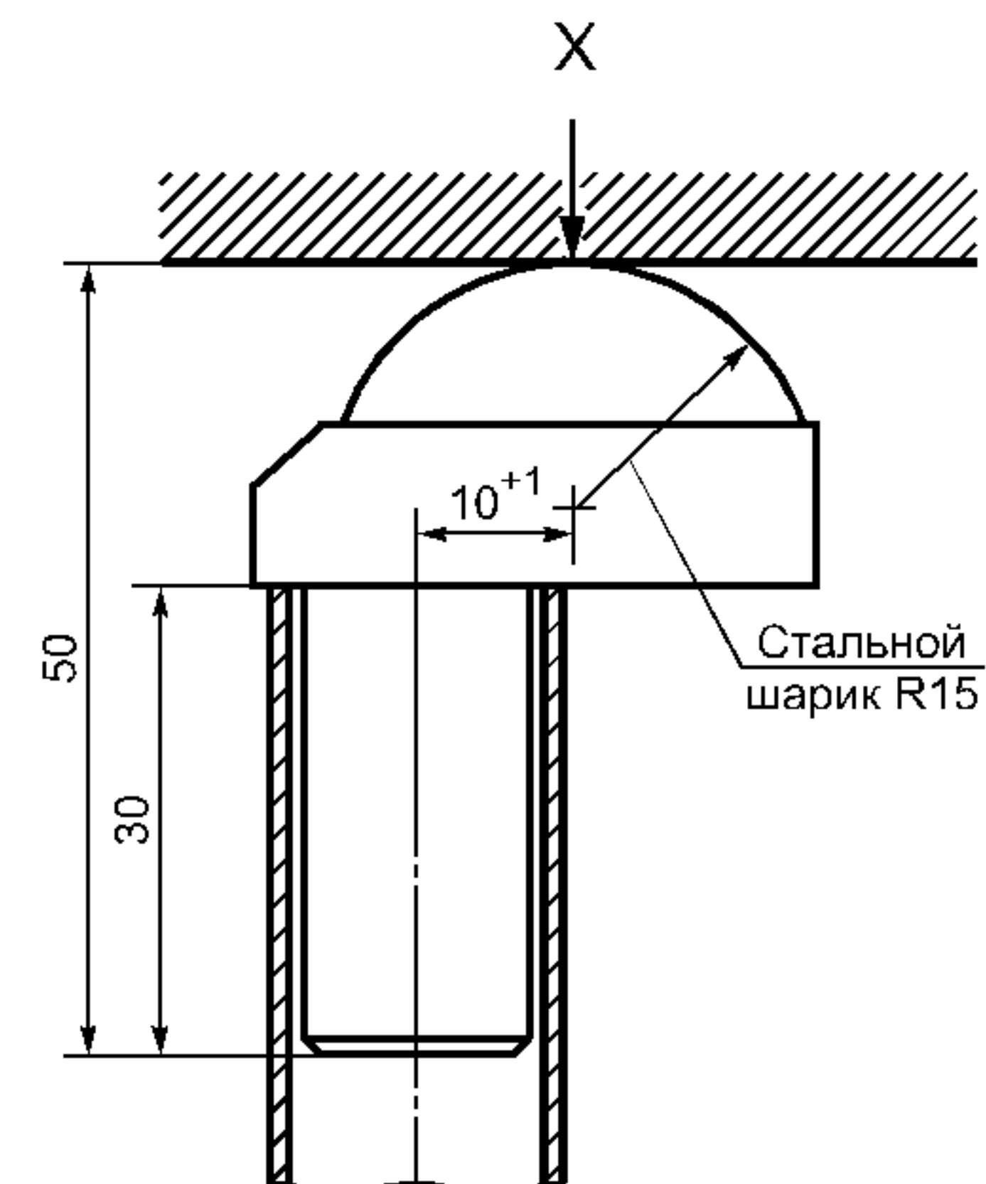
Рисунок 6 — Схема определения минимального сжимающего усилия
