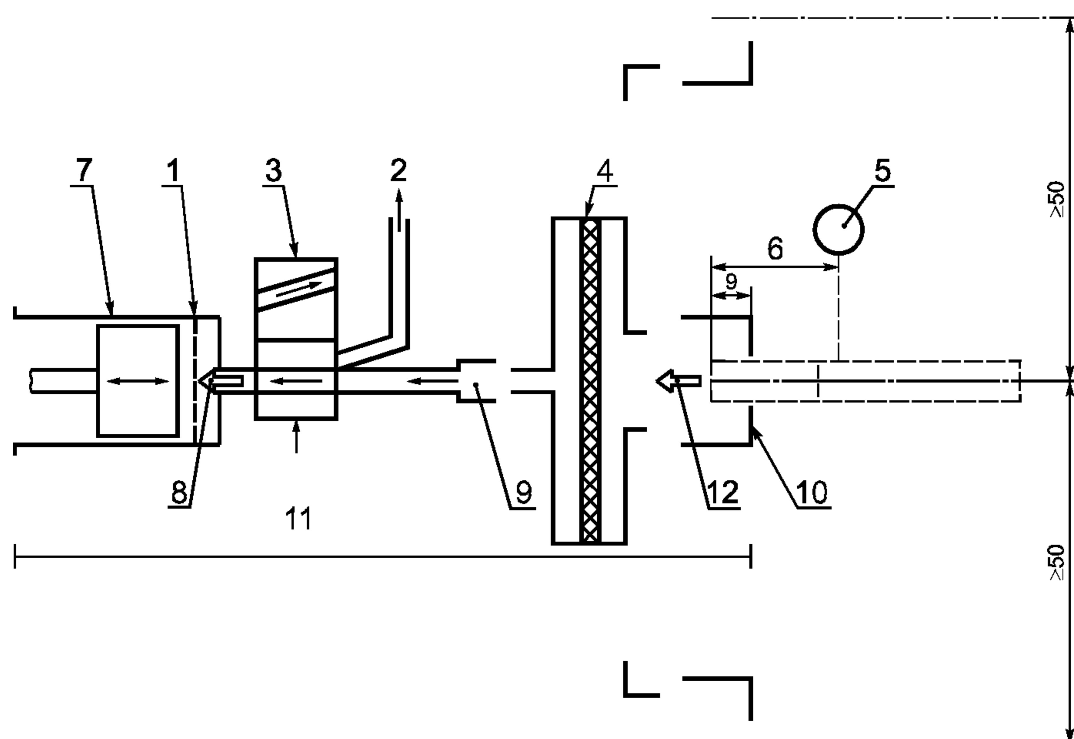
1 — положение головки поршня в начале хода; 2 — выход газовой фазы; 3 — электроклапан; 4 — ловушка для дыма;
