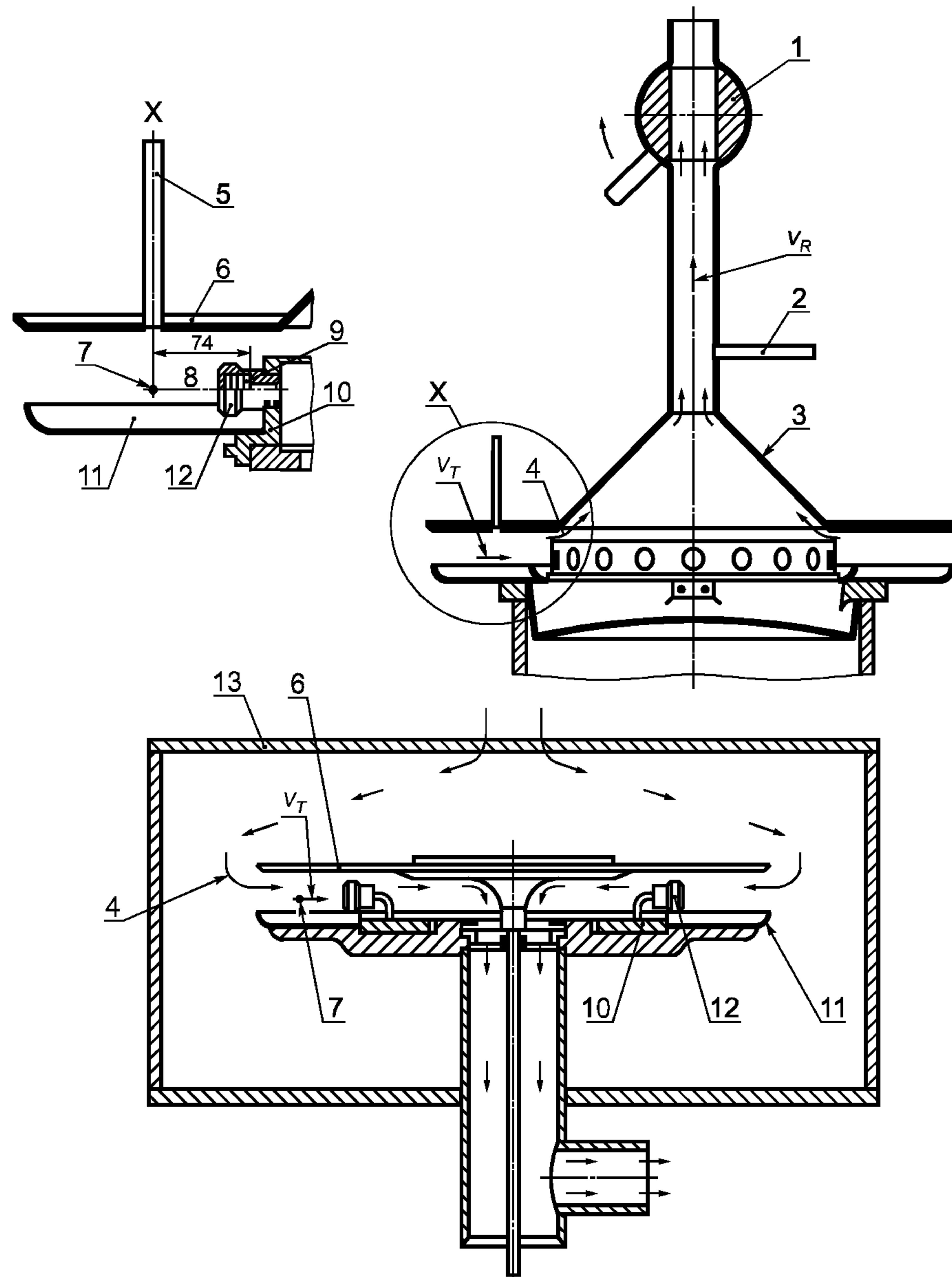
1 — шаровой кран; 2 — канал для введения зонда; 3 — вытяжной колпак; 4 — поток воздуха; 5 — канал для введения датчика;
