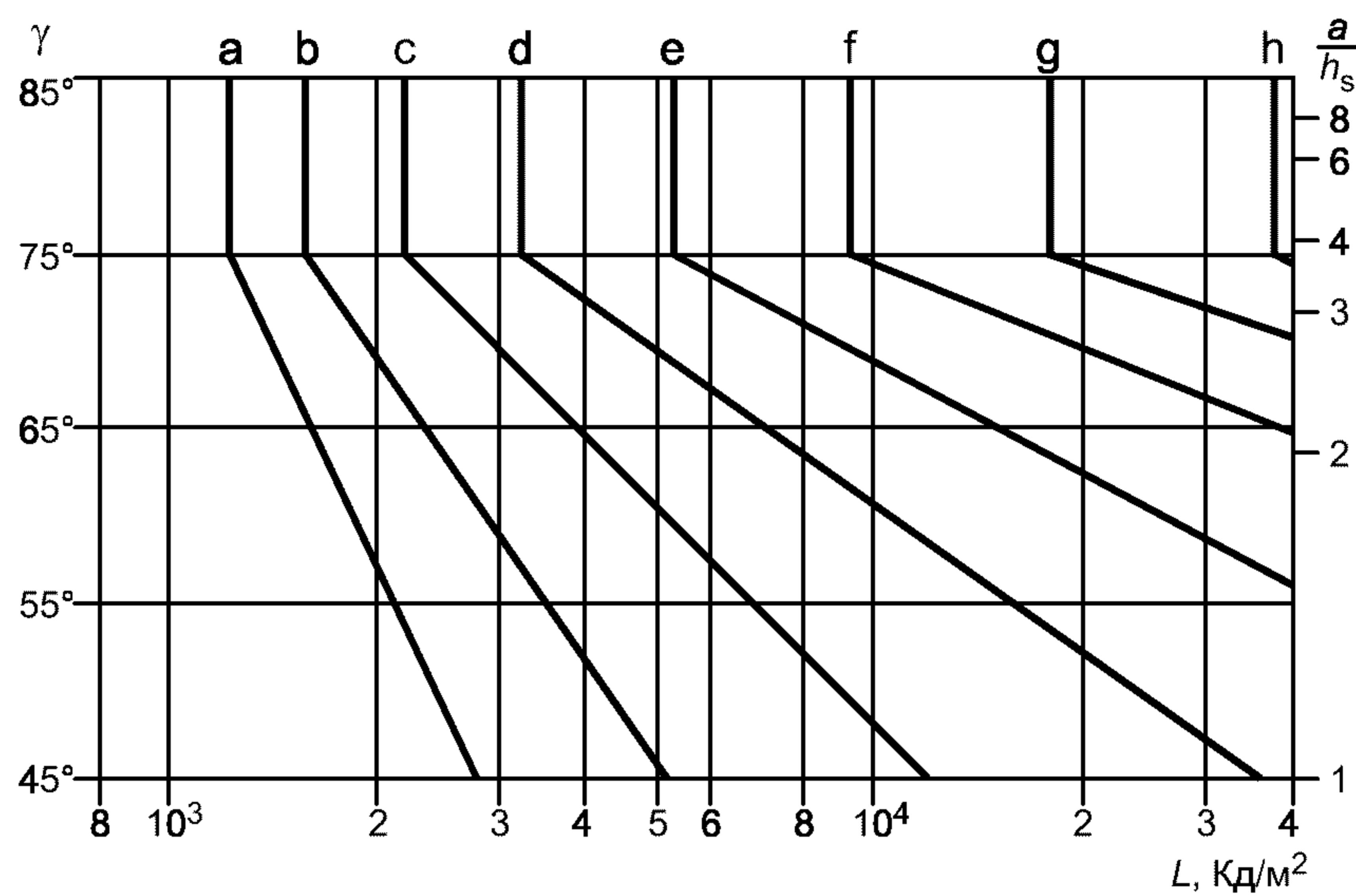
Рисунок А.2 — Предельные кривые яркости для всех светильников без светящихся боковых поверхностей и для светильников удлиненной формы со светящимися боковыми поверхностями, видными в продольном направлении
