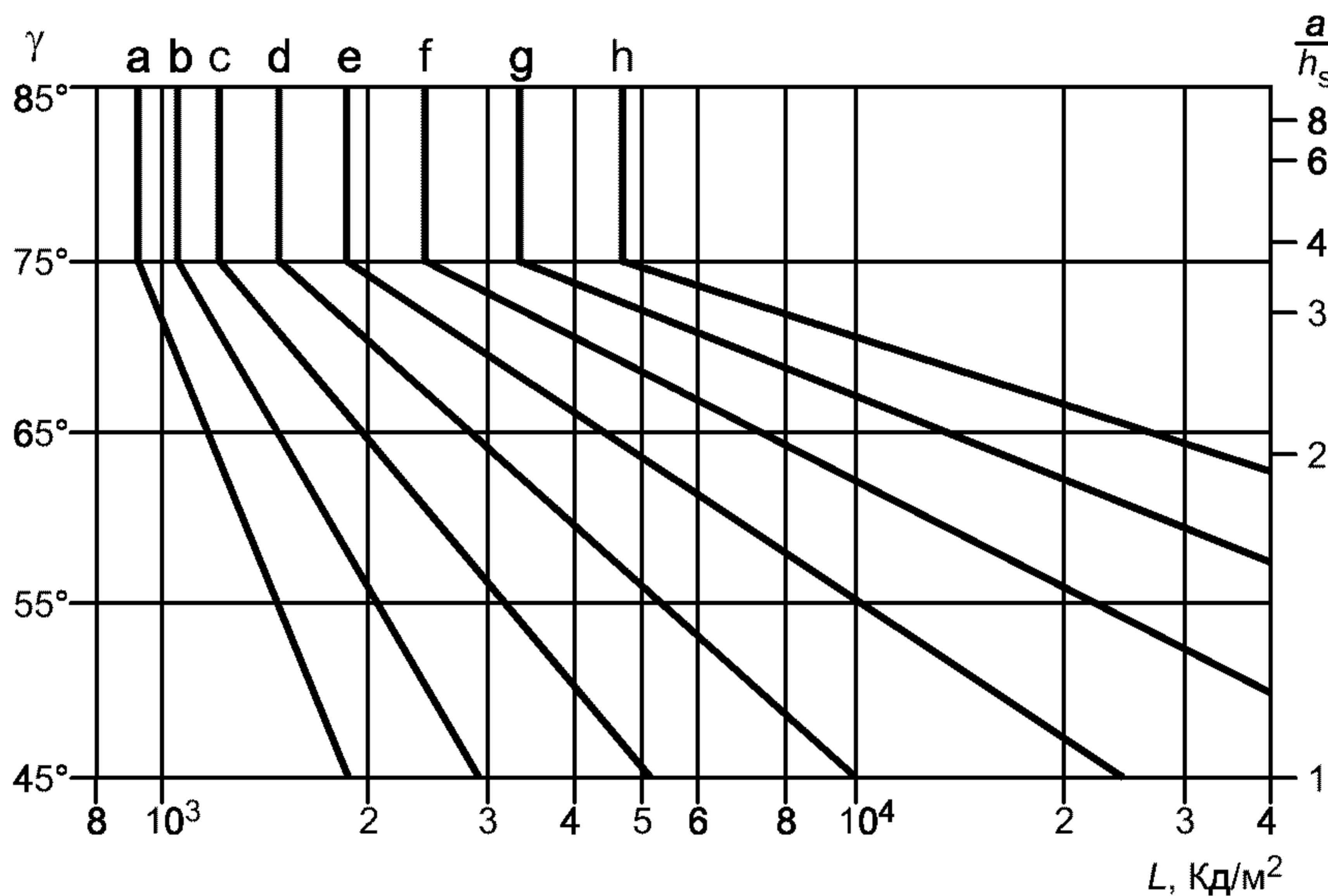
Рисунок А.3 — Предельные кривые яркости для всех светильников со светящимися боковыми поверхностями, за исключением светильников удлиненной формы со светящимися боковыми поверхностями, видными в продольном направлении.
