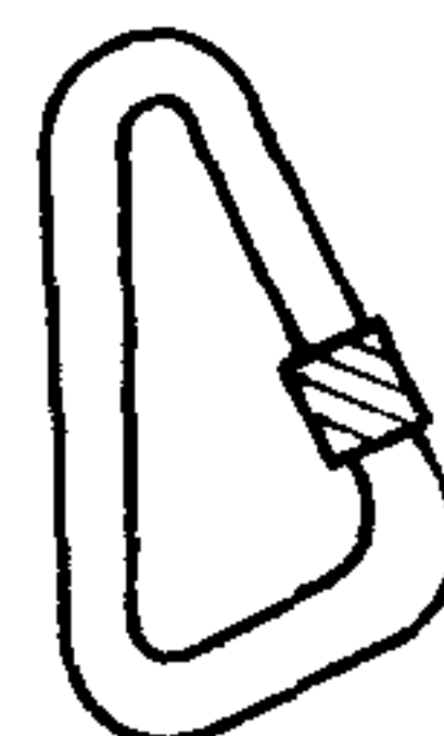
Рис. 1. Карабин с муфтой системы Абалакова
