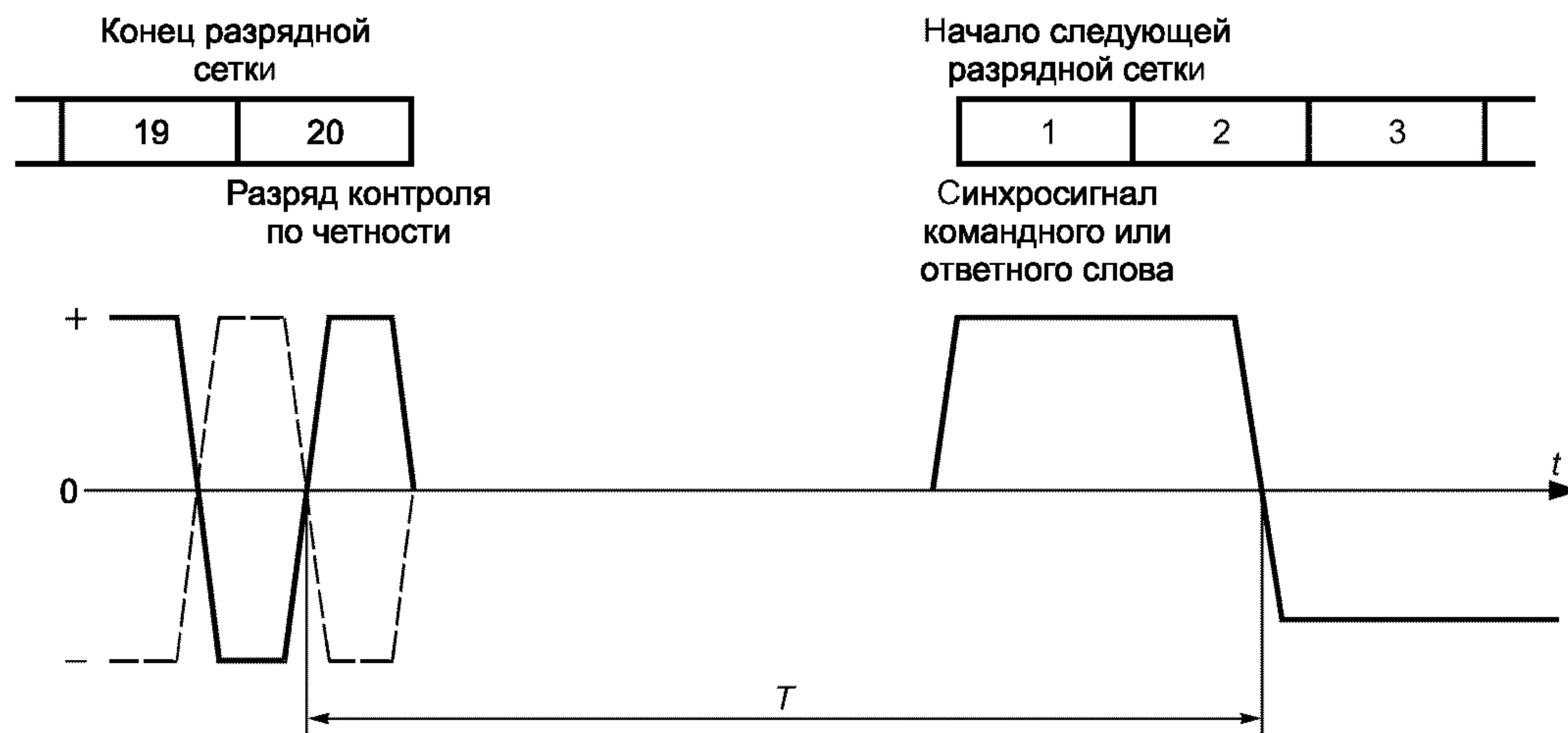
Рисунок 10 — Измерение временных пауз T в сообщениях
