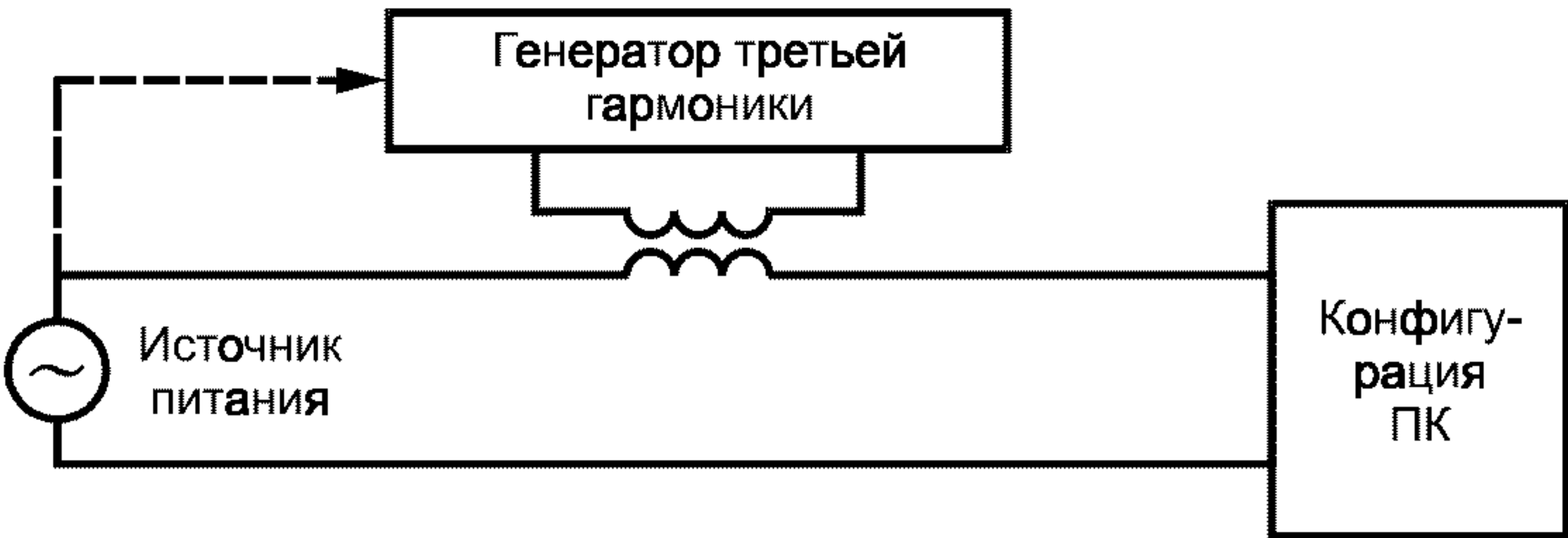
Рисунок 10 — Испытание на устойчивость к напряжению третьей гармоники
