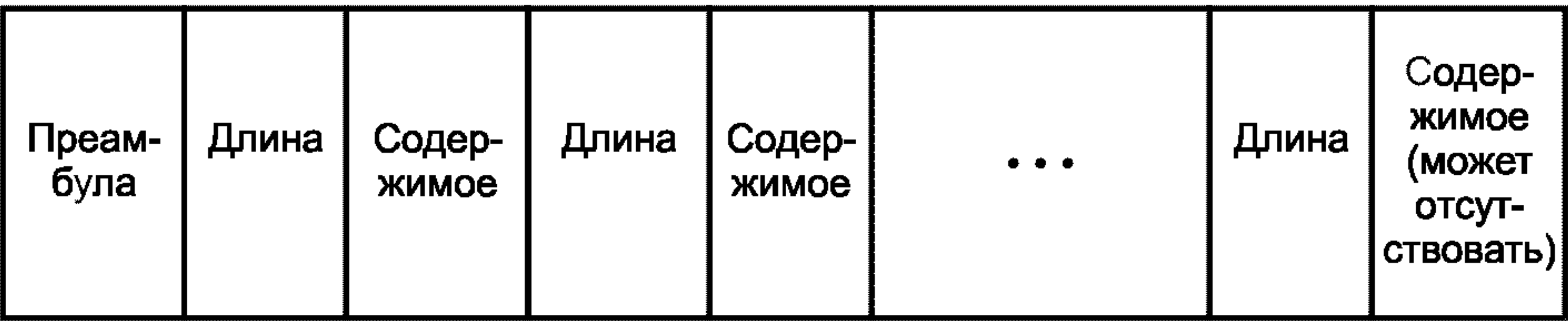
Рисунок 2 — Кодирование значения длинных данных
