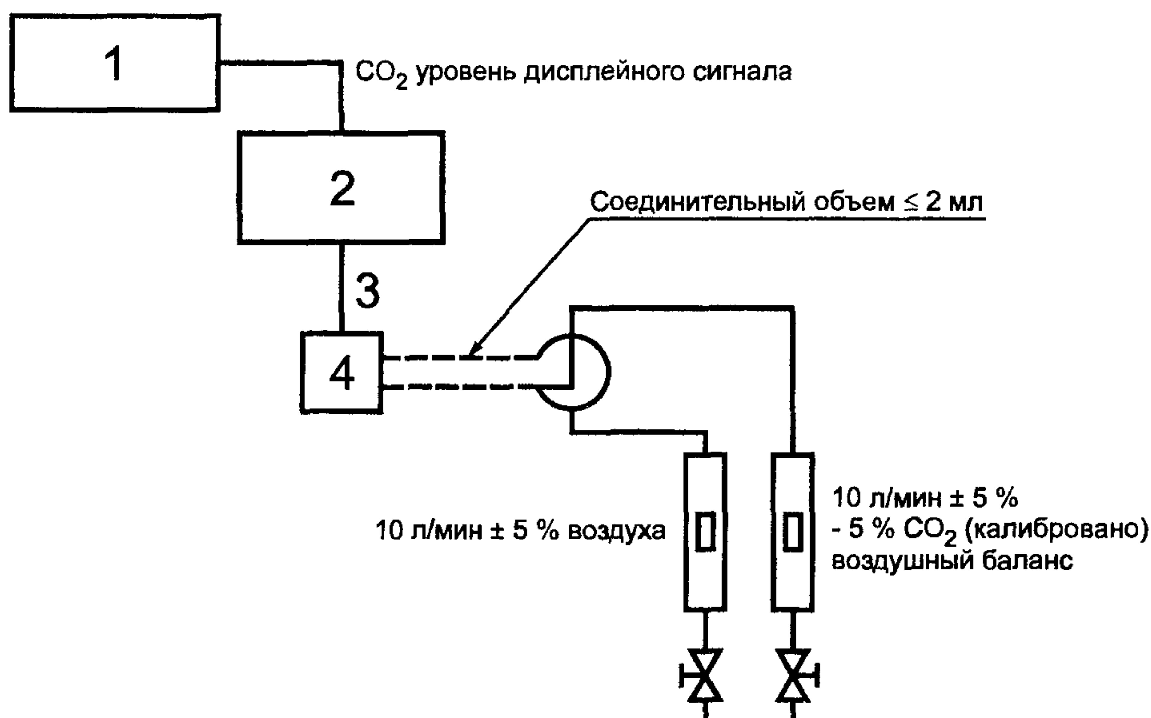
1 — самописец или осциллограф; 2 — капнограф; 3 — трубка образца; 4 — датчик или адаптер для трубки образца
