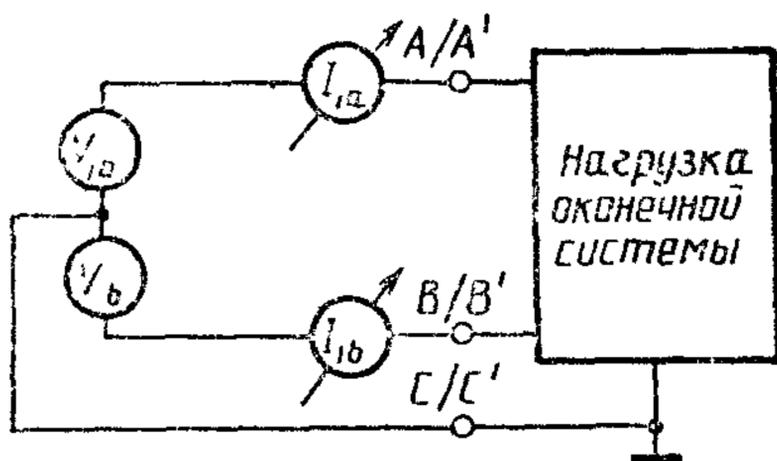
Рисунок 5 Измерение входного тока/напряжения
