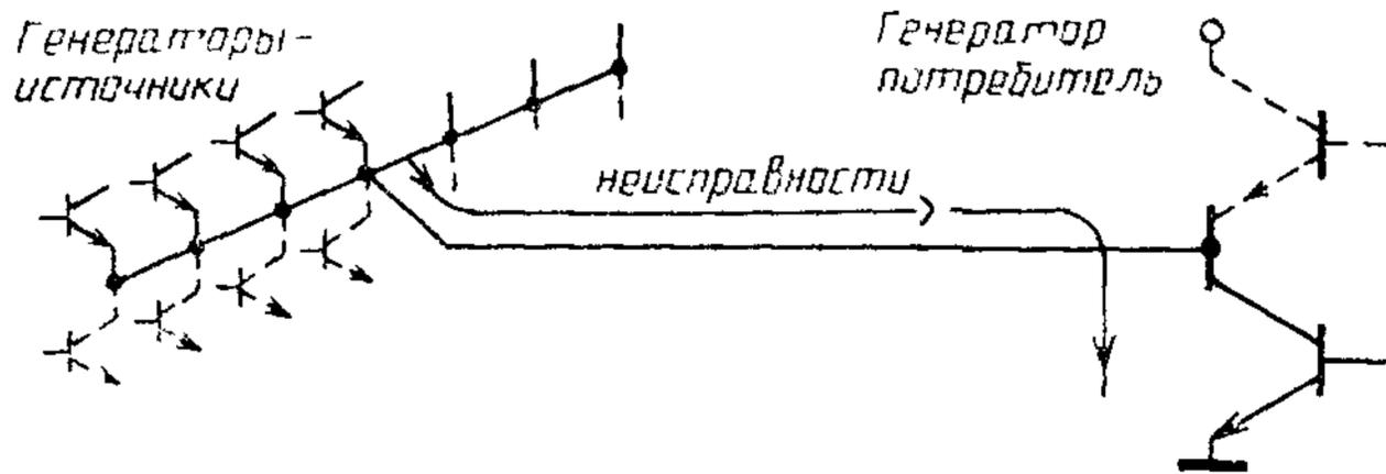
Рисунок 17 Соперничество генераторов с несколькими генераторами-источниками
