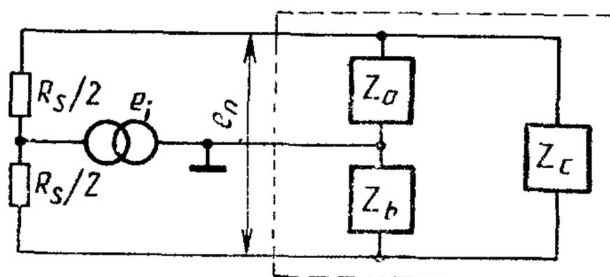
где  $R_s$  — характеристический импеданс кабеля на высокой частоте или шлейфовое сопротивление кабеля на низкой частоте;  $Z_a$ ,  $Z_b$  и  $Z_c$  — соответствующие импедансы комбинации приемников мостовой схемы;  $e_j$  — величина сигнала помехи относительно земли на одном конце кабеля, другой конец которого заземлен;  $e_n$  — составляющая помехи между двумя проводниками, образуемая в результате несбалансированности импедансов.
