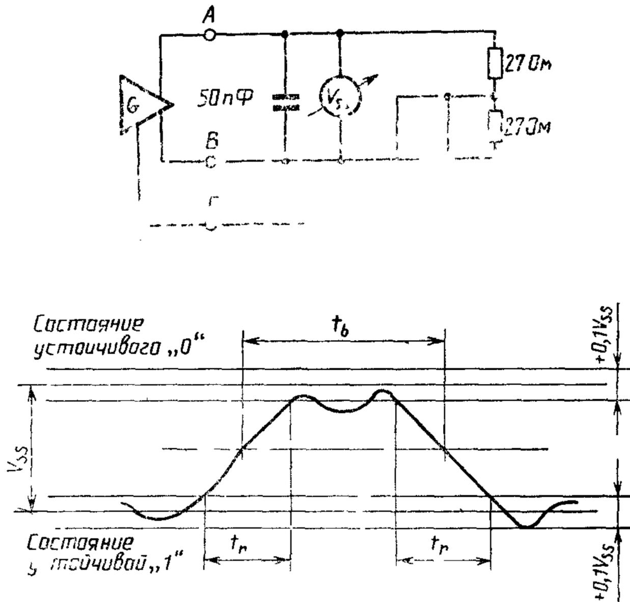
$t_r$ —время нарастания,  $t_b$ —длительность единичного интервала на используемой скорости передачи данных,
