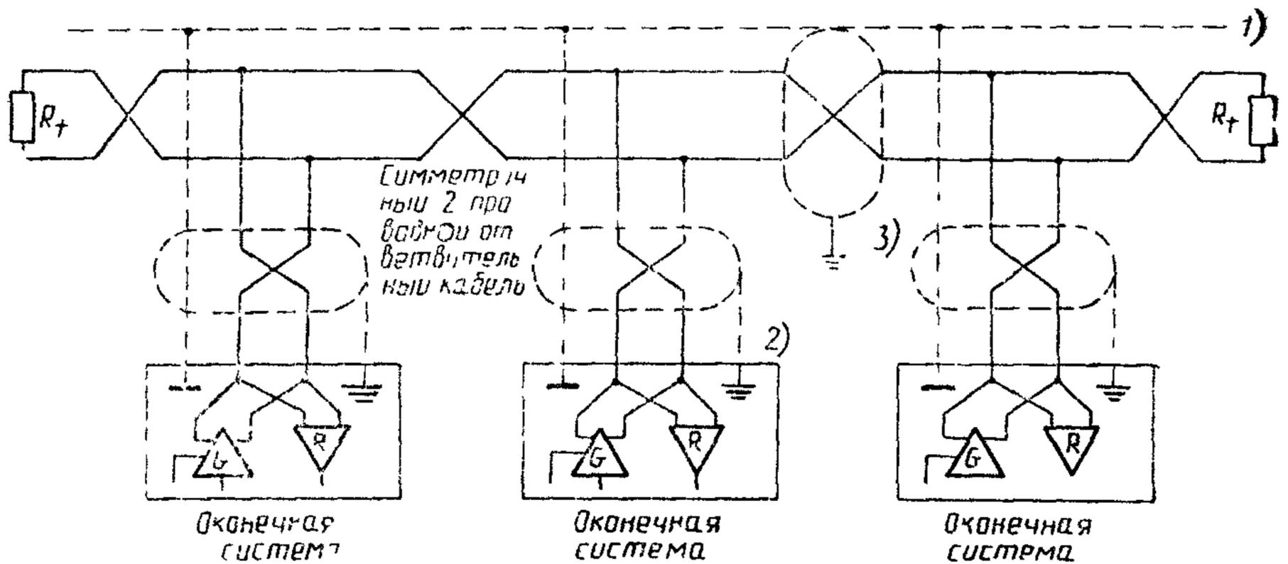
Рисунок 2 Двухпроводная многопунктовая конфигурация
