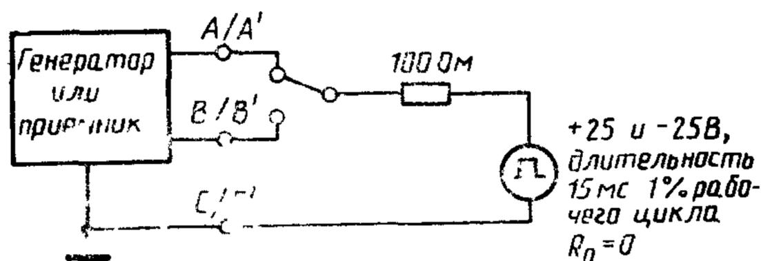
Рис. 15 Проверка переходного напряжения
