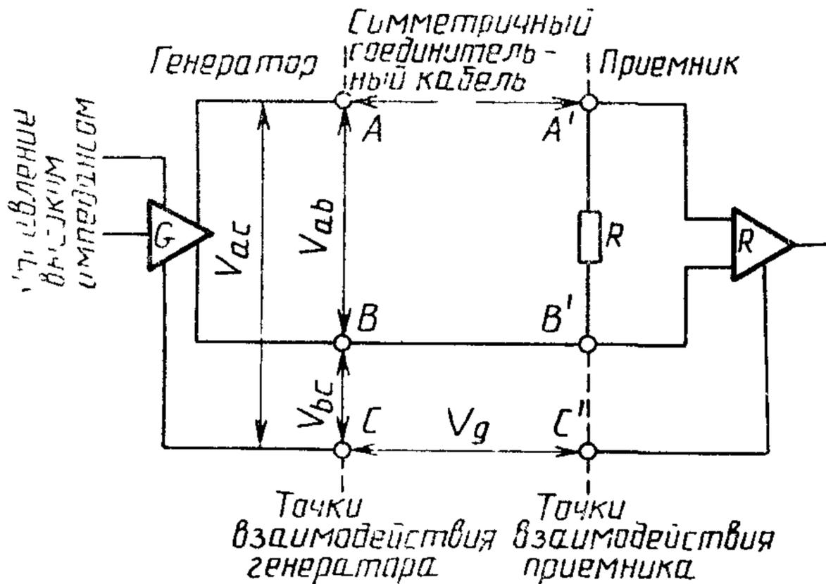
$V_{ab}$  — выходное напряжение генератора между точками  $A$  и  $B$ ;  $V_{ac}$  — напряжение генератора между точками  $A$  и  $C$ ;  $V_{bc}$  — напряжение генератора между точками  $B$  и  $C$ ;  $V_g$  — разность потенциалов земли,  $R_t$  — согласующий резистор кабеля,  $A, B$  и  $A', B'$  — точки взаимодействия;  $C, C'$  — точки взаимодействия эталонного нуля (сигнальная земля)
