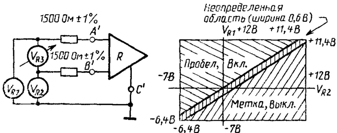
Рисунок 12 Измерение рассогласования на входе
