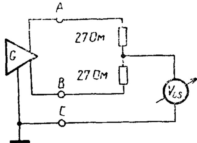
Рисунок 8 Измерение смещения напряжения
