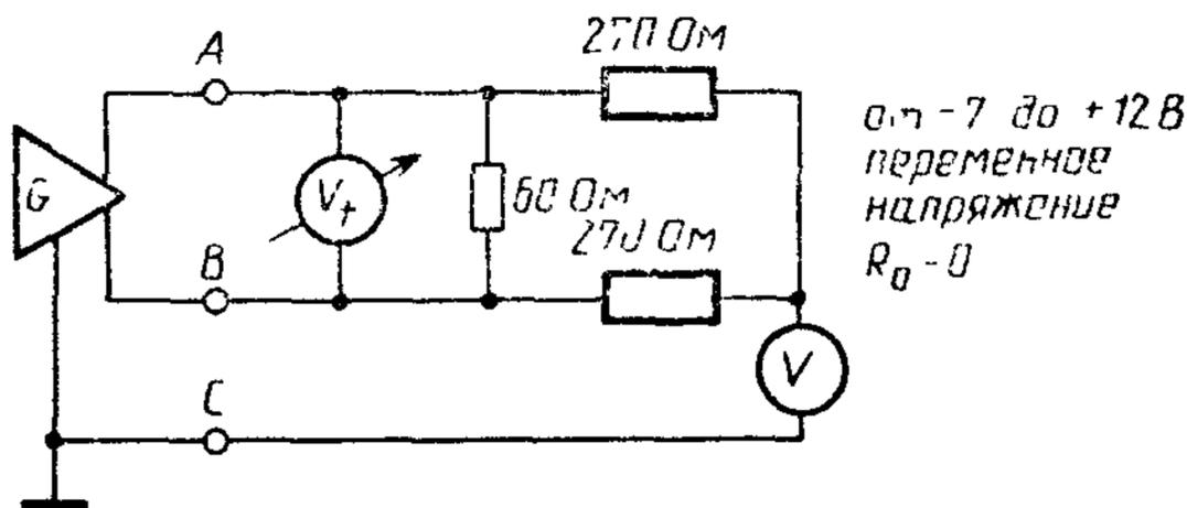
Рисунок 9 Измерение напряжения нагруженного выхода
