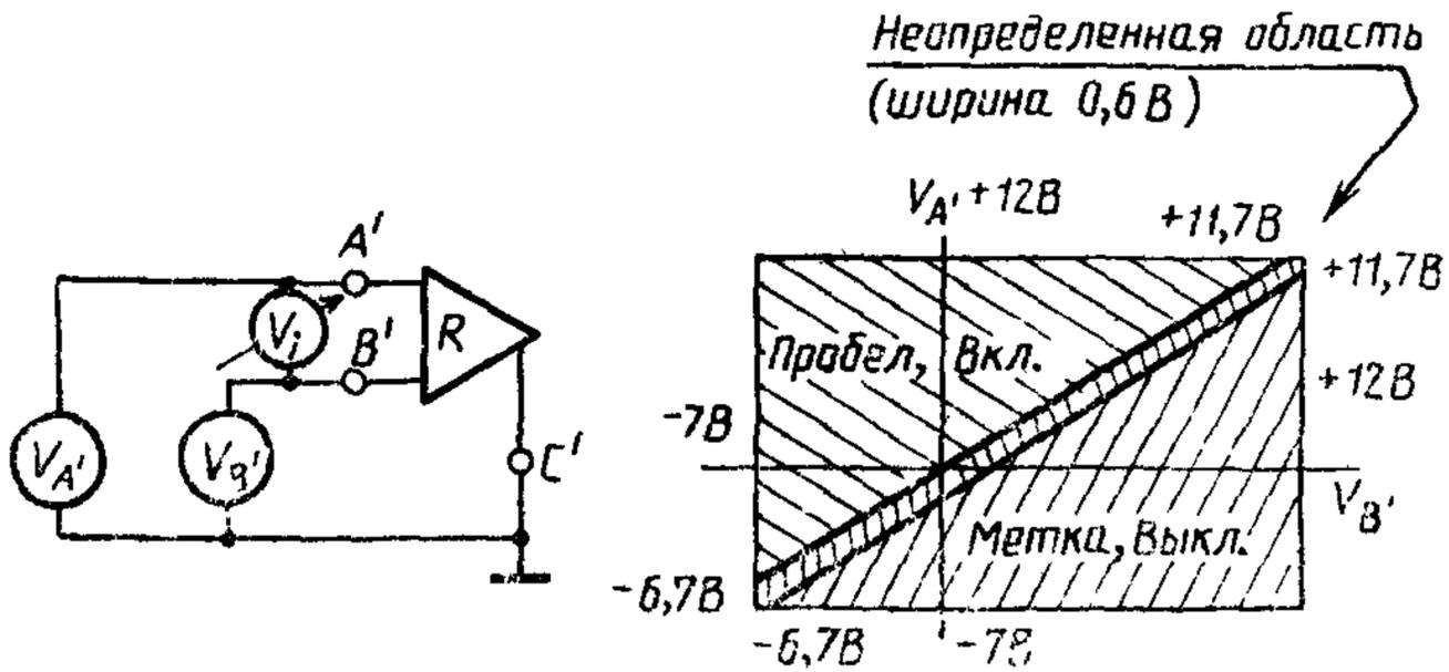
Рисунок 11 Диапазон входных напряжений
