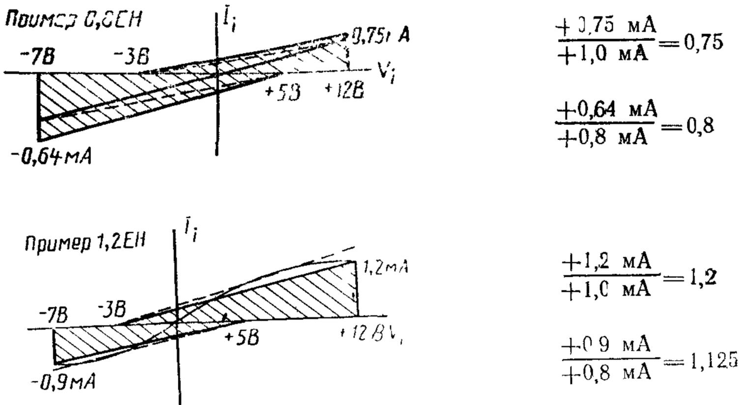
Рисунок 6 Определение значения ЕН
