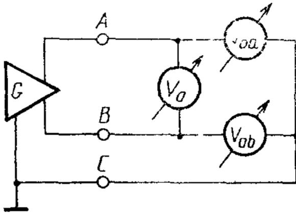
Рисунок 7 Измерение напряжения разомкнутой цепи
