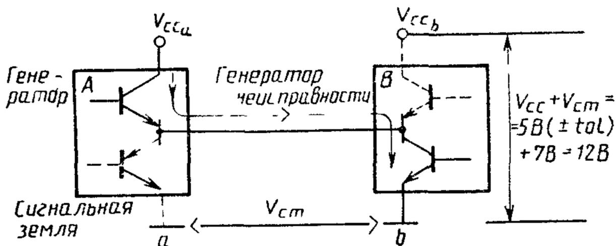
Рисунок 16 Соперничество генераторов с одним генератором-источником
