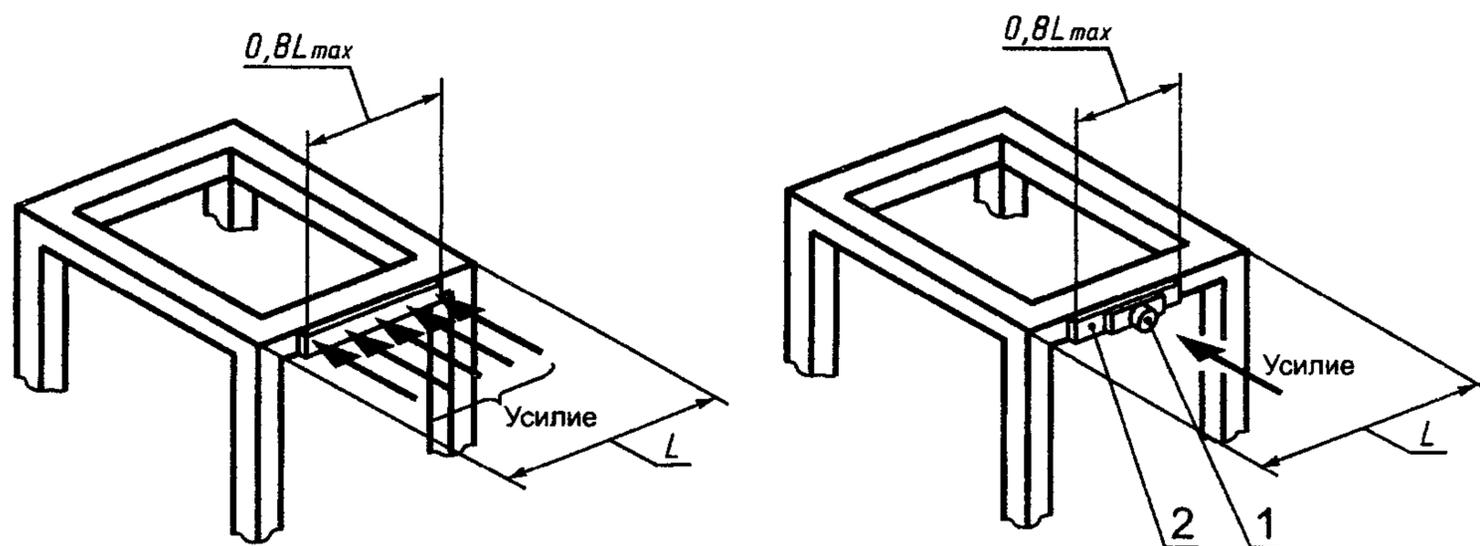
1 — точка приложения нагрузки; 2 — распределитель нагрузки
