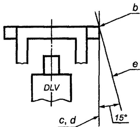
*a* — верхний элемент защитного каркаса, к которому прикладывают боковую нагрузку; *b* — наиболее удаленная точка элемента от продольной оси каркаса *a*; *c* — вертикальная линия, проходящая через точку *b*; *d* — вертикальная плоскость, параллельная продольной оси машины и проходящая через линию *c*; *e* — боковая имитируемая плоскость грунта
