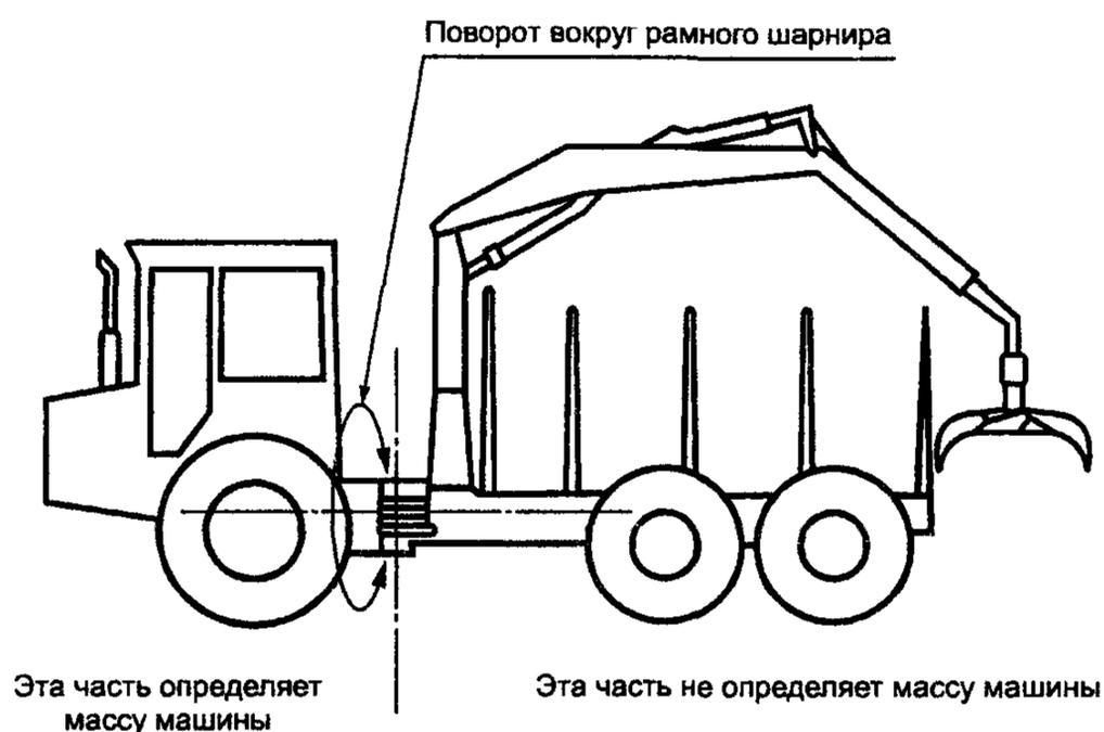
Рисунок 3 — Определение массы машины
