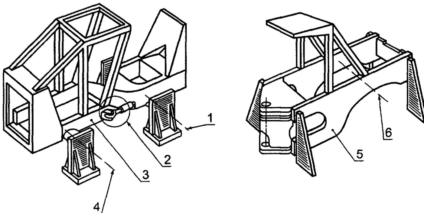
1, 4, 6 — осевые линии, 2 — блокируемый шарнир, 5, 3 — рама машины
