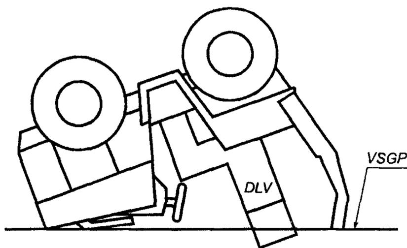
Рисунок 2 — Определение вертикальной имитируемой плоскости грунта
