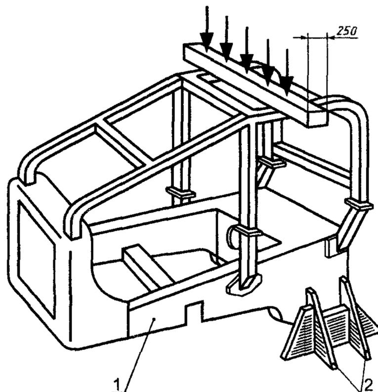
1 — корпус рамы; 2 — жесткое соединение с платформой стенда
