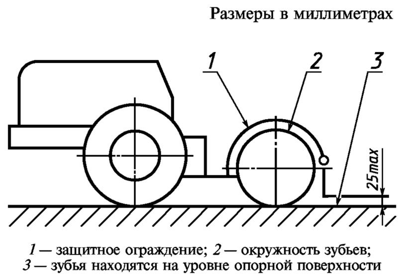
Рисунок 2 — Защита рабочего органа заднего культиватора
