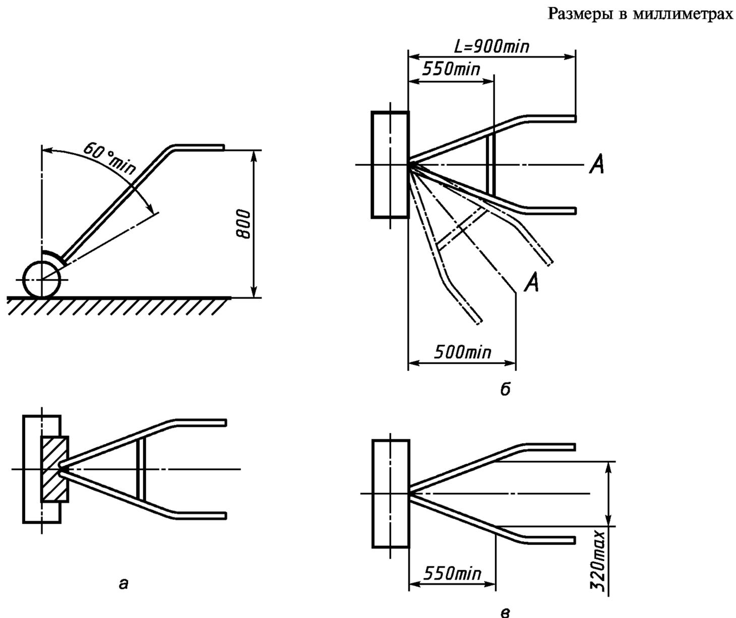
а — защитное ограждение (см. таблицу 1); б — рукоятки руля с поперечиной; в — рукоятки руля без поперечины
