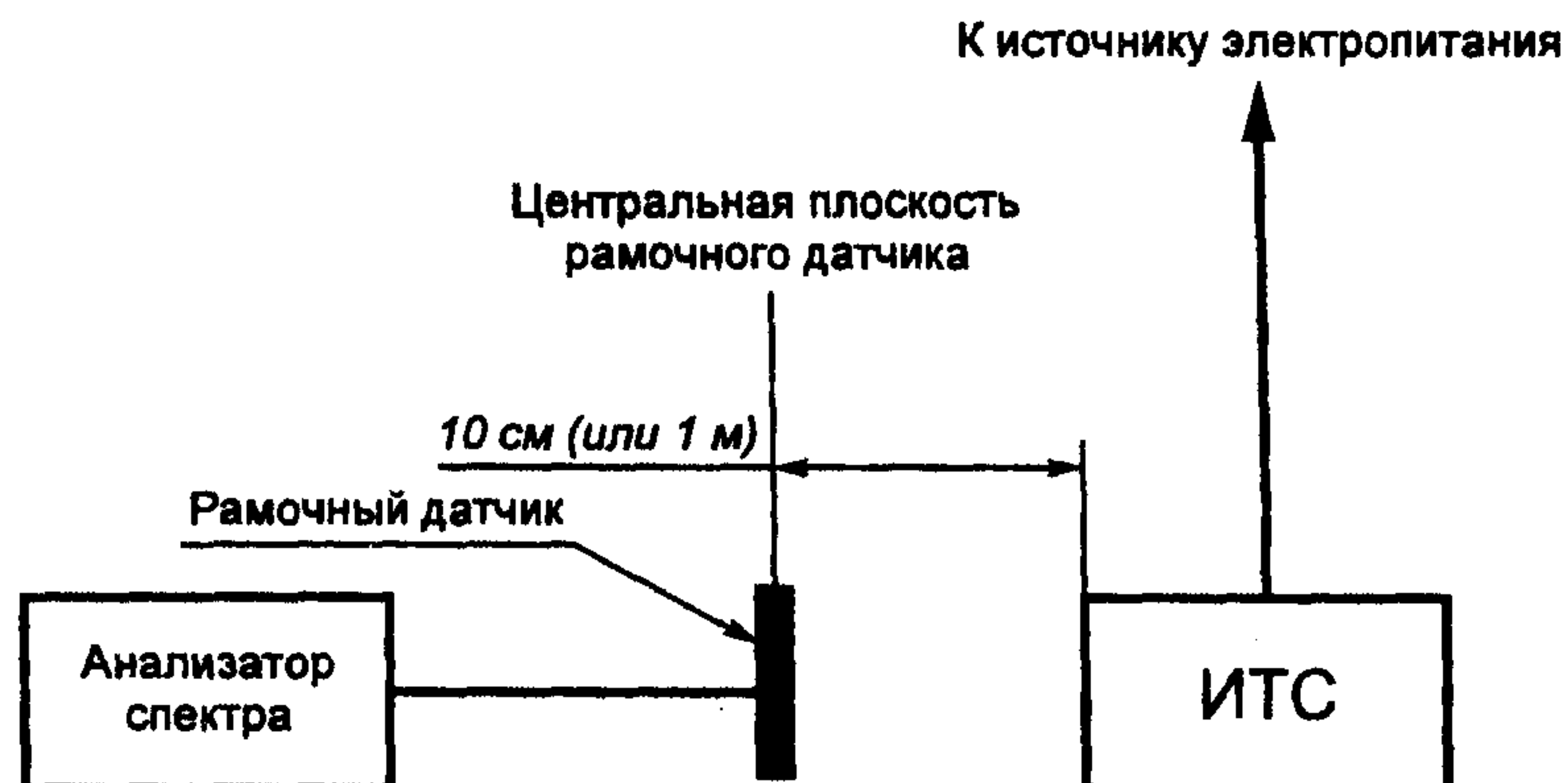
Рисунок А.2 — Испытательная установка для измерения магнитного поля, создаваемого ТС
