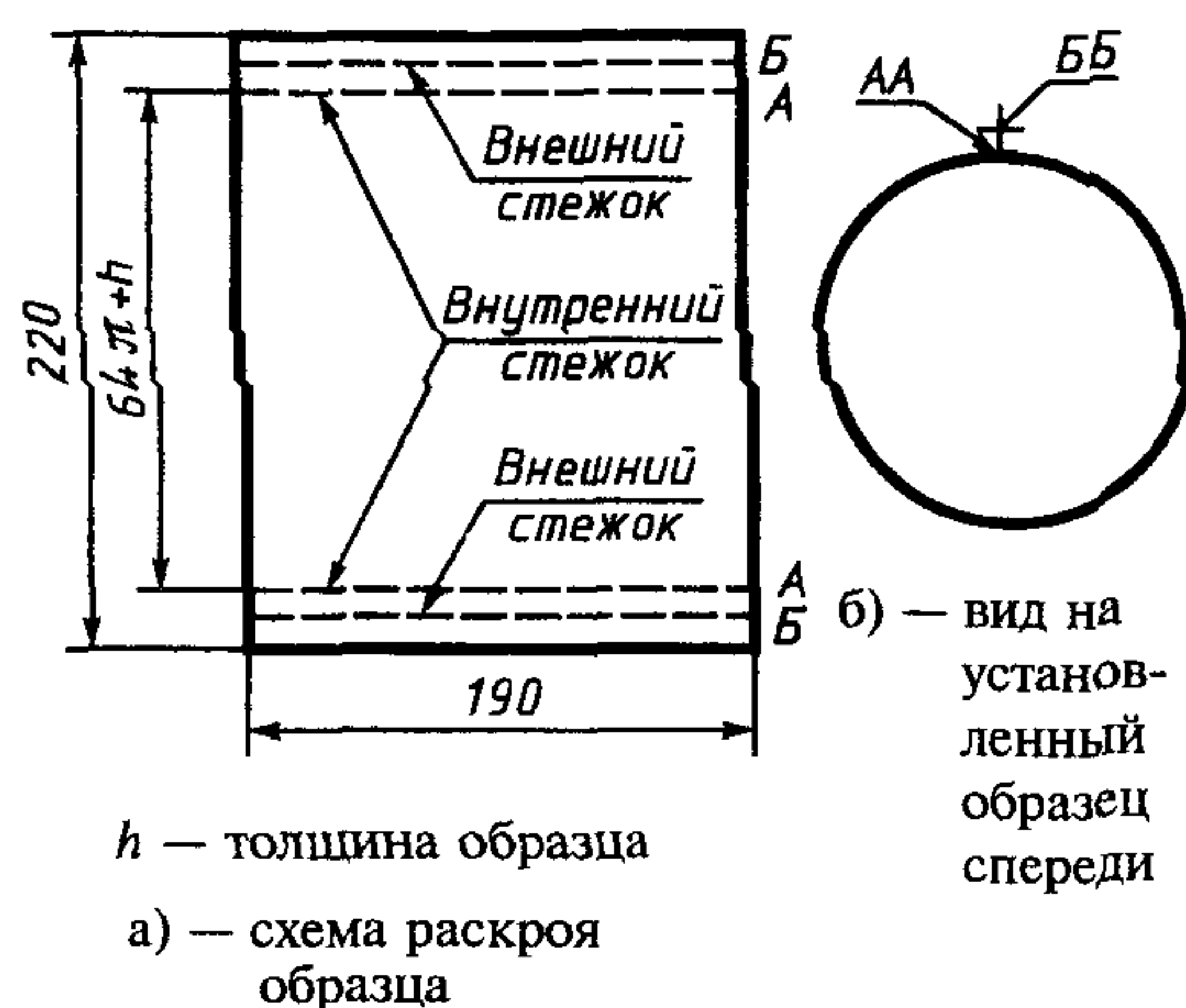
Рисунок 4 — Подготовка образца при испытании методом истирания в складке (метод В)
