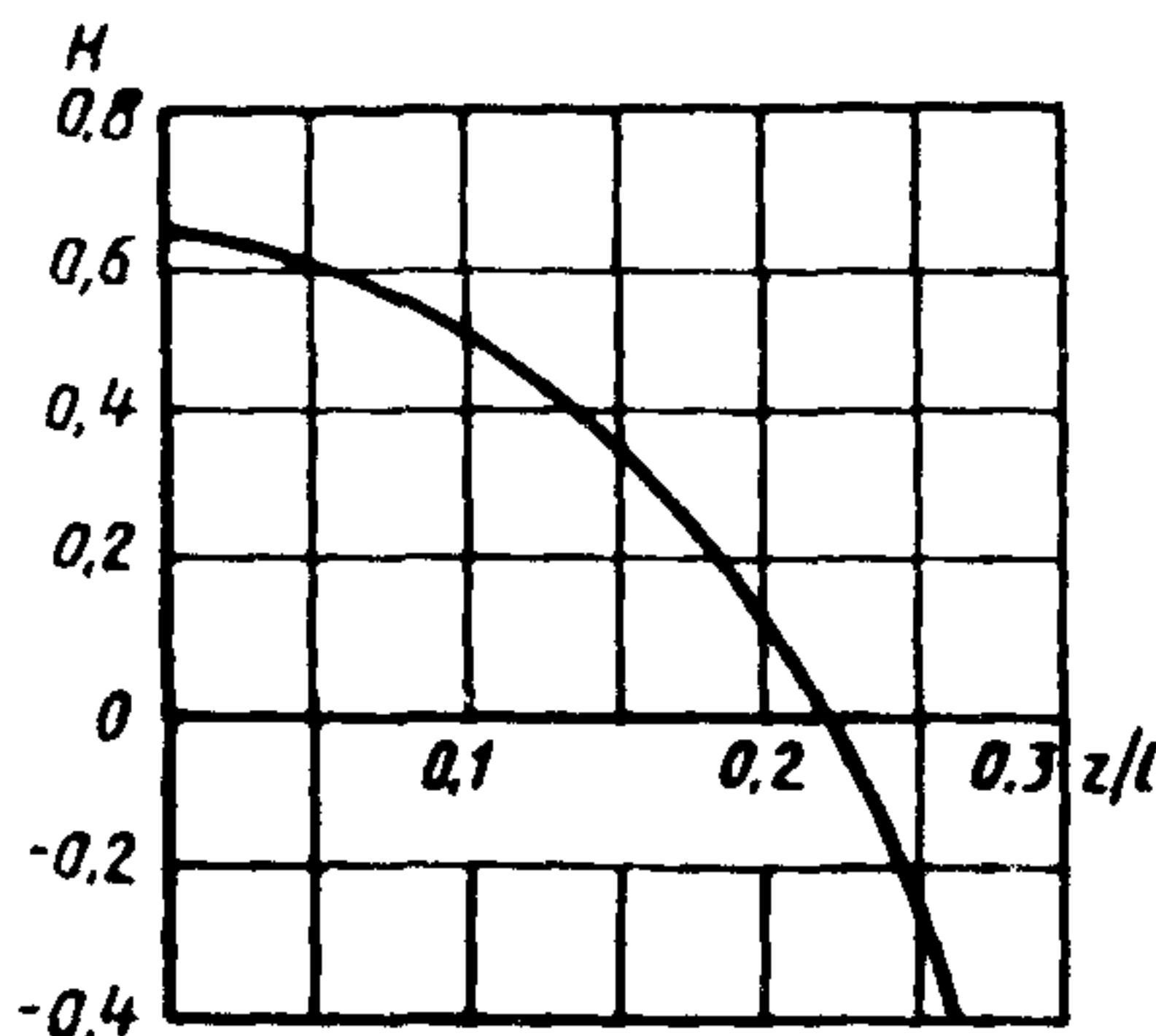
**Рисунок В 1 — График для определения доли дисбаланса, подлежащего устраниению в центральной плоскости коррекции**
