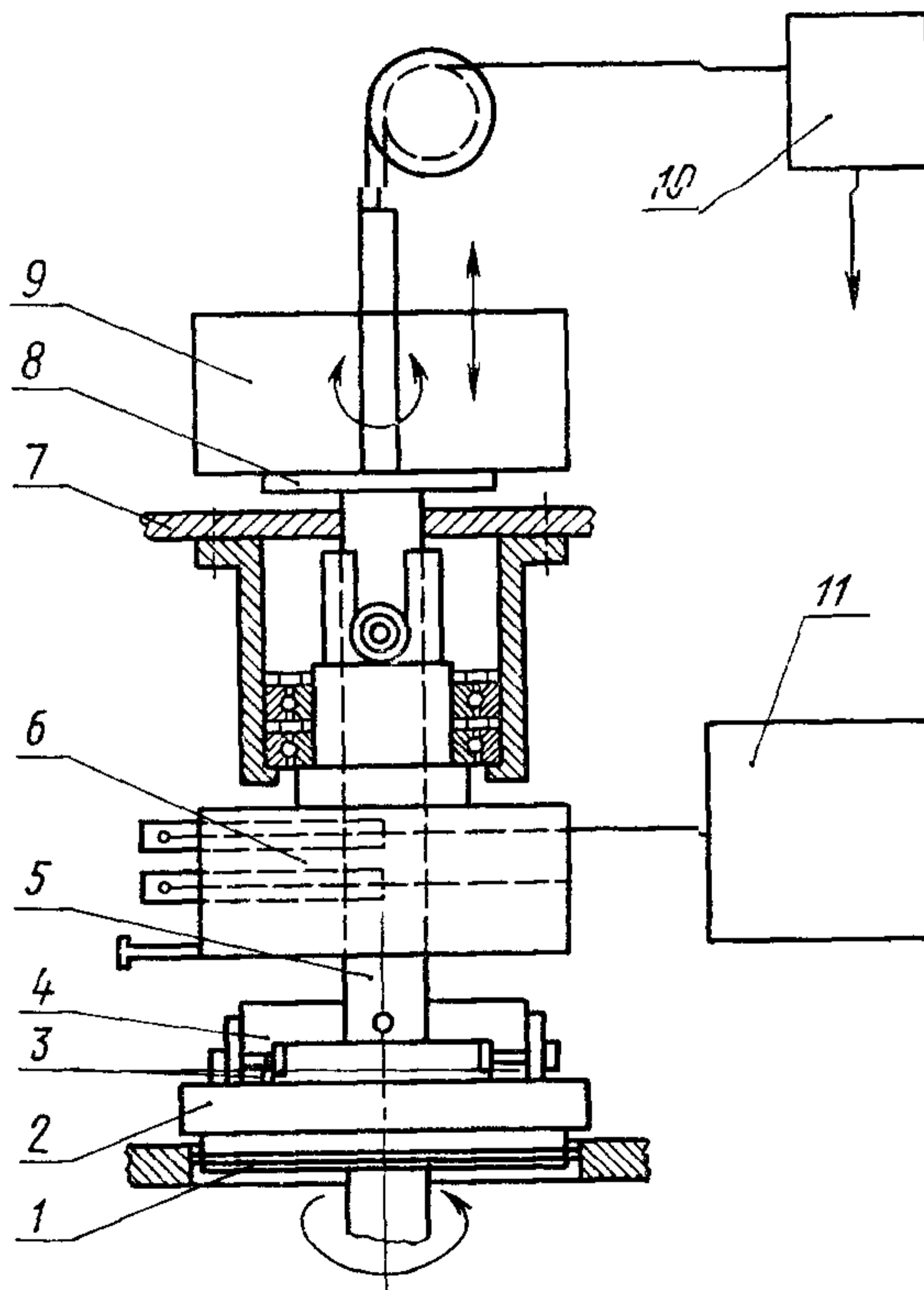
Узел истирания состоит из сменной платформы 2 для закрепления образца, истирателей 3 и динамометра 11 для измерения силы трения или слипания.
