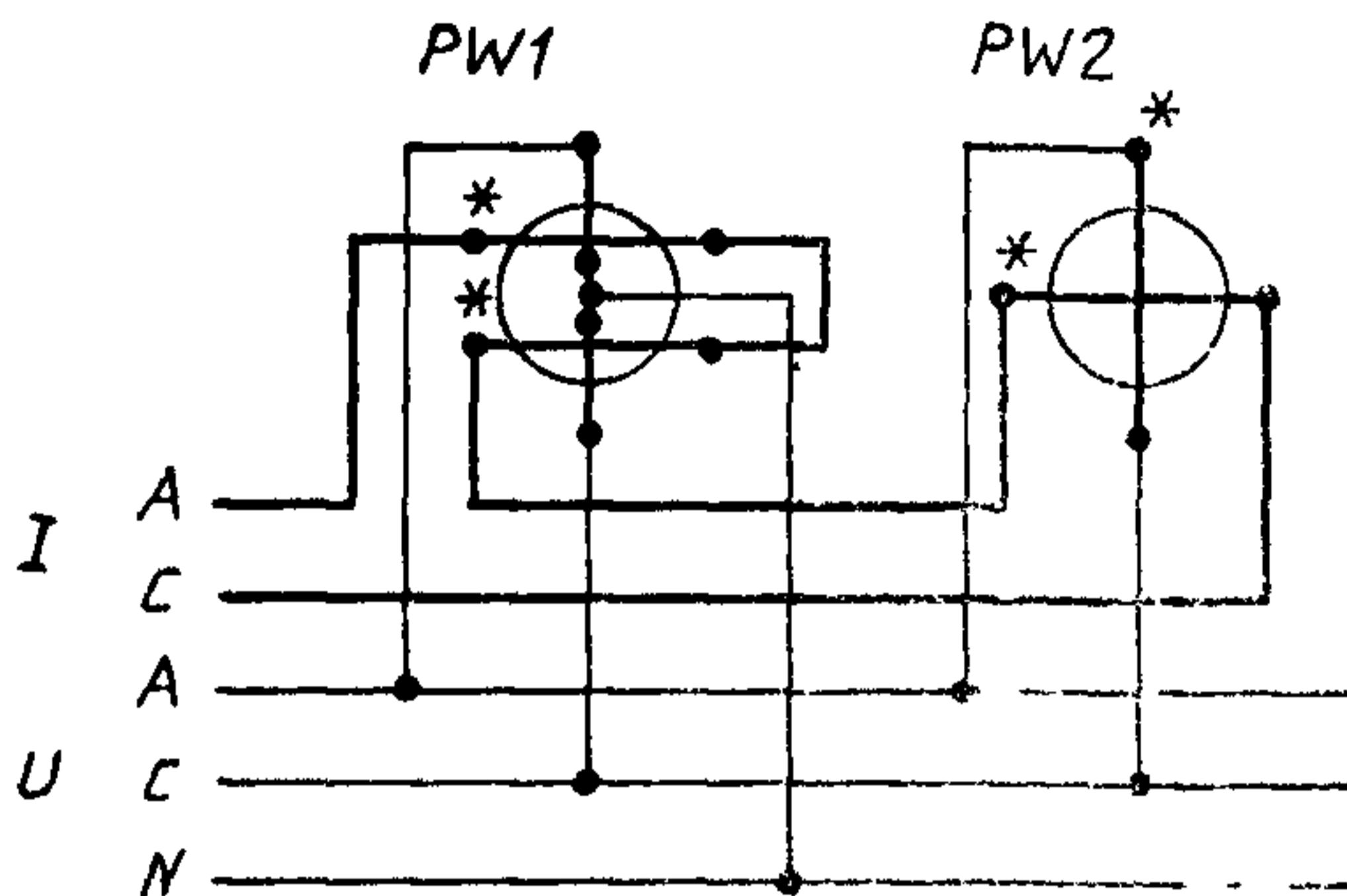
PW1 — поверяемый ваттметр, PW2 — образцовый ваттметр
