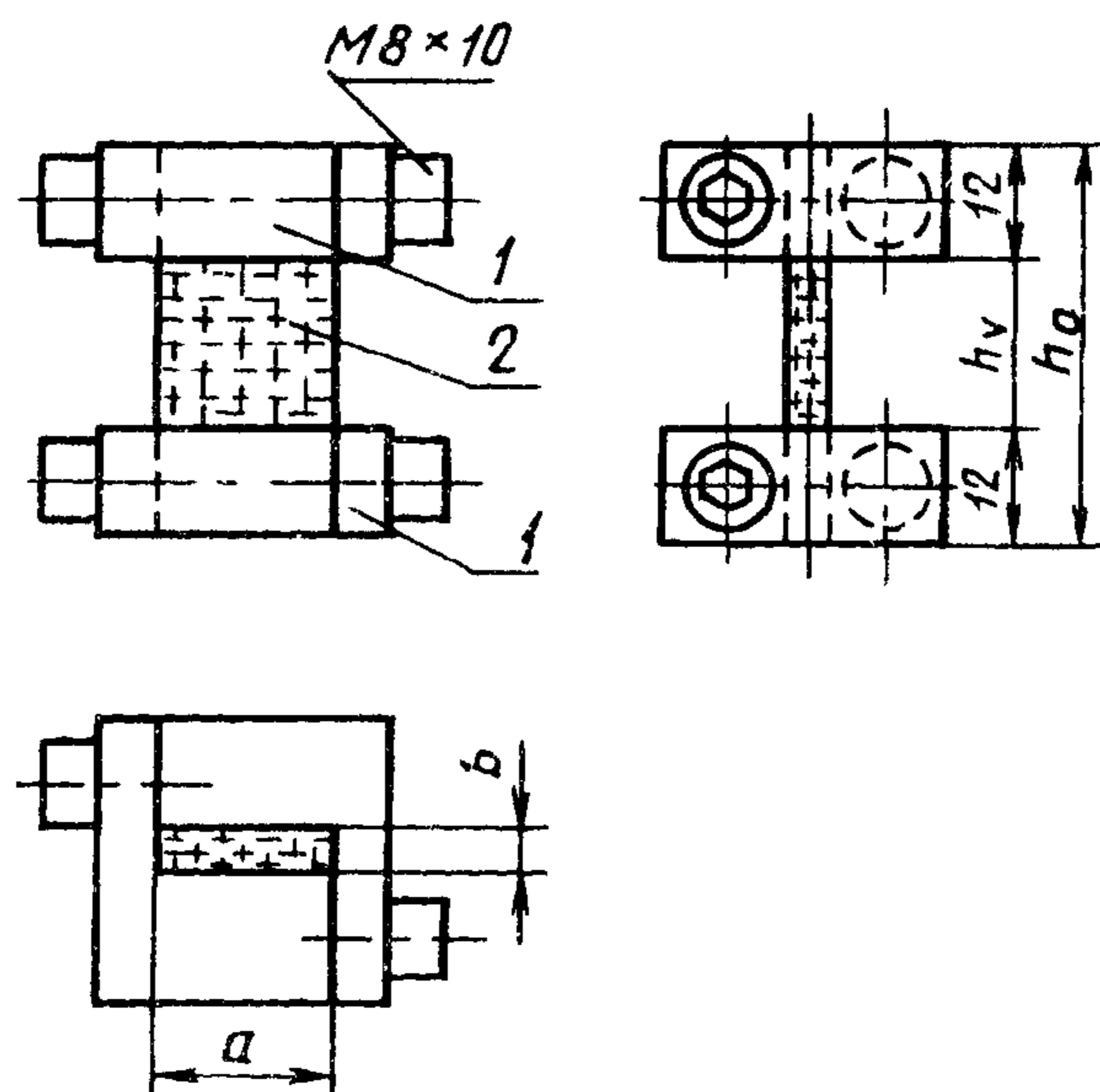
1 — приспособление для закрепления образца; 2 — образец
